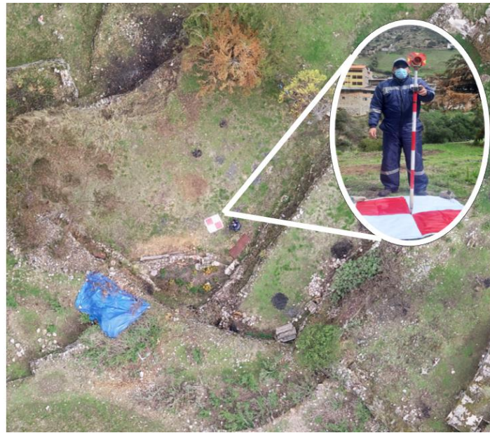
Figura 8: Instalación de nueve puntos de foto control
