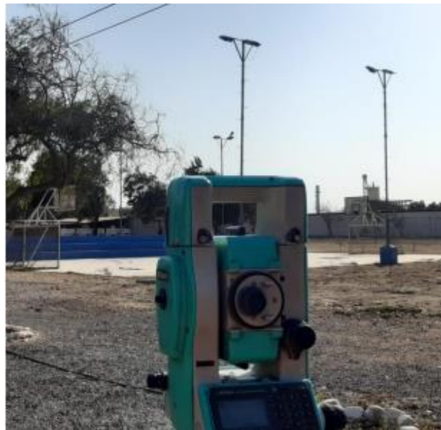
Figura 5: Estación Total Nikon DTM-632
