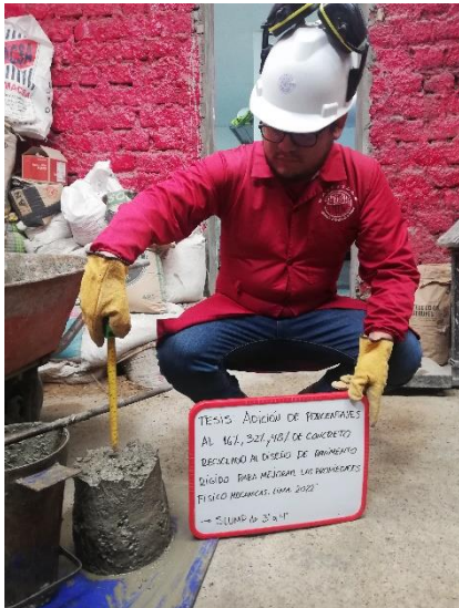
Asentamiento y toma de temperatura del concreto fresco.
