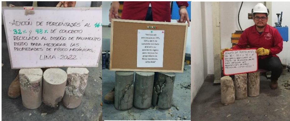
Rotura de probetas a 7 días, 14 días y 28 días
