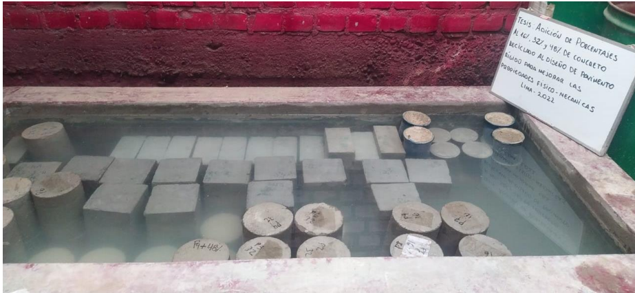
Curado de probetas y viguetas
