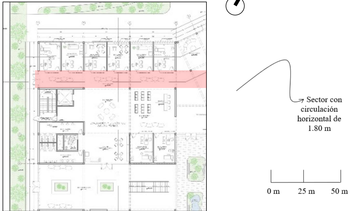
Figura 83: Circulación horizontal, primer nivel de evaluación y diagnóstico - consultorios.
