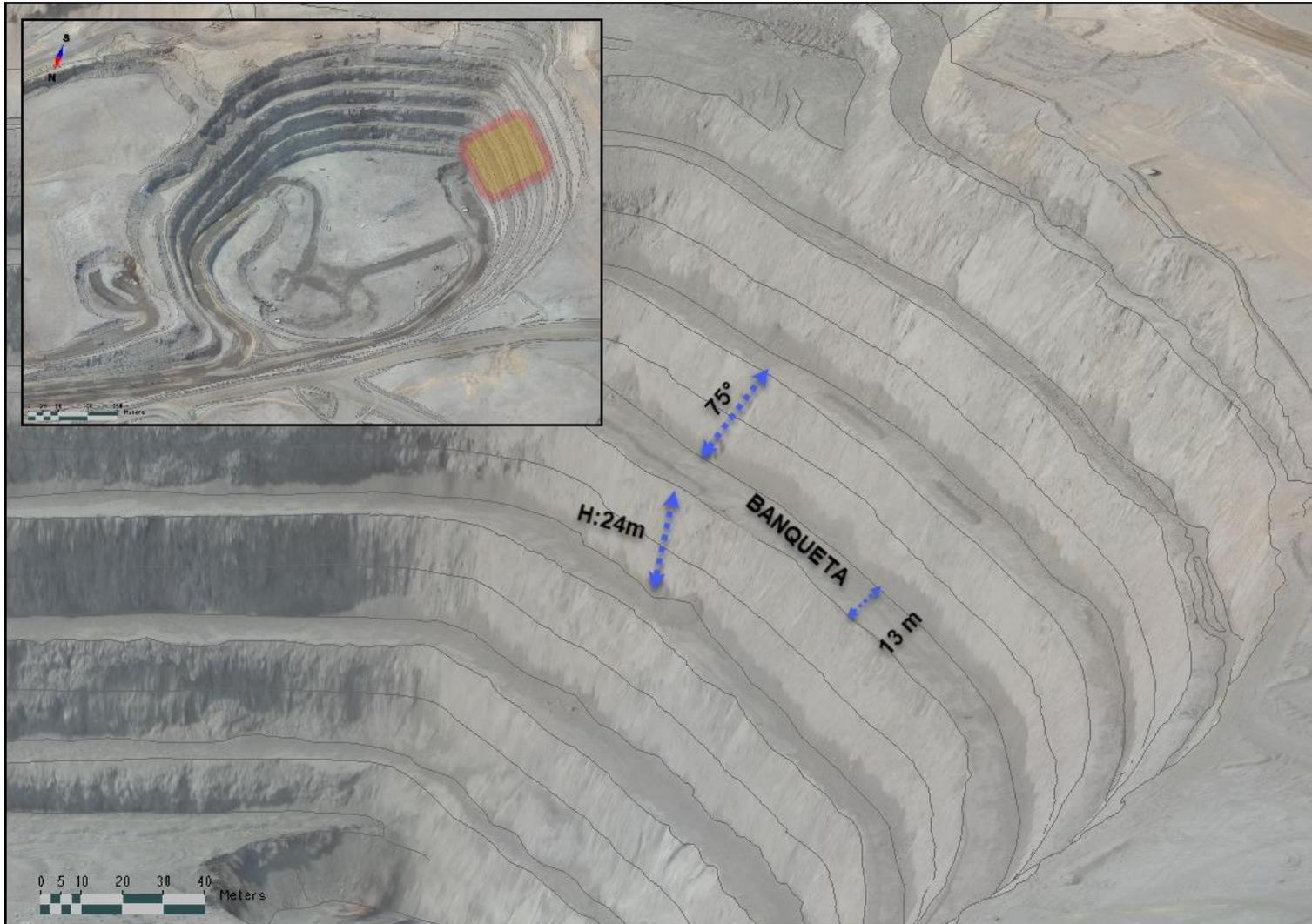
Figura 6. Control geotécnico de diseño de PIT (Diseño de tajo) mediante modelo digital de terreno obtenido desde el drone.
