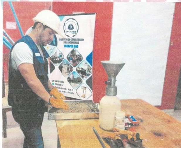
Fig.2. Preparando muestras para el ensayo Proctor.
