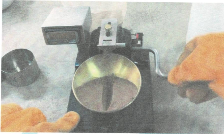
Fig. 5. Determinación de limite liquido de la muestra por el método de Casagrande.
