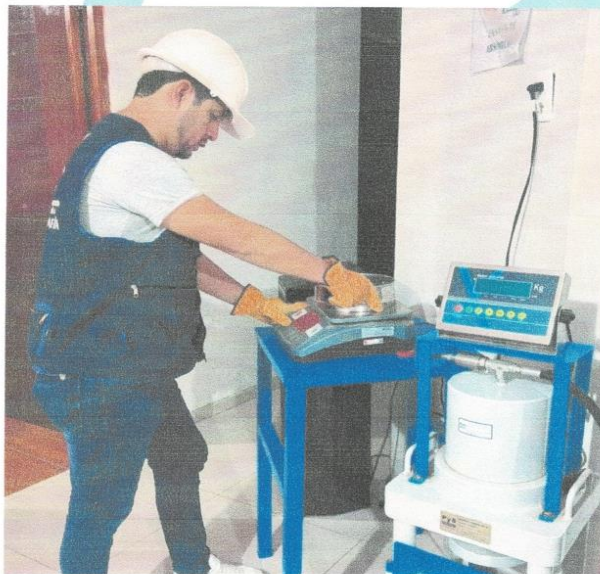
Fig.4. Pesaje de muestras para calcular el índice plasticidad.
