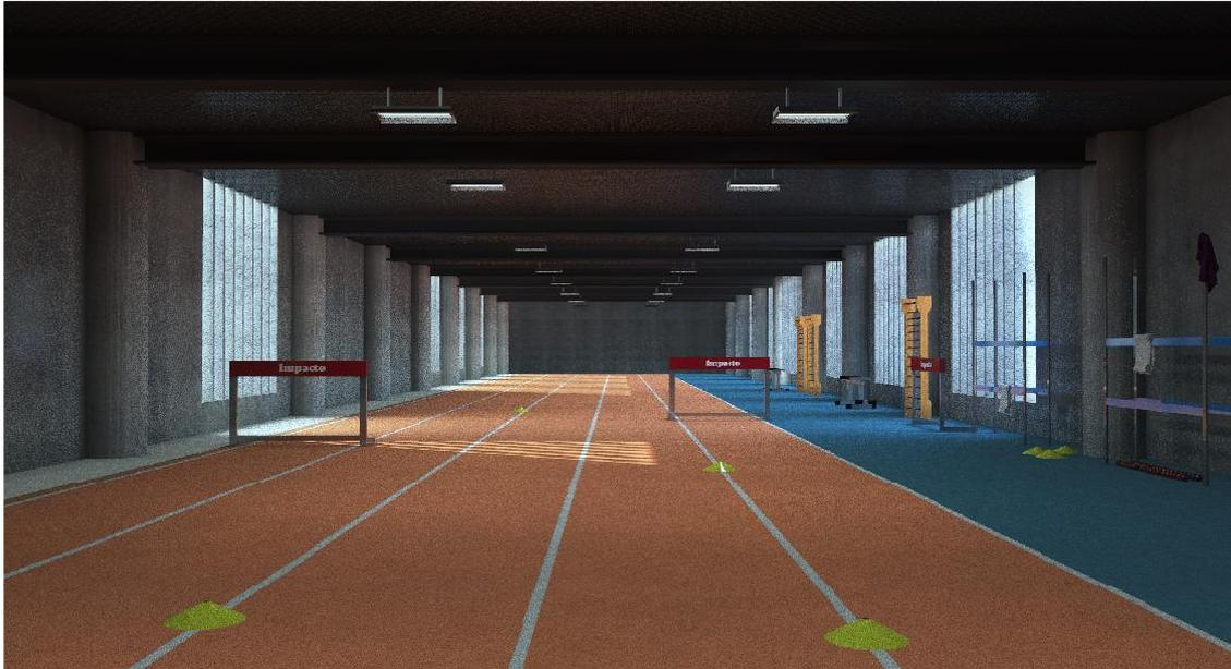
*Nota.* Render interior de la pista atlética techada, se aprecia el trabajo de control solar que realizan las lamas verticales.
