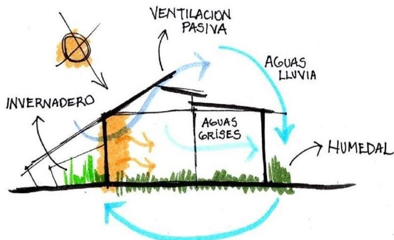
*Nota.* El gráfico muestra el funcionamiento del invernadero solar, en donde se observa el ciclo de termorregulación de un espacio con ventilación pasiva. Tomado de *Plataforma arquitectura.com*
