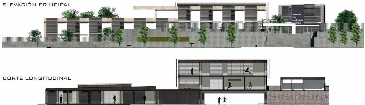
*Nota.* En los cortes se aprecia el desnivel del terreno y la manera como el edificio se adapta a él.
