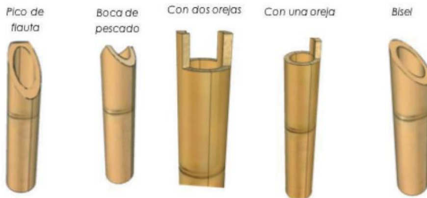
Figura 8: Tipos de corte para uniones entre elementos de bambú.
