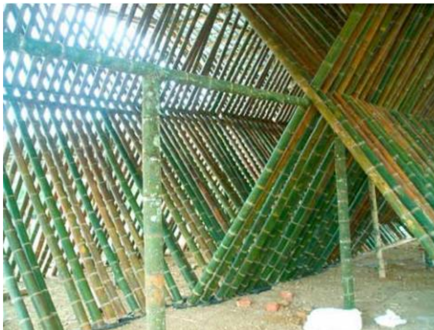
Figura 12: Secado al aire en tijerales Fuente: Manzur, 2011.
