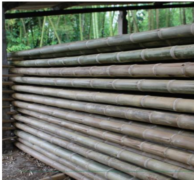
Figura 13: Almacenamiento de bambú Fuente: Manual de construcción con bambú (2010)
