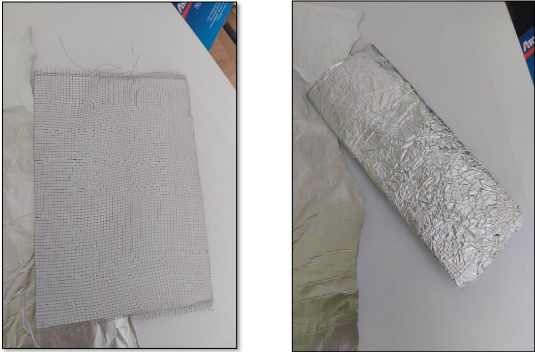
Figura 17: Elementos constructivos con el blindaje
