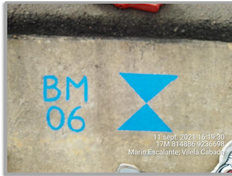
Figura N° 11: Punto de control (BM- 06)
