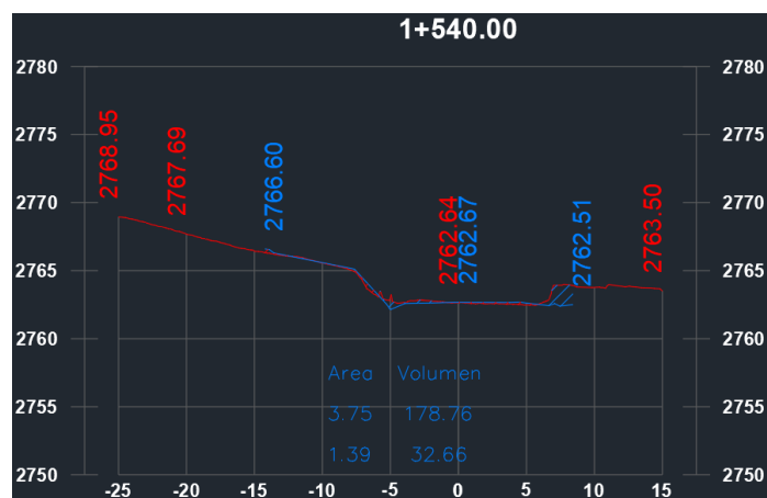
Figura N • 41: Se aprecia de color rojo la superficie del levantamiento Fotogramétrico, y de color azul la superficie del levantamiento Topográfico.
