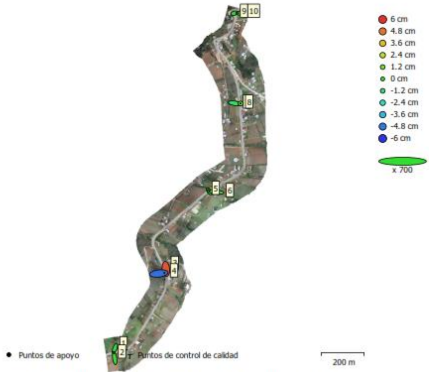
Fig. 14. Posiciones de puntos de apoyo y estimaciones de errores.
