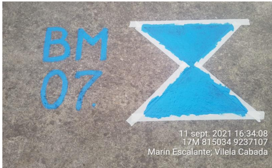
Figura N • 42: Punto de control “BM – 07”.
