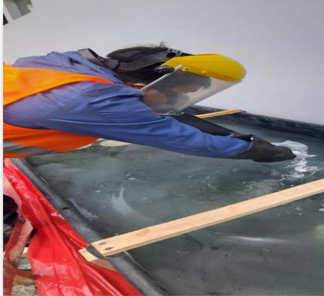
Foto 15. Foto del curado del concreto en sulfatos de magnesio.
