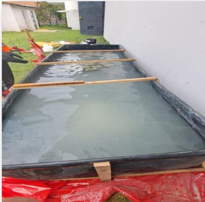
Foto 18. Foto del curado del concreto en agua sulfatada.
