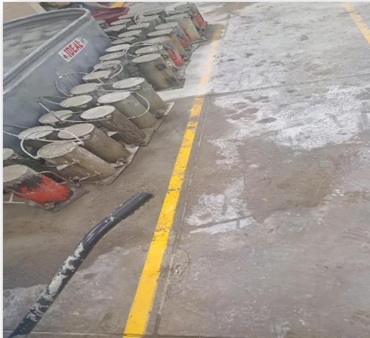
Foto 12. Llenado del tanque de curado ante los sulfatos.
