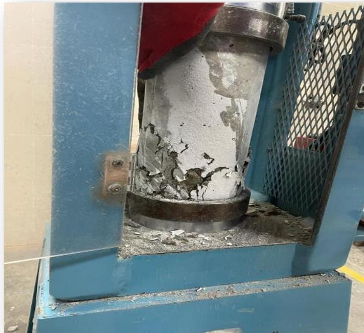
Foto 30. Foto de la carga de ruptura probeta
