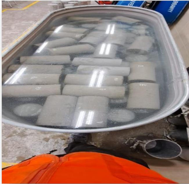
Foto 17. Foto del curado del concreto en agua sulfatada.
