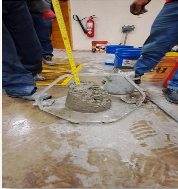
Foto 11. Moldeado de probetas luego del llenado
