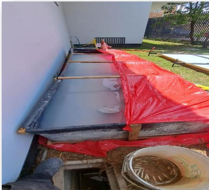
Foto 20. Foto de la poza de curado en agua sulfatada, para evitar exposición al aire.
