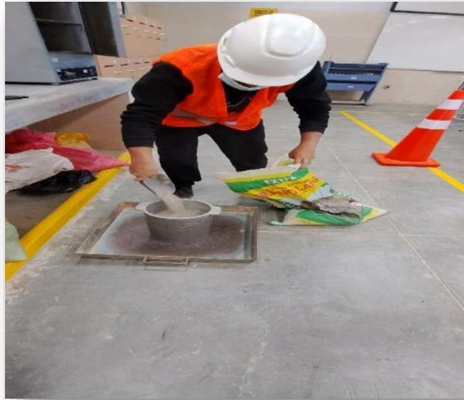
Foto 2. Realización de ensayos de peso unitario agregado grueso.
