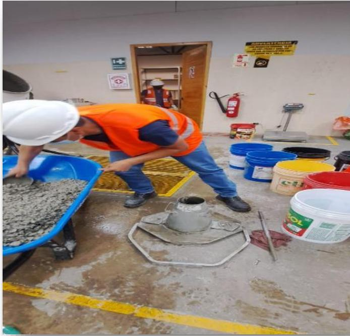
Foto 9. Verificación de la prueba del slump por el Ingeniero. Cesar Valdera
