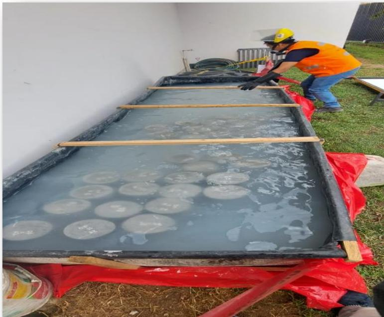
Foto 22. Probetas curadas en sulfatos
