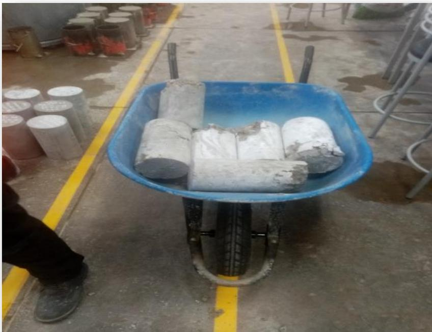
Foto 32. Foto de ataque de los sulfatos en las probetas
