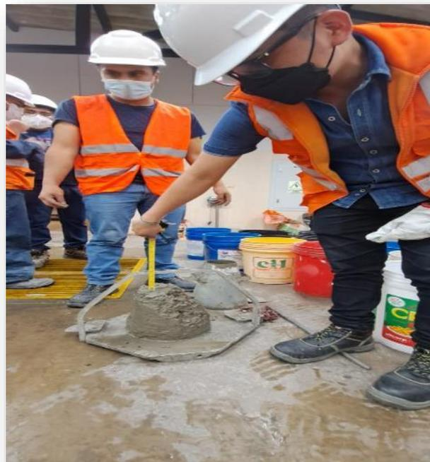
Foto 10. Verificación de la prueba del slump por el Ingeniero. Cesar Valdera
