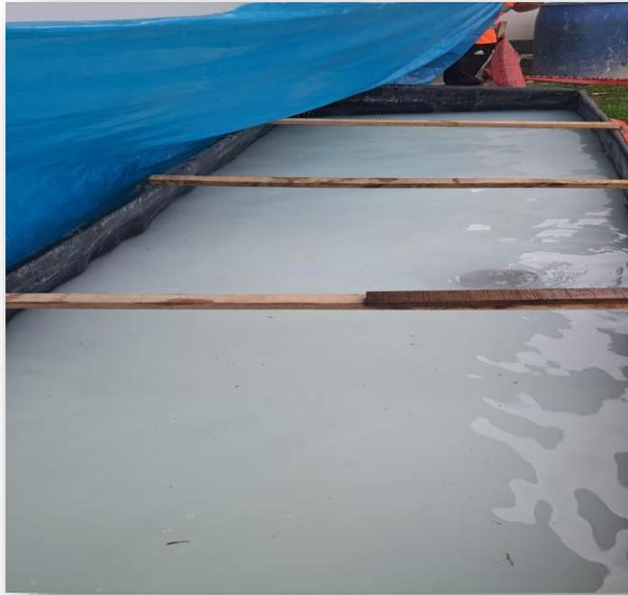
Foto 19. Foto del curado del concreto en agua sulfatada.
