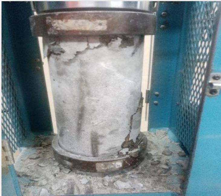
Foto 28. Foto de la ruptura de probetas.
