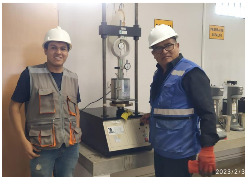
Ensayo de esfuerzo - penetración, prensa CBR.
