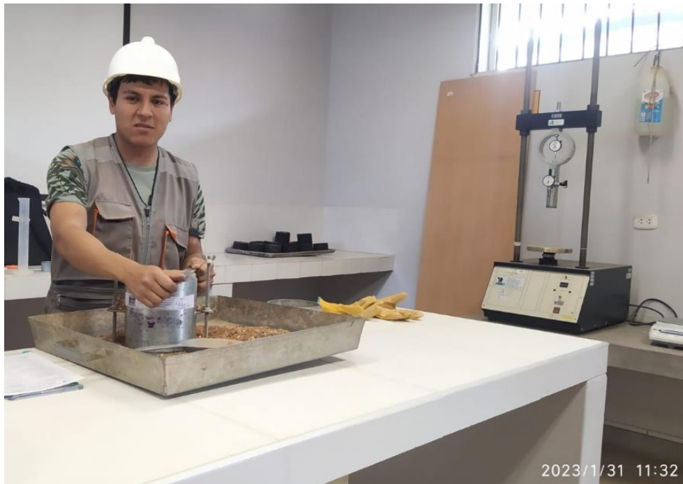
Enrasado del molde 1, ensayo CBR con 5% PVCG.
