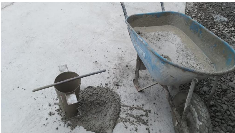
ANEXO N°44: Medición del asentamiento del concreto.
