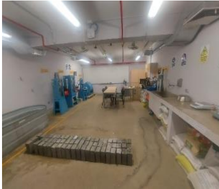
Figura 41. Unidades de albañilería a ensayar, sacados después del proceso de curado
