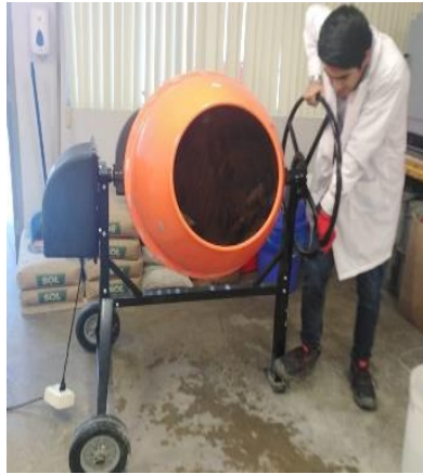
Figura 35. Mezcla de todos los materiales en el trompo
