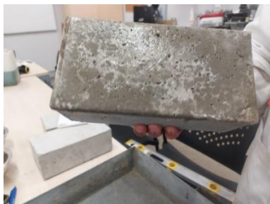
Figura 102. Secar el excedente de agua con un paño húmedo.
