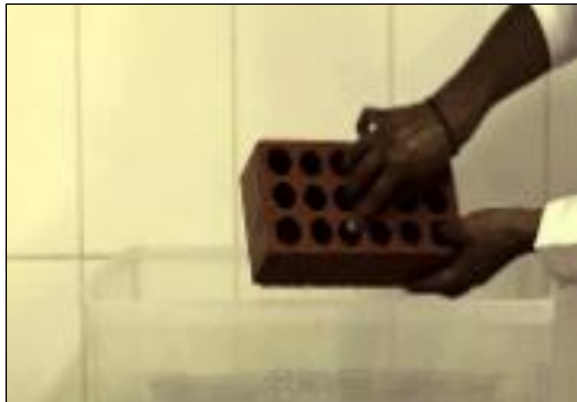
Figura 6. Ensayo de Absorción en unidades de Albañilería
