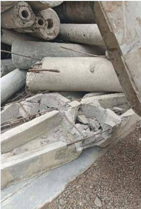
Figura 29. Material reciclado de postes de luz para trituración
