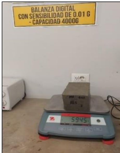
Figura 91. Muestras pesadas después del tiempo de Saturación.
