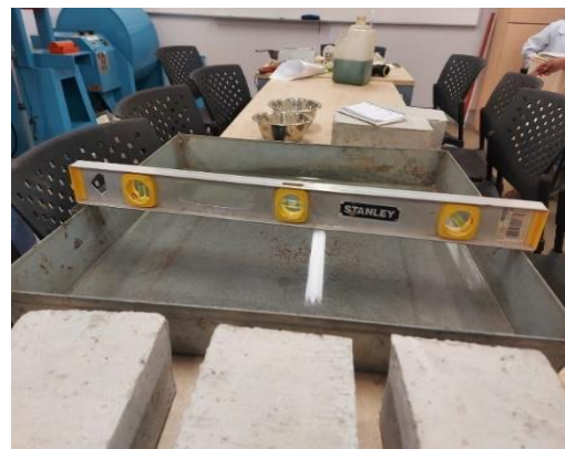
Figura 100. Calibración de la bandeja con Nivel para el ensayo de succión.
