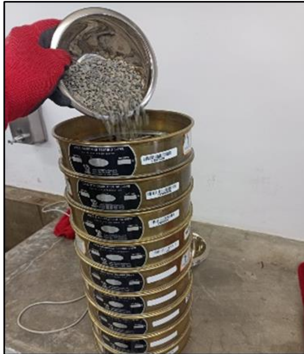
Figura 20. Tamizado del agregado grueso
