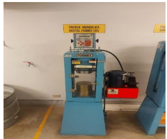
Figura 44. Prensa Hidraulica en donde realizamos el ensayo de compresión
