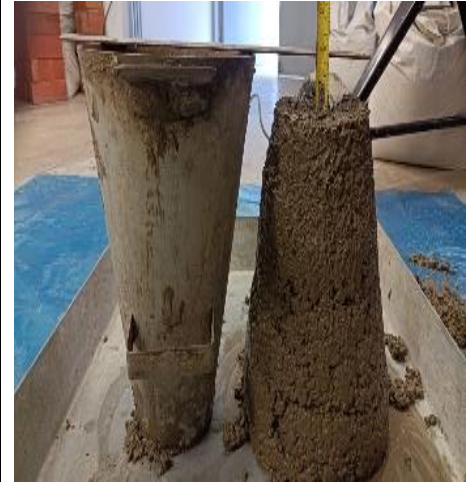
Figura 36. Medición del Slump en el cono de Abrams
