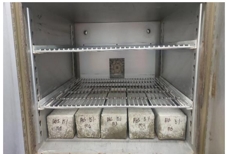
Figura 89. Colocación de las unidades de albañilería al horno durante 24 horas
