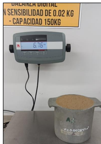
Figura 18. Peso de Volumen específico de arena fina en probeta metálica
