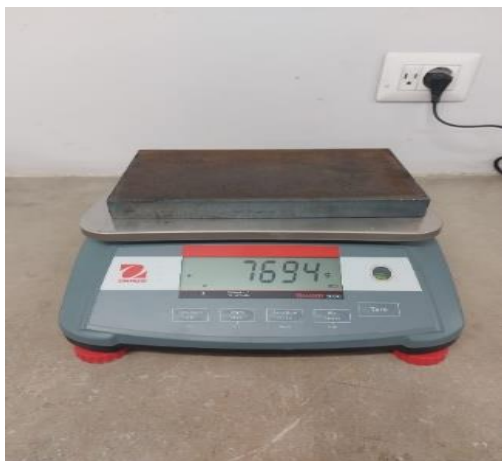
Figura 43. Peso de las planchas de metal a utilizar en la compresión
