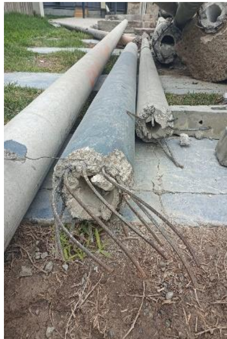
Figura 30. El fierro es separado y simplemente es triturado el concreto del poste
