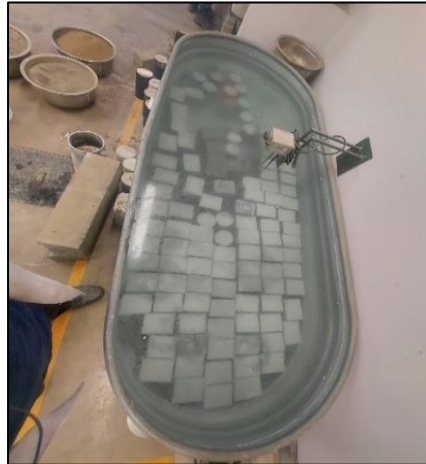
Figura 90. Muestras sumergidas para saturación durante 24 horas.
