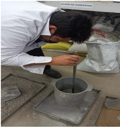
Figura 24. Varillado del Confitillo en la probeta
