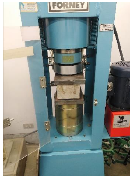
Figura 5. Ensayo de Resistencia a la Compresión en Ladrillos
