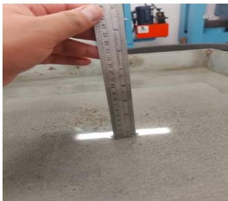
Figura 99. Medición de agua a una altura de 3mm para el ensayo de Succión.
