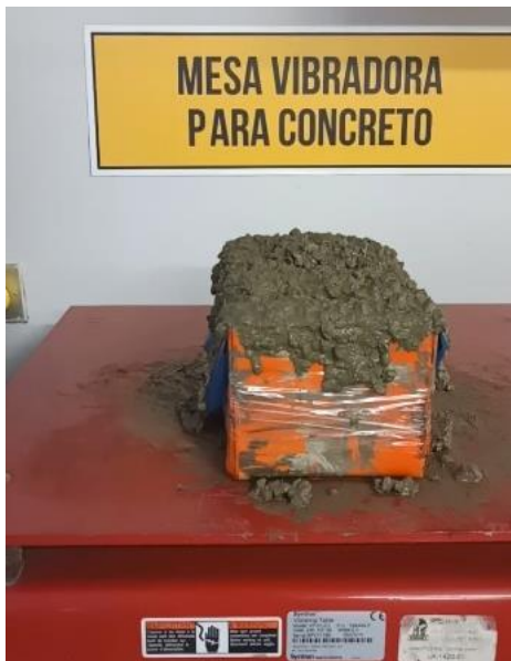
Figura 37. Mesa Vibradora (Espaciamiento en todo el molde de plástico)
