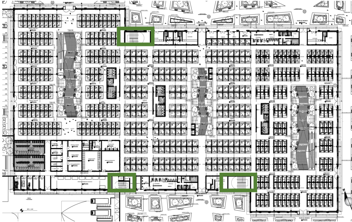
Figura 81: Escalera de Evacuación
