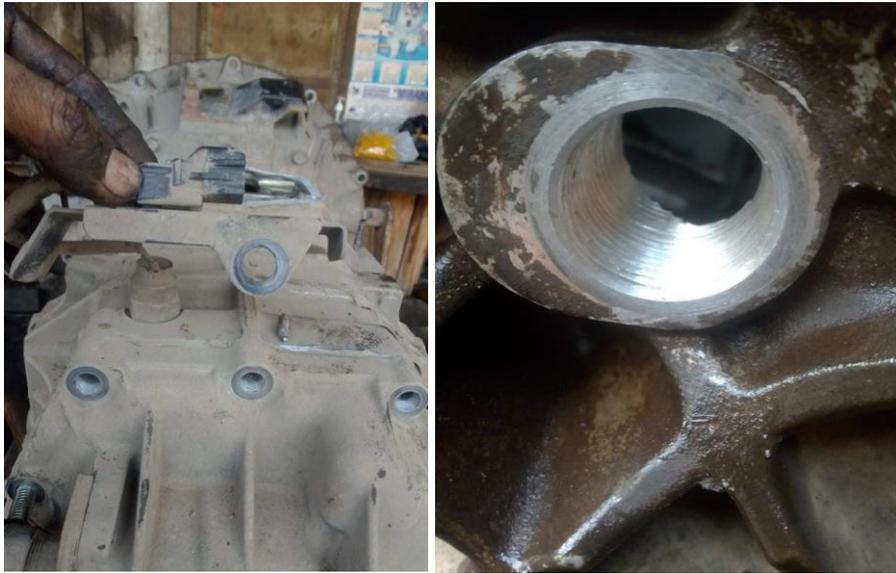
Nota: evidencia del mantenimiento de caja de cambios y rectificación del tapón de aceite.
