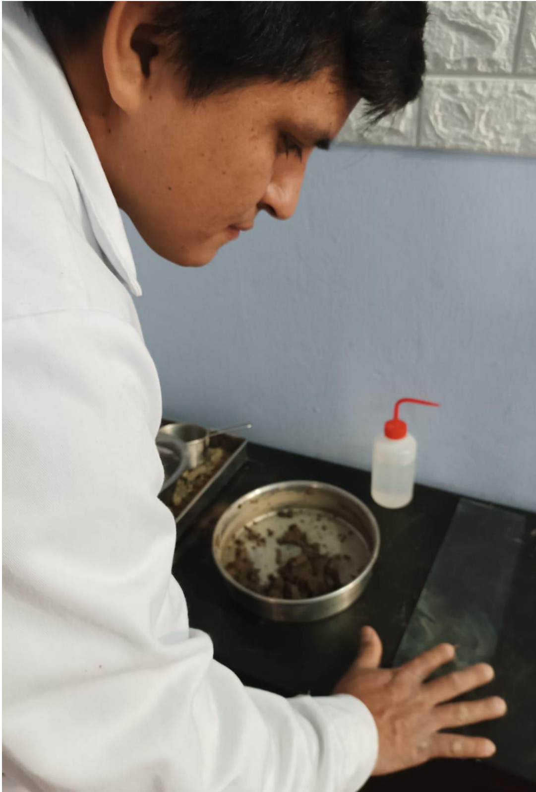
Figura 150: Amasar la muestra humectada, para hallas limite plástico.
