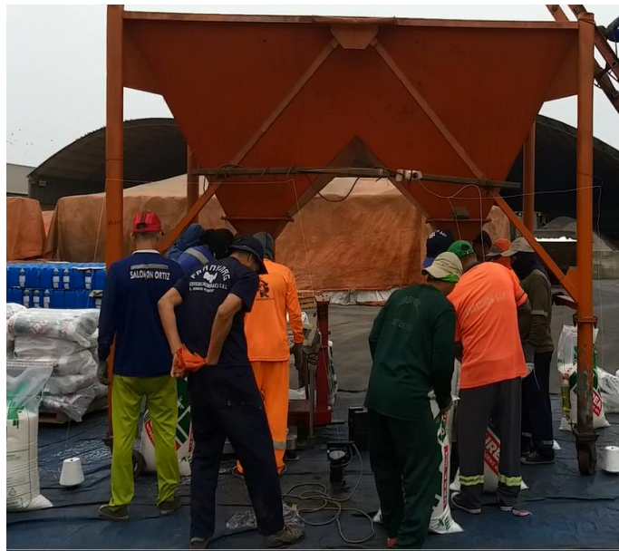
Foto 3.2: Operación en Tolva (dos pesajes, mecánico y electrónico)
