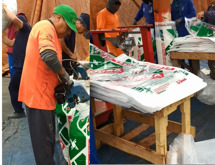
Foto 3.3: Operaciones de llenado, pesado y cosido
