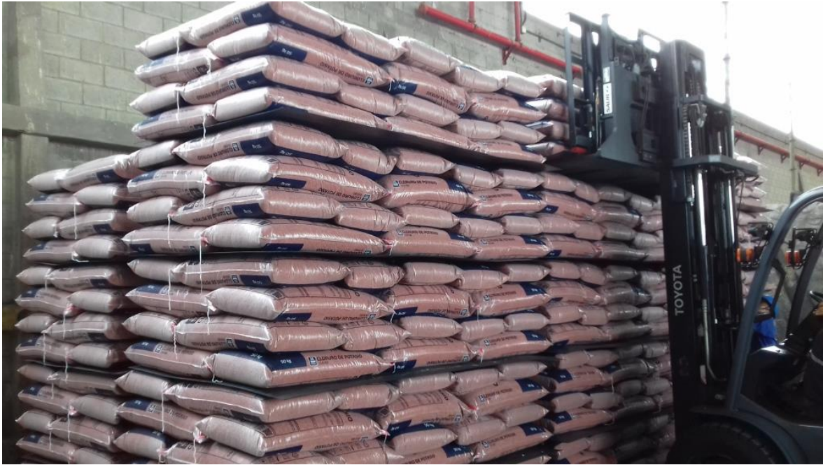
Foto 6.5: Apilamiento de Cloruro Rojo con Montacargas
