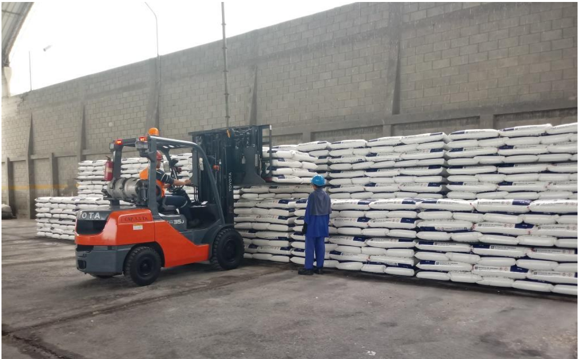
Foto 6.4: Apilamiento de Nitrato de amonio con Montacargas (Sistema Push and Pull)
