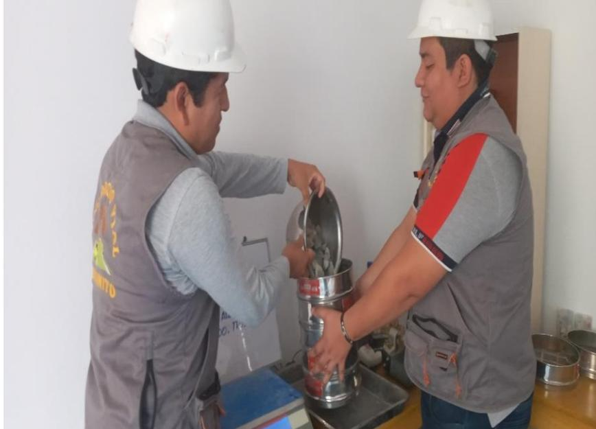
Fotografía N°07 – Caracterización de agregado grueso.
