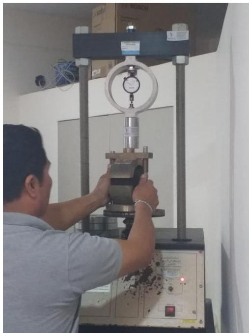
Fotografía N°10 – Ensayo de marshall
