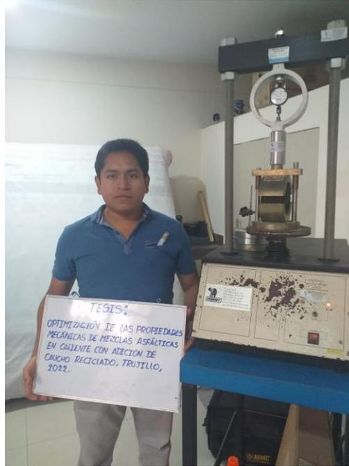
Fotografía N°11 – Ensayo de Marshall
