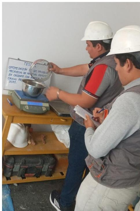
Fotografía N°06 – Caracterización de agregado grueso.
