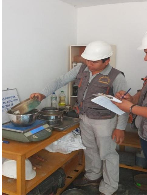
Fotografía N°05 – Caracterización de agregado fino.
