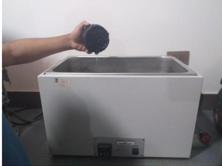
Fotografía N°09 – Conformación de briquetas de ensayo.
