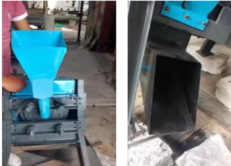
Fotografía N°14 – Corte del caucho reciclado.
