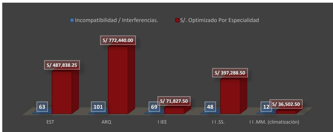
Como se puede ver en la **figura 42**, se obtiene una mayor mejora en cuanto a optimización de costos en la parte de Arquitectura, con un monto de S/ 772,440.00 respecto a una suma de 101 incompatibilidades, a diferencia de la parte de refrigeración y/o climatización en la que solo hubo mejoras de S/ 36,502.50 respecto a una suma de 12 incompatibilidades o interferencias.
