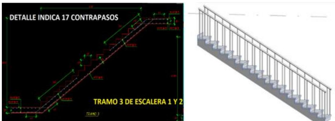
Según la representación en la programación BIM, como se muestra en la **figura 28**, muestra 17 contrapasos en los planos estructurales y en el plano de diseño, no obstante, según la proposición, serían imprescindibles 18 contrapasos.
