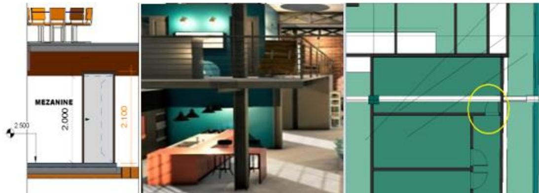
Como indica la **figura 33** en el modelo BIM, la puerta que abre hacia el interior se lo impide una viga peraltada a una distancia de más de 50cm, lo que impediría que se aperture en los entrepisos.
