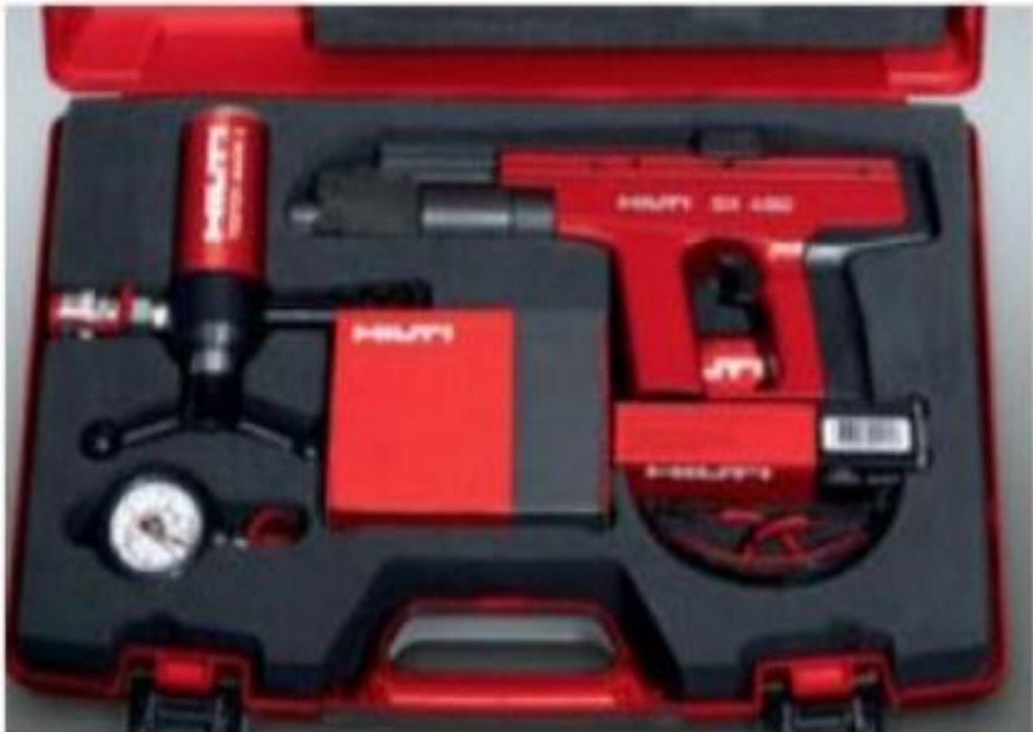
Figura D10 Pistola Hilti para ensayos de resistencias tempranas
