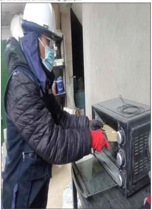
Nota. En esta figura se muestra parte del proceso del ensayo de humedad en agregado fino.
