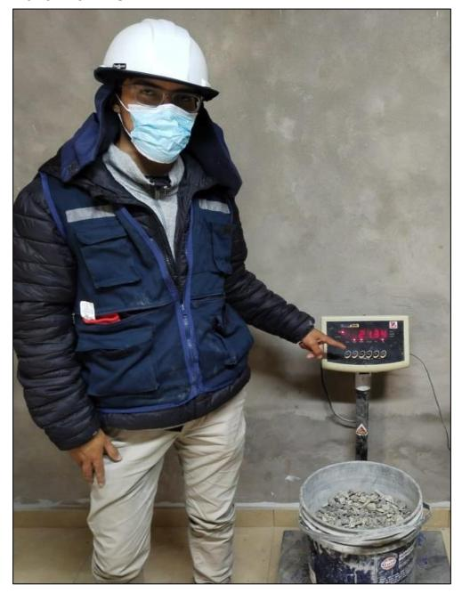
*Nota*. En esta figura se muestra parte del proceso de la mezcla de concreto, pensando el agregado grueso.
