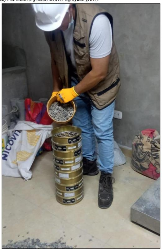
*Nota*. En esta figura se muestra parte del proceso del ensayo de análisis de granulometría en agregado grueso.
