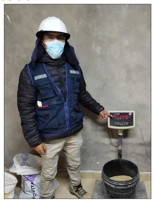
*Nota*. En esta figura se muestra parte del proceso de la mezcla de concreto, pensando el agregado fino.
