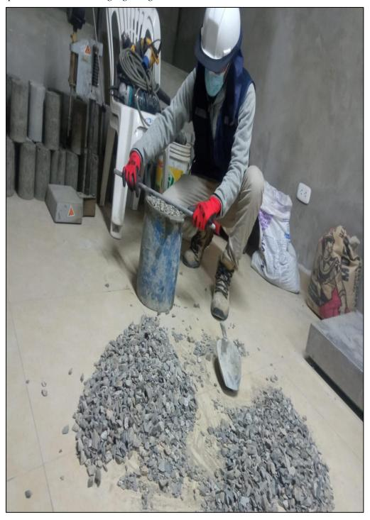
*Nota*. En esta figura se muestra parte del proceso del ensayo de peso unitario suelto en agregado grueso.
