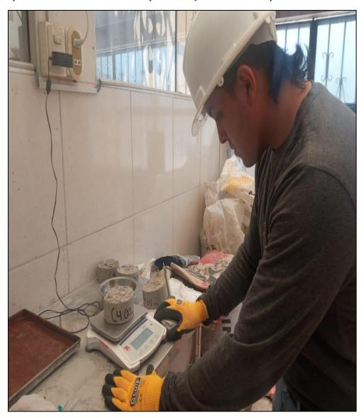
*Nota*. En esta figura se muestra la toma de peso de las probetas de concreto cortadas para el ensayo de succión capilar.
