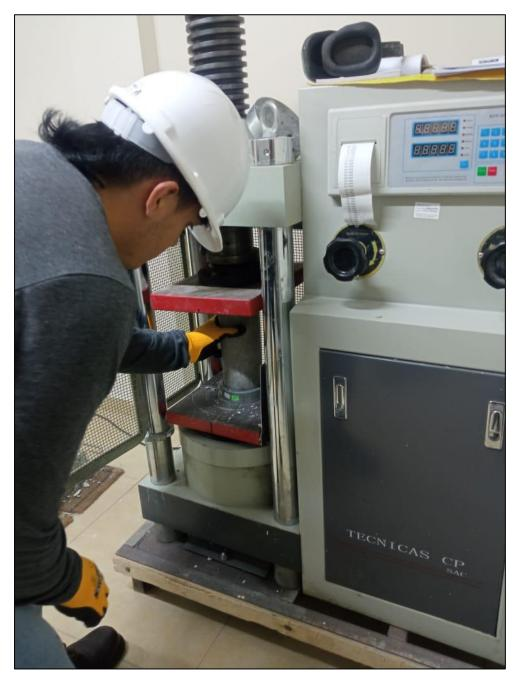
*Nota*. En esta figura se muestra el ensayo de rotura de probetas de concreto para la resistencia a la compresión.
