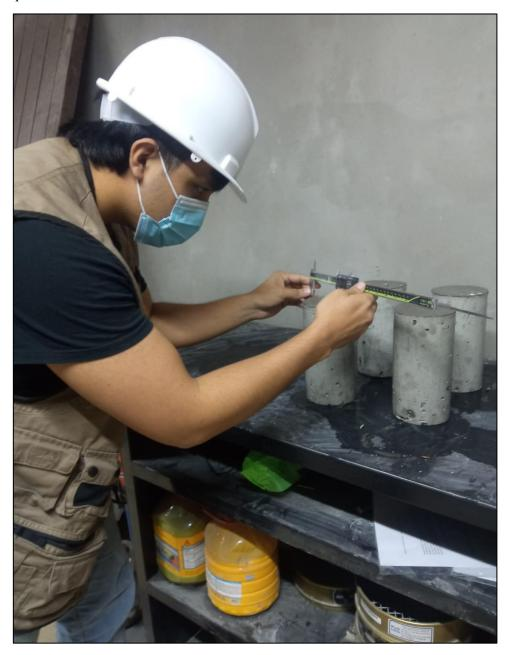
Nota. En esta figura se muestra la medición de las probetas de concreto.
