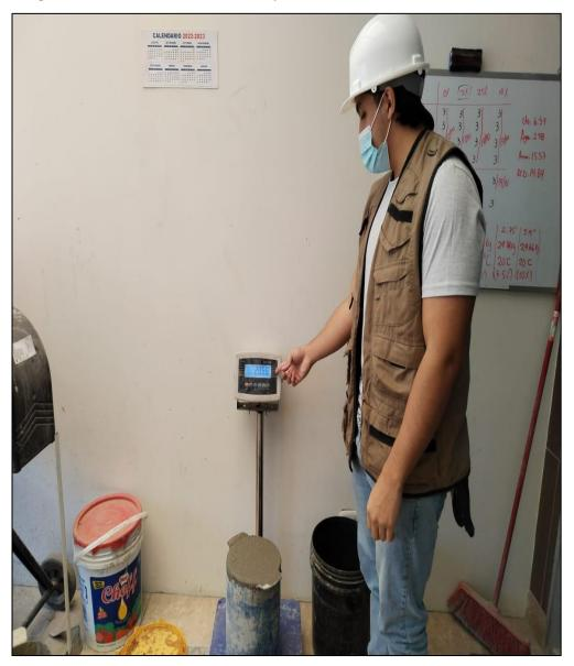
*Nota*. En esta figura se muestra el ensayo de peso unitario en la mezcla de concreto en estado fresco.
