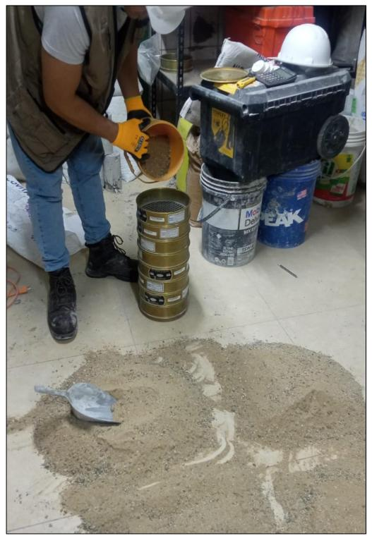
*Nota*. En esta figura se muestra parte del proceso del ensayo de análisis de granulometría en agregado fino.
