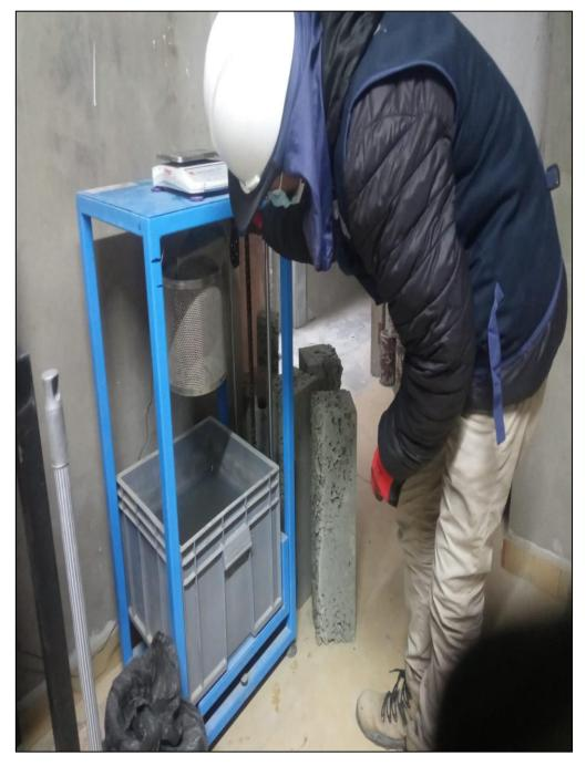
Nota. En esta figura se muestra parte del proceso del ensayo de peso específico y absorción en agregado grueso.
