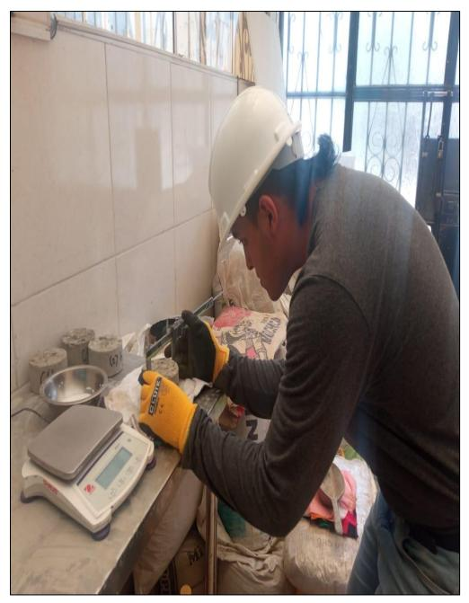
*Nota*. En esta figura se muestra la toma de medidas de las probetas de concreto cortadas para el ensayo de succión capilar.
