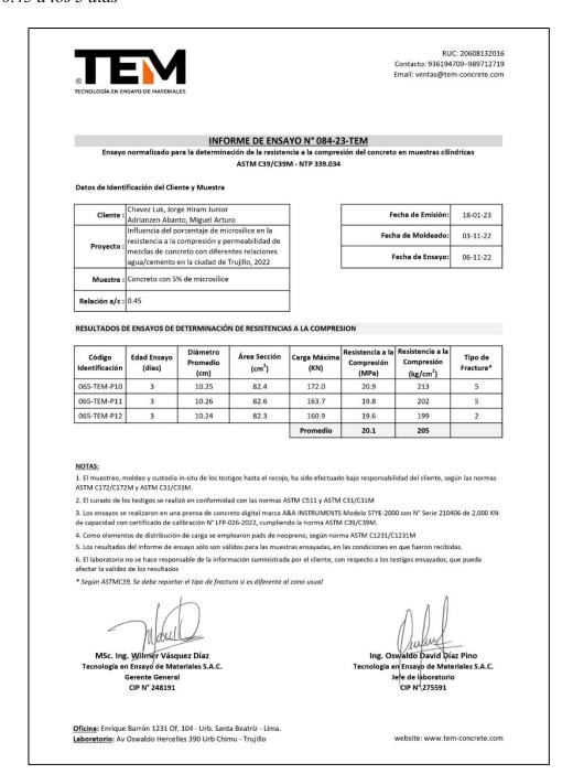
*Nota*. En esta figura se muestra el resultado del ensayo de resistencia a la compresión del concreto con adición de 5% de microsílice con relación a/c de 0.45 a los 3 días.
