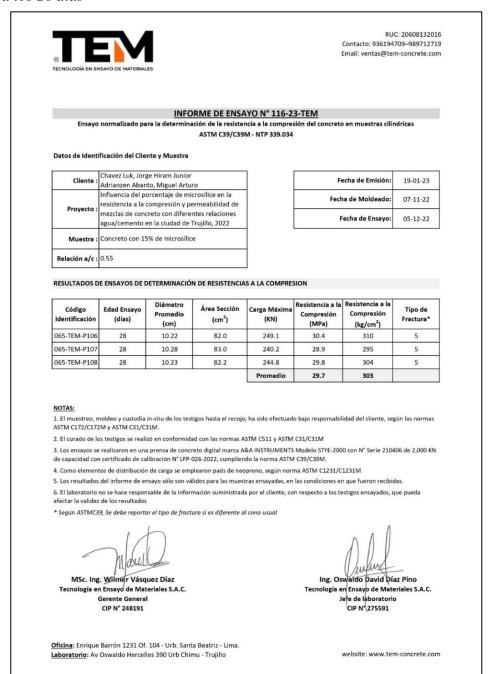
*Nota*. En esta figura se muestra el resultado del ensayo de resistencia a la compresión del concreto con adición de 15% de microsílice con relación a/c de 0.55 a los 28 días
