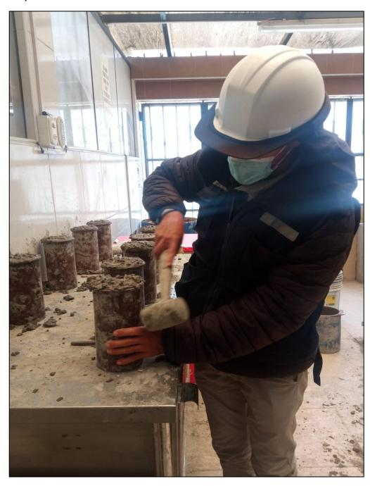
*Nota*. En esta figura se muestra la elaboración de las probetas de concreto y los golpes realizados por el mazo.
