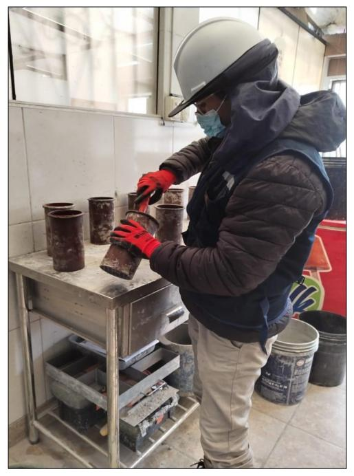
*Nota*. En esta figura se muestra la preparación de los moldes para agregar la mezcla de concreto.
