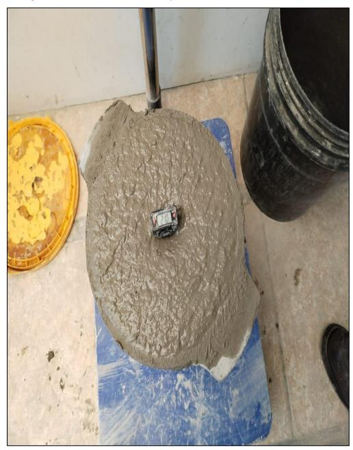
*Nota*. En esta figura se muestra la toma de temperatura en la mezcla de concreto en estado fresco.
