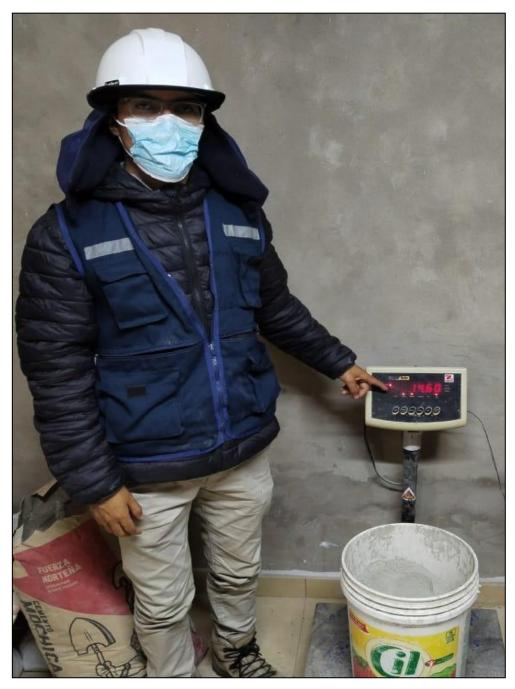
*Nota*. En esta figura se muestra parte del proceso de la mezcla de concreto, pensando el cemento.
