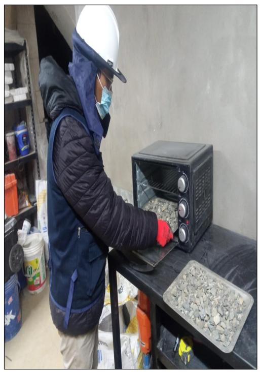
Nota. En esta figura se muestra parte del proceso del ensayo de humedad en agregado grueso.
