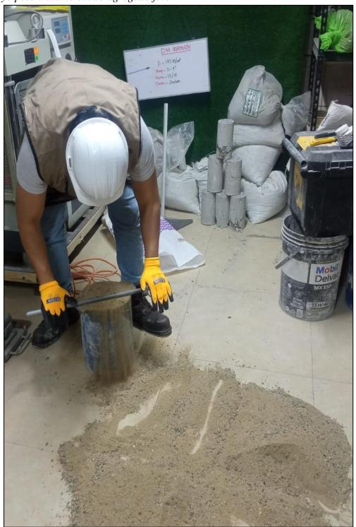
*Nota*. En esta figura se muestra parte del proceso del ensayo de peso unitario suelto en agregado fino.
