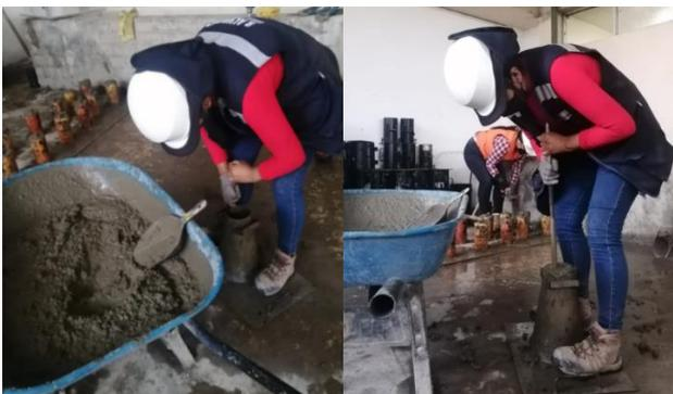
*Nota:* Como parte del proceso se desarrolla el vibrado de la mezcla mediante la varilla lisa de 5/8" por cada capa con 25 golpes.
