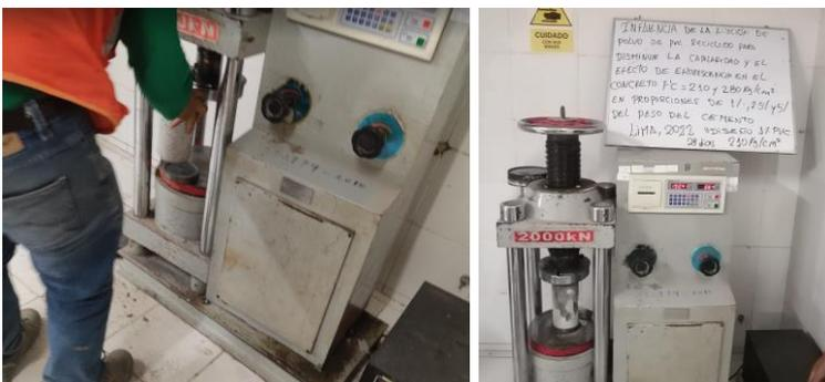
*Nota:* Se coloca la probeta a la máquina de rotura, se sugiere que se tenga el apoyo de un personal capacitado en el manejo de esta máquina para evitar accidentes. Fuente propia.
