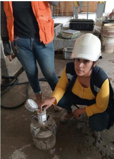
*Nota.* La mezcla de concreto patrón de  $f'c=210 \text{ kg/cm}^2$  nos dio 1.2% de contenido de aire
