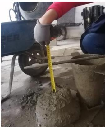
*Nota.* El concreto de  $f'c=210 \text{ kg/cm}^2$  al que se le agregó el 2.5% de polvo PVC reciclado, nos da un slump de 6.5”.
