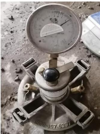
*Nota.* El concreto de  $f'c=280 \text{ kg/cm}^2$  al que se le agrego el 1% de polvo de PVC reciclado, nos da como resultado del porcentaje de aire contenido de 2.5%.
