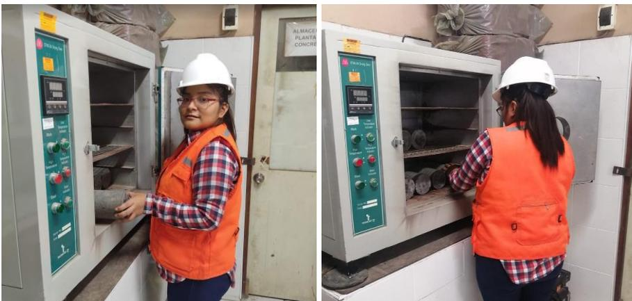
*Nota:* Se ingresa las probetas para su secado al horno con una temperatura de  $110^{\circ}\text{C}$  por 24 horas.
