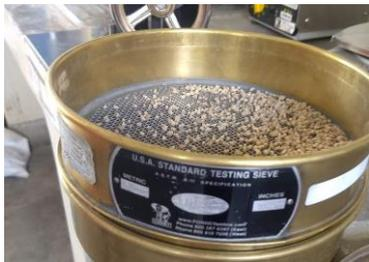
*Nota:* Se realizó el tamizado de la arena por diferentes mallas para obtener el porcentaje de retención.
