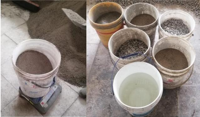
*Nota:* Realizamos el pesado de los agregados, cemento y agua, para ello nos ayudamos con una balanza y baldes.
