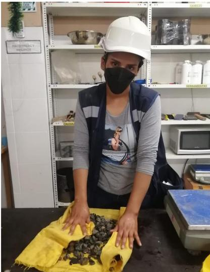
*Nota:* Para el secado de la muestra usamos una franela limpia para eliminar el agua superficial.
