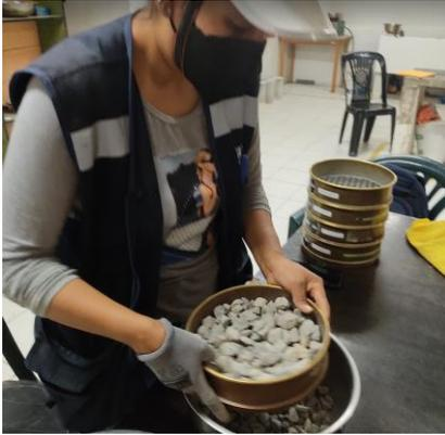
*Nota:* Se realizó el tamizado de la piedra por diferentes mallas para obtener el porcentaje de retención.
