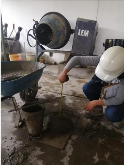
*Nota.* El concreto de  $f'c=210 \text{ kg/cm}^2$  al que se le agrego el 1% de polvo de PVC reciclado, nos da un slump de 8.5”.
