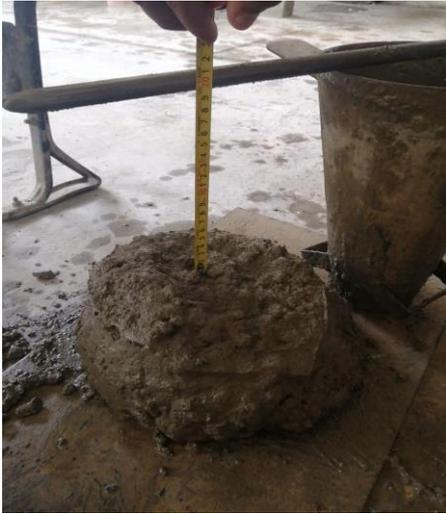
*Nota.* El concreto de  $f'c=210 \text{ kg/cm}^2$  al que se le agregó el 5% de polvo PVC reciclado, nos da un slump de 8”.
