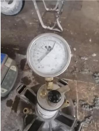
*Nota.* El concreto de  $f'c=210 \text{ kg/cm}^2$  al que se le agregó el 2.5% de polvo de PVC reciclado, nos da como resultado del porcentaje de aire contenido de 3.9 %.
