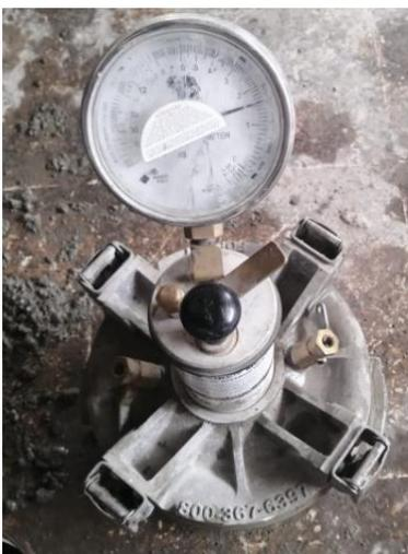
*Nota.* Para el diseño de mezcla patrón  $f'c=280 \text{ kg/cm}^2$  tenemos un contenido de aire de 1.6%
