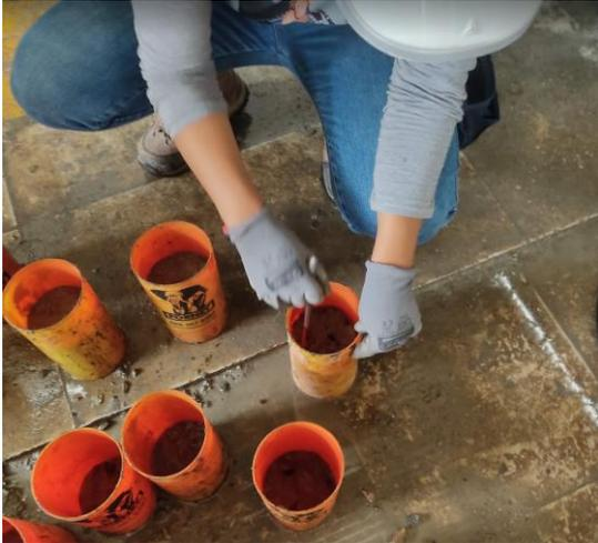
*Nota:* En cada capa de concreto se realiza una compactación de 25 penetraciones con la varilla, para distribuir el concreto en todo el molde.
