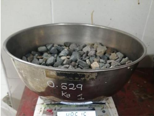
*Nota:* El peso de la muestra después del secado por 24 horas en el horno y enfriado al al aire libre.
