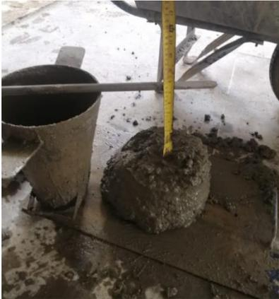
*Nota.* El concreto de  $f'c=280 \text{ kg/cm}^2$  al que se le agregó el 2.5% de polvo de PVC reciclado, nos da un slump de 7.5”.
