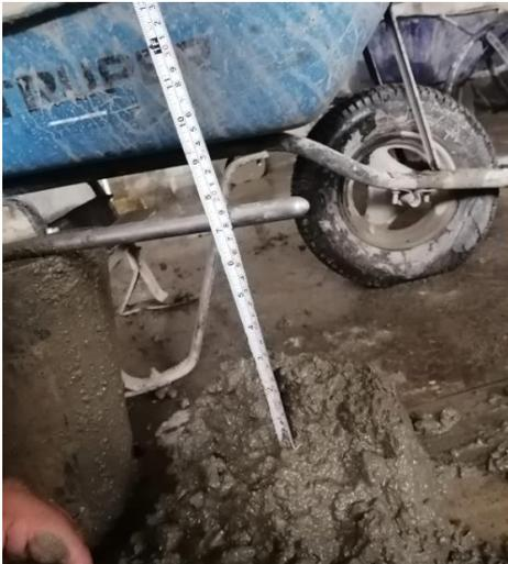
*Nota.* El diseño de mezcla patrón de  $f'c=280\text{kg/cm}^2$  nos da un slump de 7”
