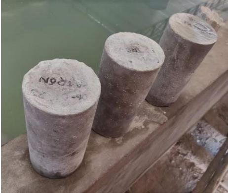
*Nota:* Se retira las probetas de la poza de curado, transcurrido 7, 14 y 28 días para al ensayo de resistencia a la compresión para cada diseño de concreto realizado de  $f'c= 210$  y  $280\text{kg/cm}^2$ .
