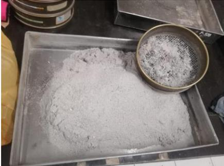
*Nota:* Se observa que en el tamiz de la malla #16, a retenido las impurezas que se tiene en el polvo de PVC.
