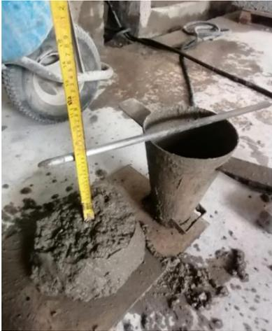
*Nota.* El concreto de  $f'c=280 \text{ kg/cm}^2$  al que se le agrego el 2.5% de polvo de PVC reciclado, nos da un slump de 7”.
