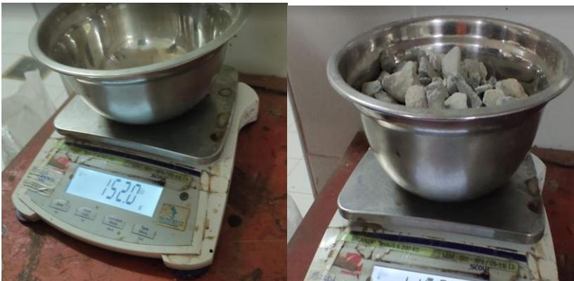
*Nota:* Se realizó primero el pesado de Tara y posteriormente el pesado del agregado retenido por cada tamiz.
