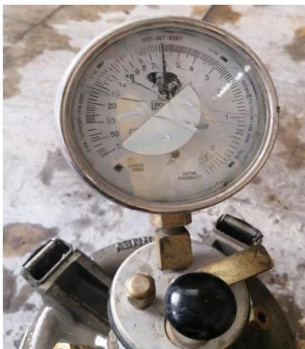
*Nota.* El concreto de  $f'c=210 \text{ kg/cm}^2$  al que se le agrego el 5% de polvo de PVC reciclado, nos da como resultado del porcentaje de aire contenido de 6%.
