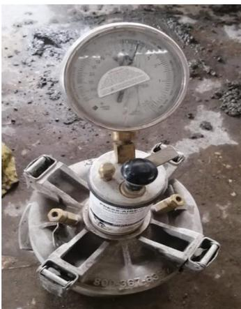
*Nota.* El concreto de  $f'c=280 \text{ kg/cm}^2$  al que se le agrego el 2.5% de polvo de PVC reciclado, nos da como resultado del porcentaje de aire contenido de 4.3%.
