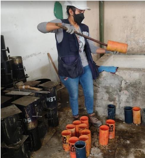
*Nota:* Se engrasa los moldes para evitar que la mezcla de concreto no se adhiera al molde y se ha fácil para desmoldar.
