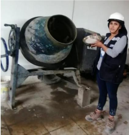
*Nota.* Se pesa el 2.5% de polvo de PVC reciclado según dosificación y se añade a la mezcla que esta siendo batida en la mezcladora.
