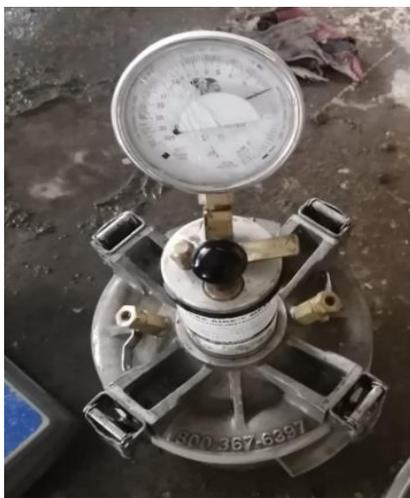
*Nota.* El concreto de  $f'c=210 \text{ kg/cm}^2$  al que se le agrego el 1% de polvo de PVC reciclado, nos da como resultado el porcentaje de aire contenido de 2.1%.
