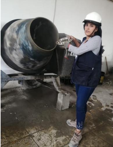
*Nota.* Se pesa el 1% de polvo de PVC reciclado según dosificación y se añade a la mezcla que esta siendo batida en la mezcladora.
