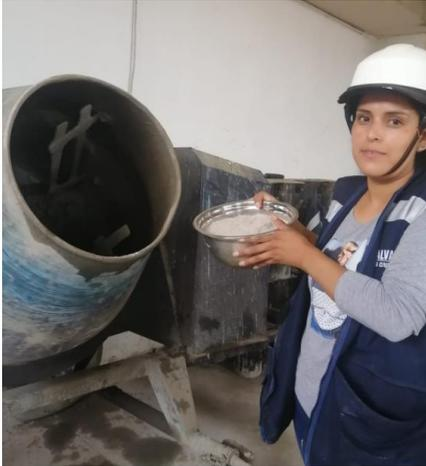
*Nota.* Se pesa el 5% de polvo de PVC reciclado según dosificación y se añade a la mezcla que esta siendo batida en la mezcladora.
