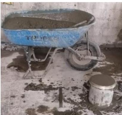
*Nota.* El concreto que es usado para este ensayo, no debe retornar al bugui o carretilla, por el agua añadido en la prueba, debe ser eliminada.
