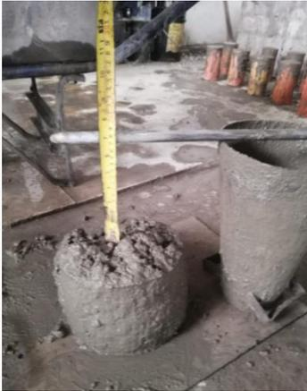
*Nota.* El concreto de  $f'c=280 \text{ kg/cm}^2$  al que se le agrego el 1% de polvo de PVC reciclado, nos da un slump de 6.5”.
