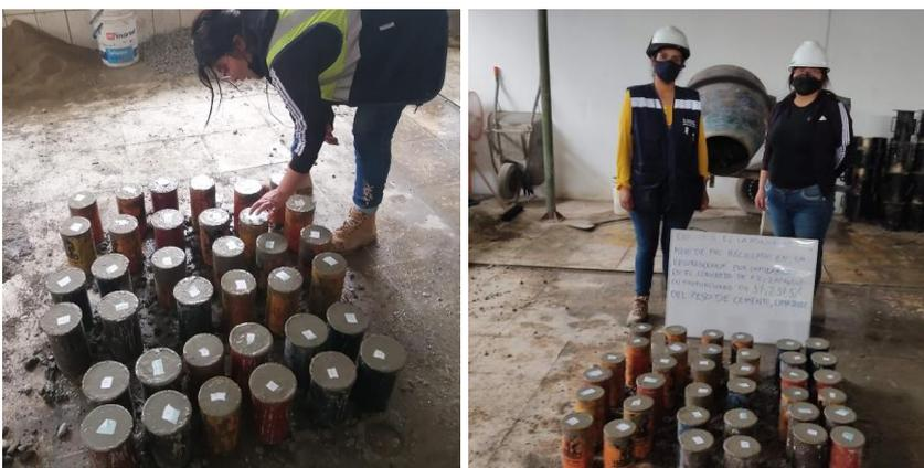
*Nota:* Identificamos con un papel el porcentaje de PVC de cada probeta hasta su secado.
