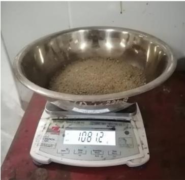
*Nota:* Se pesa una cantidad aproximada de 1000g. de agregado fino para el ensayo.
