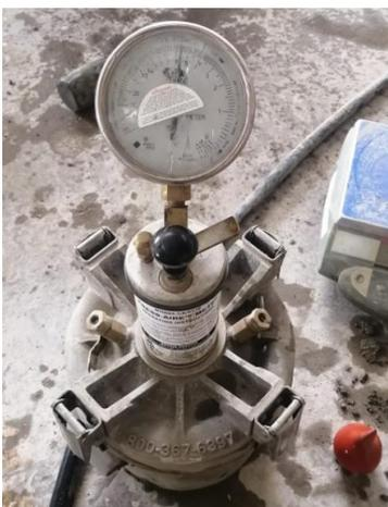
*Nota.* El concreto de  $f'c=280 \text{ kg/cm}^2$  al que se le agrego el 5% de polvo de PVC reciclado, nos da como resultado del porcentaje de aire contenido de 5.5%.
