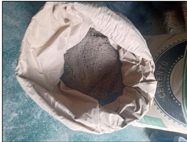
Imagen 9: Agregado fino utilizado
