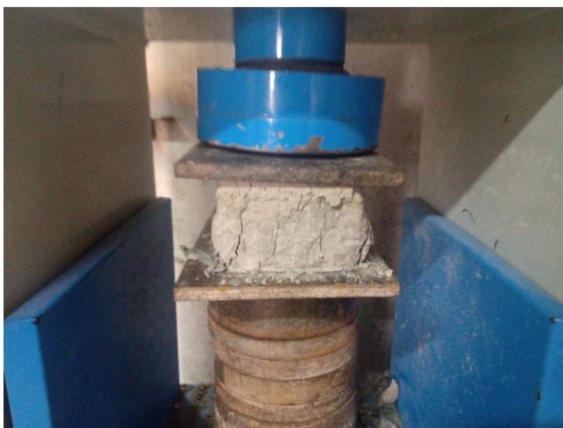
Imagen 13 Adoquín luego de alcanzar su resistencia máxima
