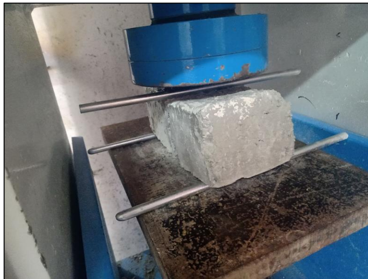
Imagen 15 Ensayo de flexotracción
