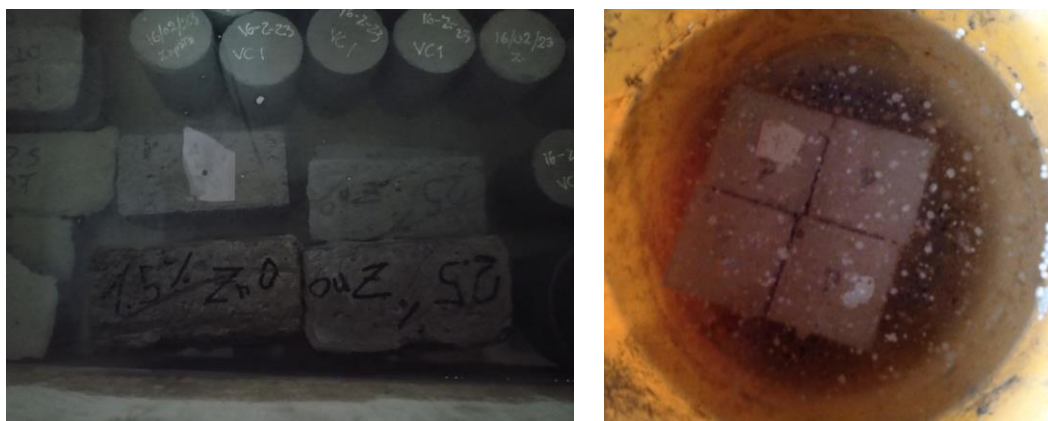
Imagen 12: Curado de adoquines (izq.) y cubos de concreto (der)
