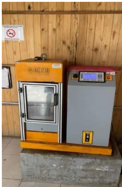
Anexo 10. Rotura de adoquines (28 días) en el ensayo a compresión.
