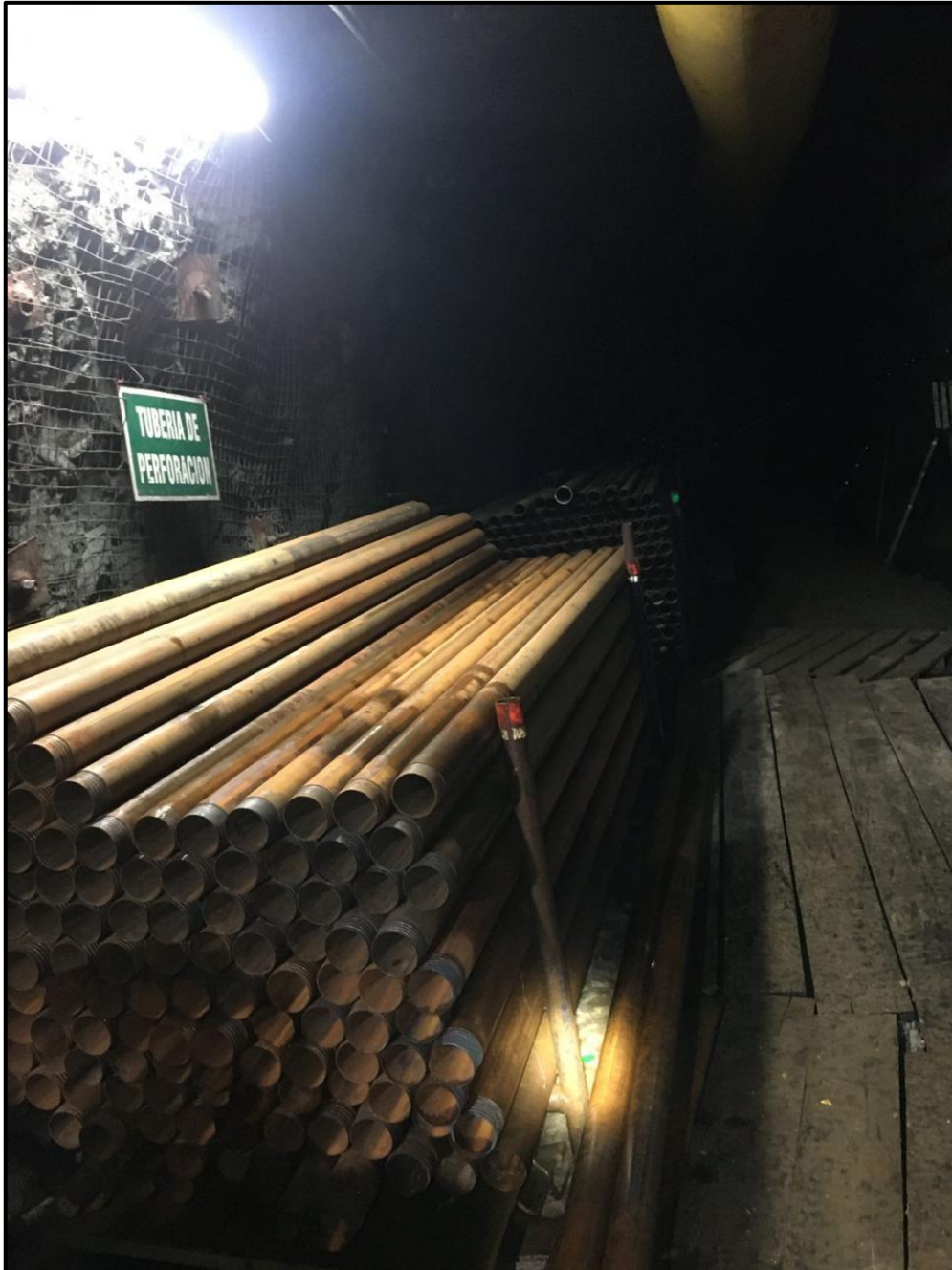
Figura 16: Tuberías para perforación diamantina.
