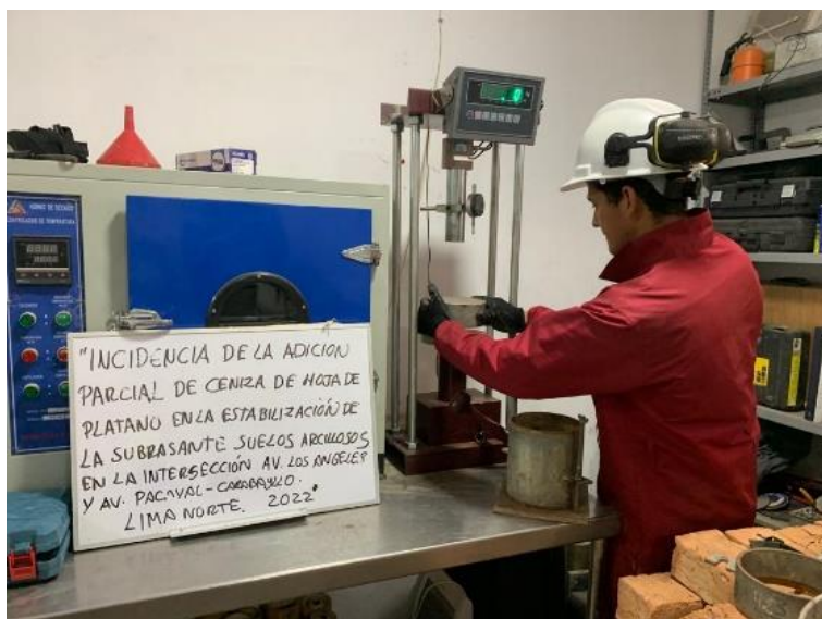
Figura 15: Ensayo de CBR en laboratorio
