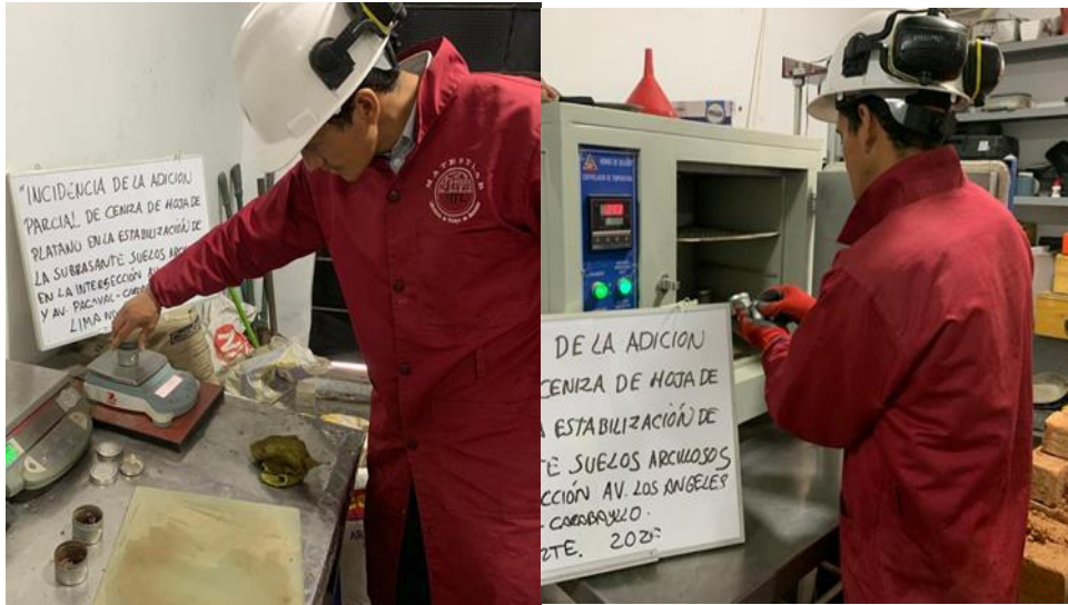
Figura 13: Ensayo Limites de consistencia
