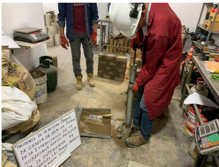
Figura 17: Ensayo de Proctor modificado en el Laboratorio
