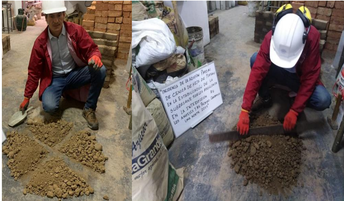
Figura 8: Cuarteo del agregado a ensayar
