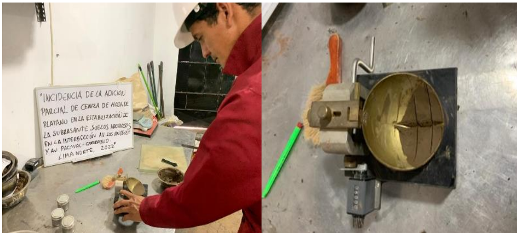
Figura 12: Ensayo Limite Plástico
