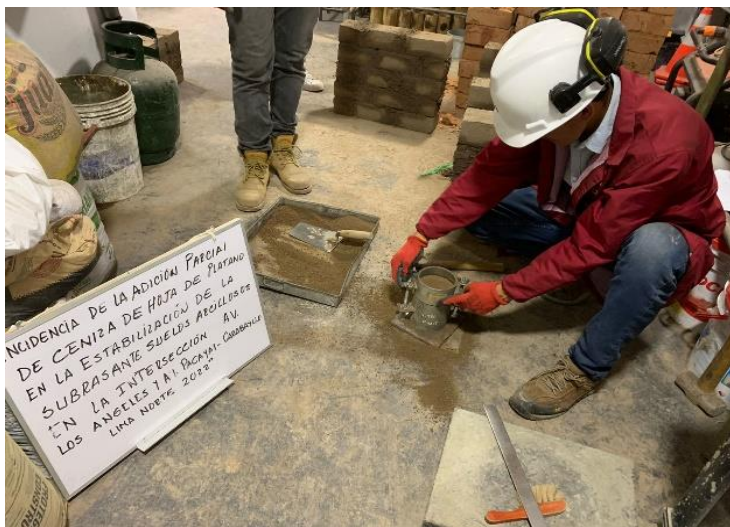
Figura 17: Ensayo de Proctor modificado en el Laboratorio
