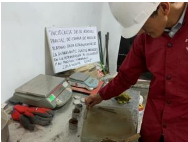
Figura 12: Ensayo Limite Plástico
