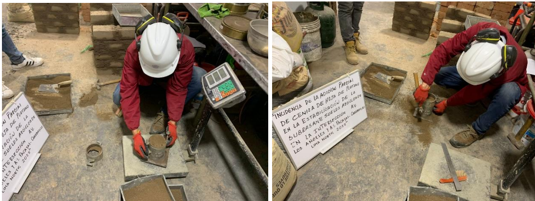
Figura 42: Tamizado del agregado a ensayar
