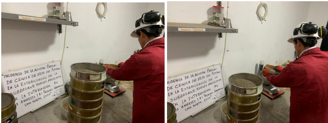
Figura 42: Tamizado del agregado a ensayar
