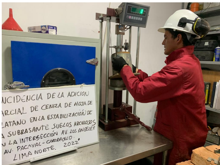
Figura 15: Ensayo de CBR en laboratorio
