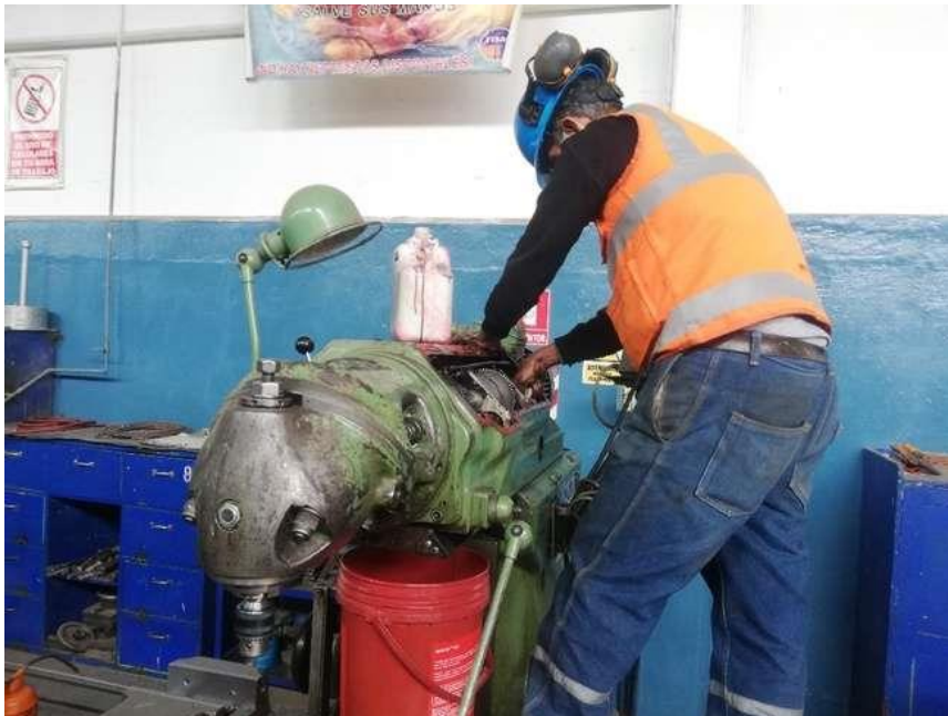
Figura 35. Reparación de engranajes de fresadora número 1.
