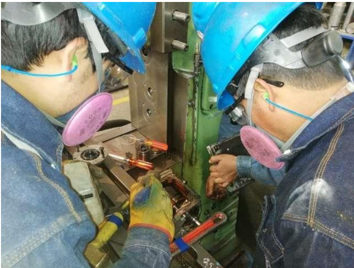
Figura 33. Reparación de engranaje de selección de avance de fresadora número 1.
