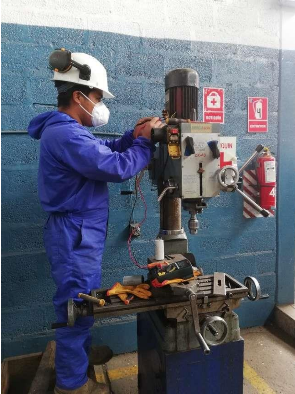
Figura 48. Reparación de taladro de columna, se rebobinó el motor.
