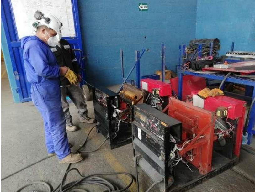
Figura 36. Reparación de máquinas de soldar.
