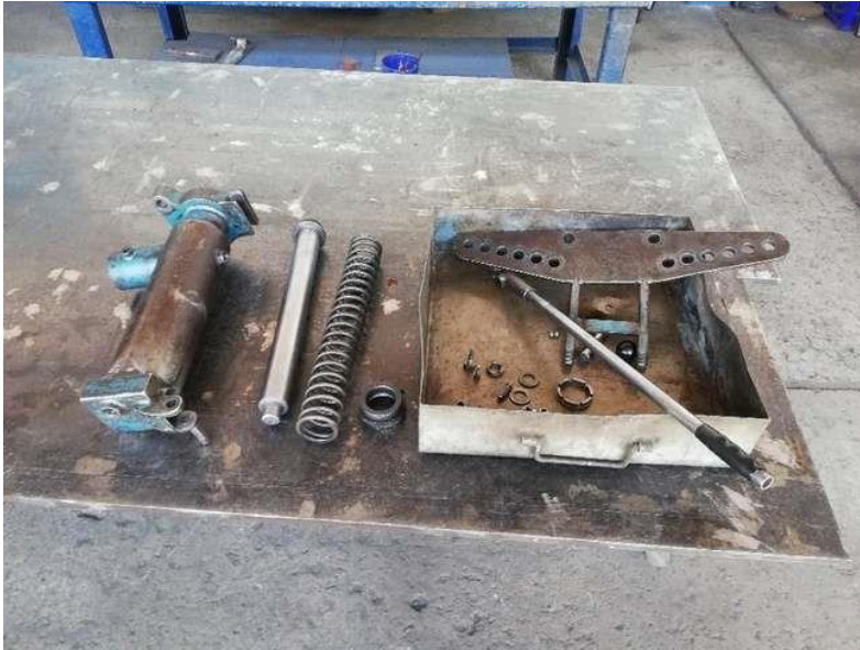
Figura 38. Reparación de dobladora hidráulica.
