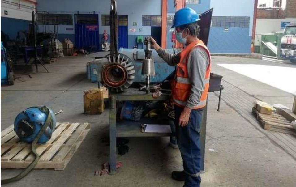
Figura 40. Reparación de freno de motor de puente grúa número 2.
