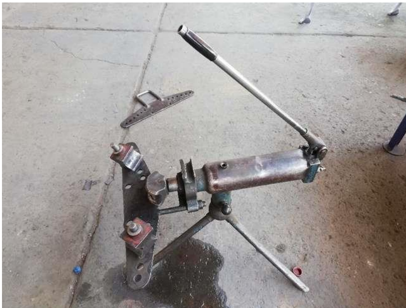
Figura 37. Fuga hidráulica de dobladora de tubos.
