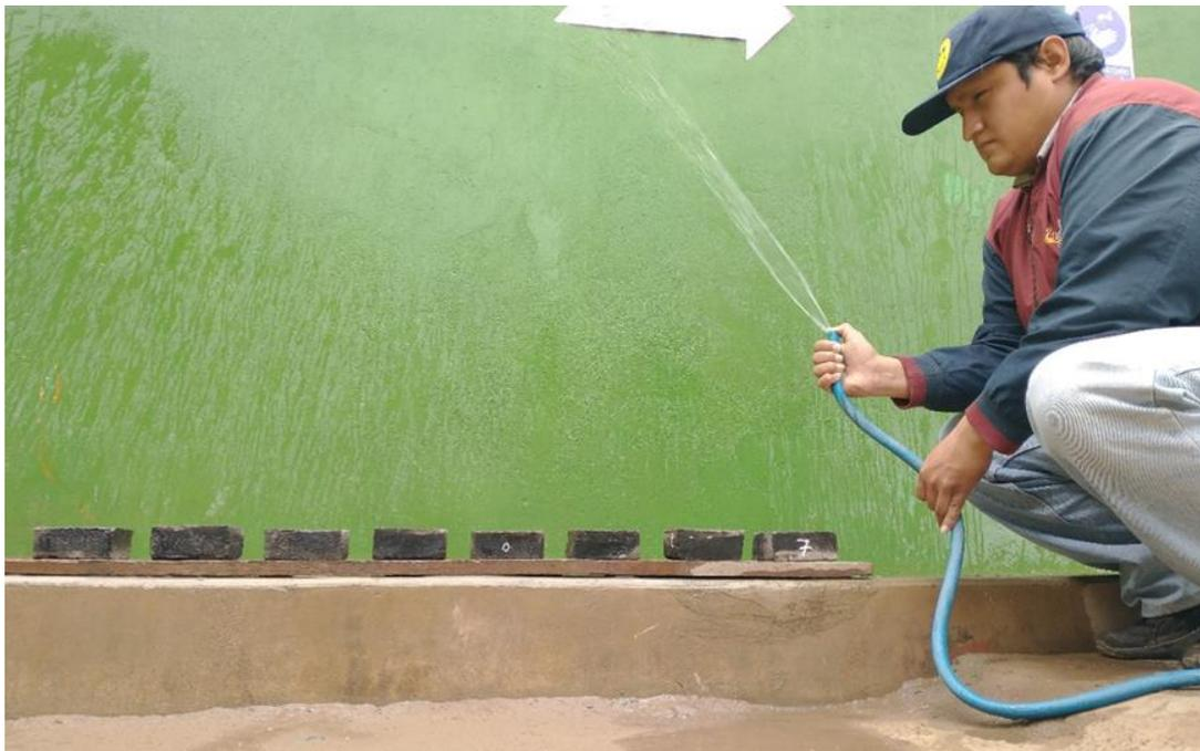
*Figura 8* Simulación de la lluvia sobre las muestras sometidas a la exposición de gases contaminantes.
