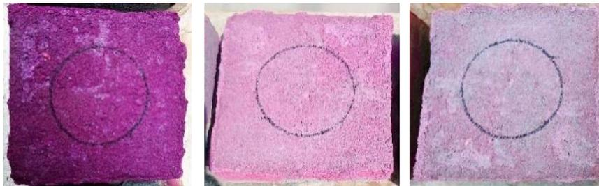
*Figura 4* Prueba de rodamina B - muestra 4 (M-4), 0h, 4h y 26hr. Fuente: Elaboración propia
