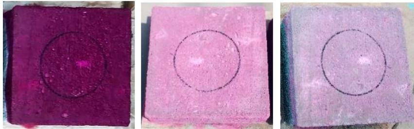
*Figura 3* Prueba de rodamina B - muestra 0 (M-0), 0h, 4h y 26hr. Fuente: Elaboración propia
