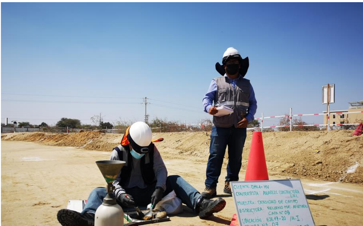
Figura 13. Ensayos de densidad en campo por el método de cono de arena.
