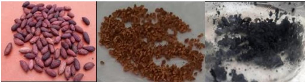
Hueso de aceituna (Izquierda), triturada y seca antes de utilizar ácido fosfórico (centro), hueso de aceituna después de aplicar ácido fosfórico, carbón activado en proceso de secado (Derecha).
