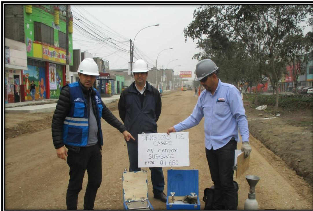
*Ilustración 19 Ensayo de densidad de campo tramo 1. Fuente propia*
