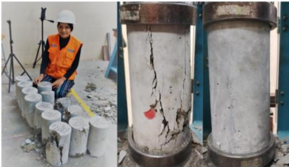
Fotografía 12. Ensayo de probetas cilíndricas a compresión.
