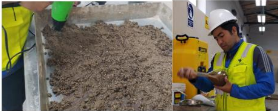
Fotografía 4. Ensayo de peso específico del agregado fino
