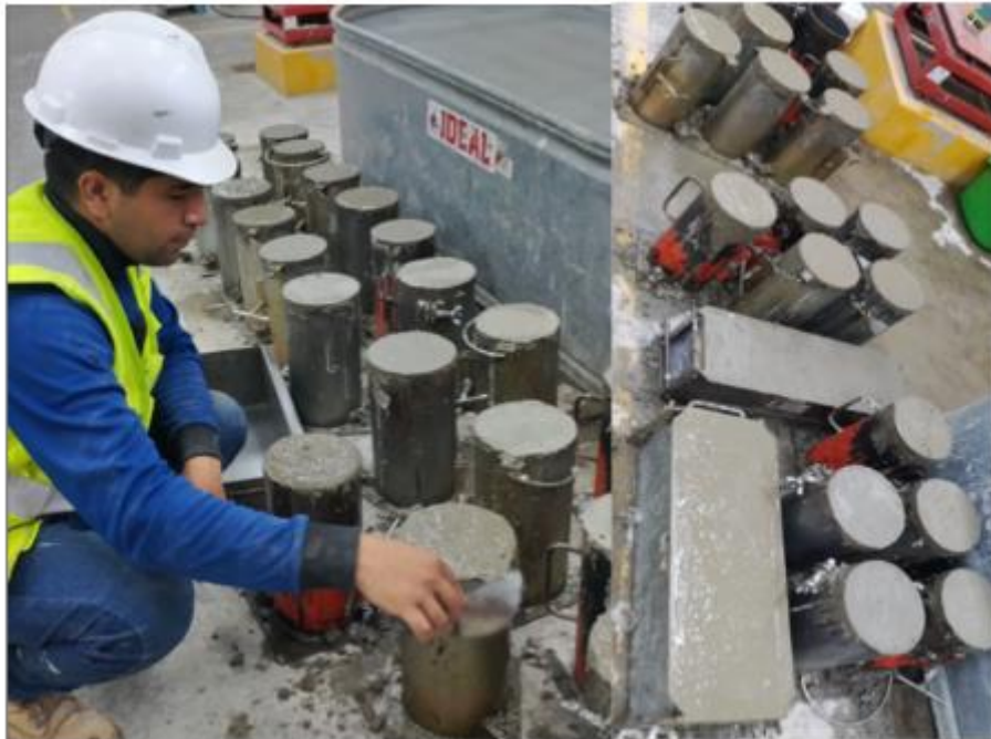
Fotografía 7. Elaboración de probetas cilíndricas y vigas de concreto.
