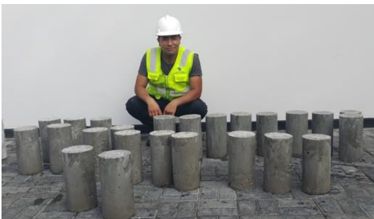
Fotografía 10. Muestras elaboradas para ensayo a compresión.
