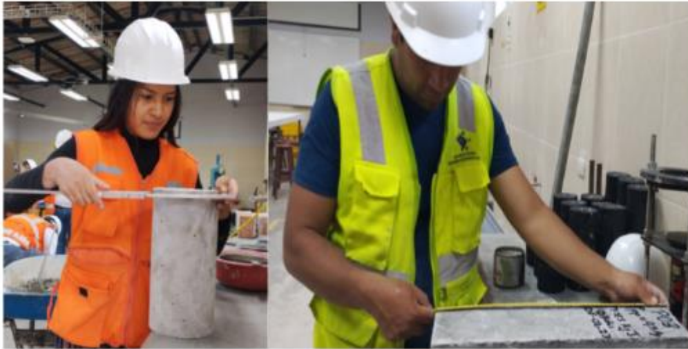
Fotografía 11. Medición de las probetas cilíndricas y vigas a ensayar.
