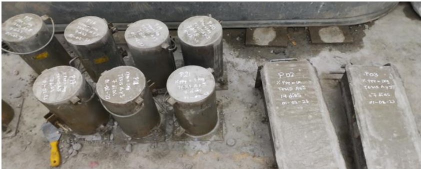
Fotografía 8. Desmolde e identificación de muestras.
