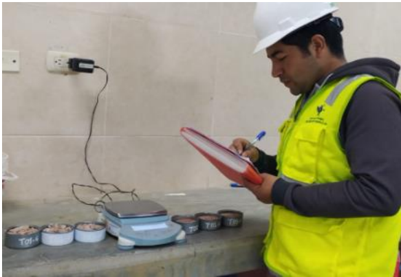
Fotografía 2. Ensayo de contenido de humedad de los agregados
