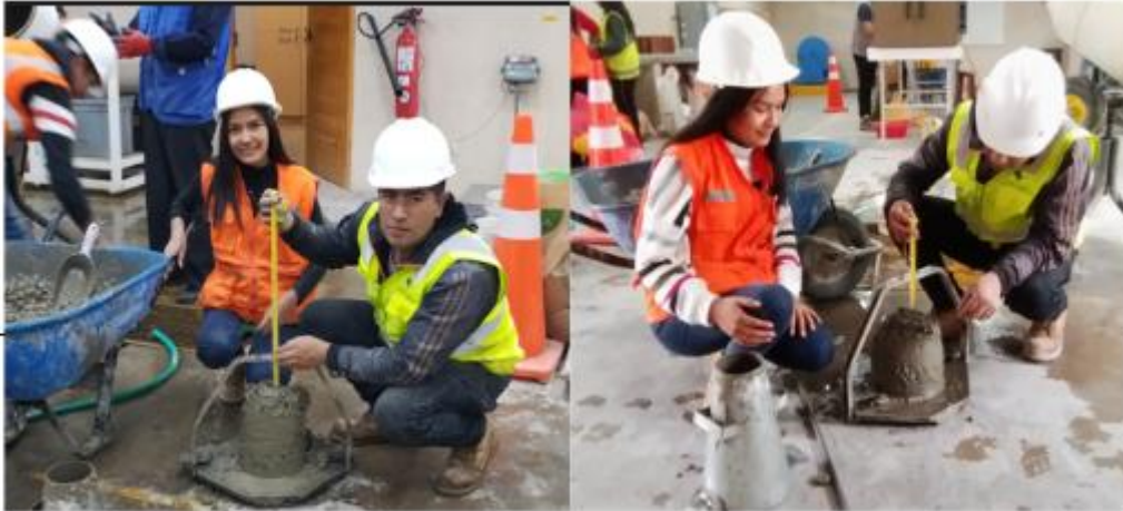
Fotografía 6. Ensayo de asentamiento del concreto (SLUMP)
