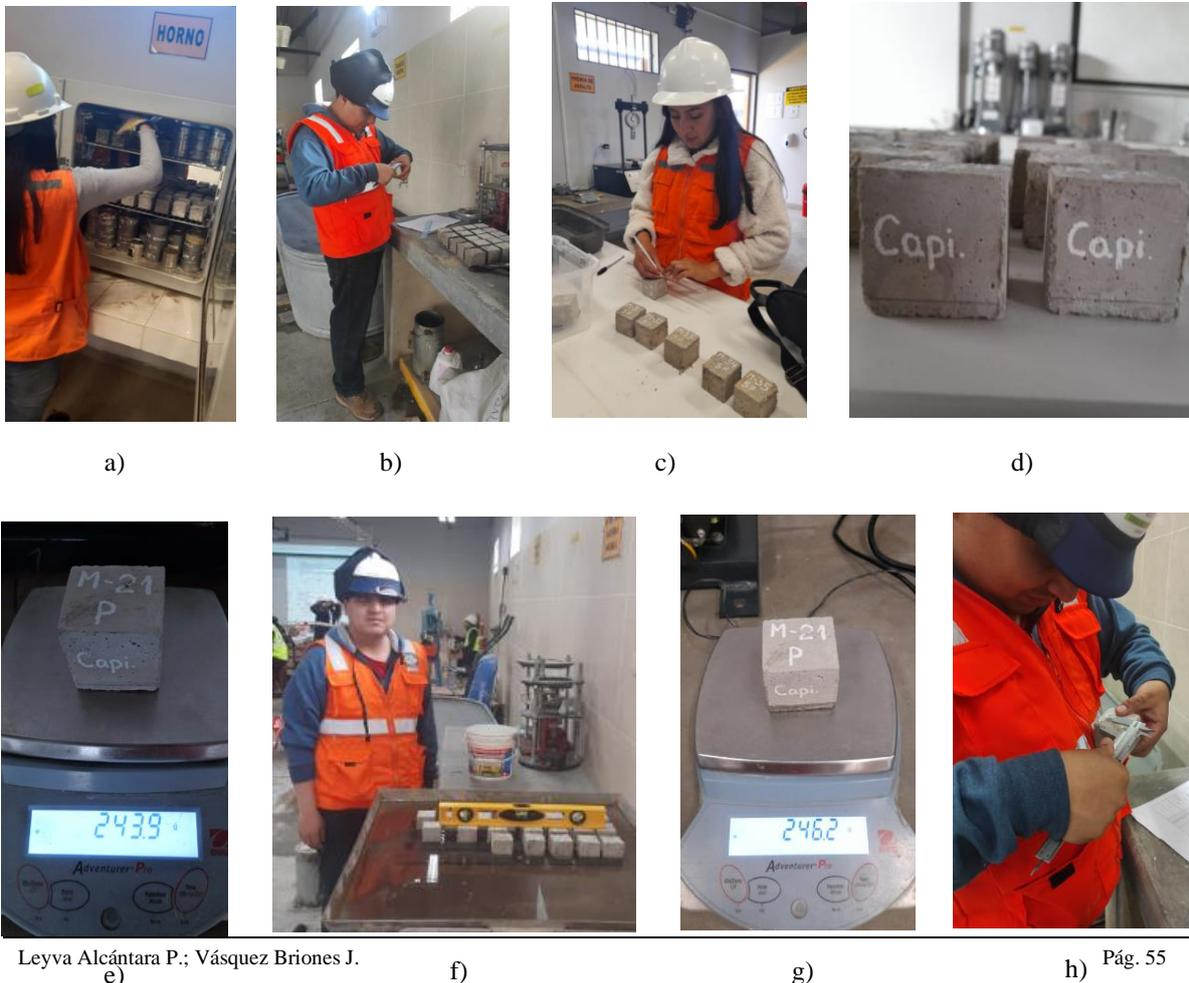
**Nota:** a) Sacar los morteros del horno, b) Medir con el vernier las caras del mortero, c) Trazar 1 cm de la base, d) Se muestra el trazo de 1 cm, e) Pesar el mortero seco, f) Colocar en la bandeja las cuñas, luego colocar los morteros y finalmente colocar agua hasta la línea de 1cm, g) Pasada las 3 horas, sacar y pesar el mortero, h) Medir la altura del fleco. **Fuente:** Elaboración Propia
