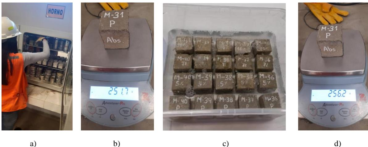
**Nota:** a) Pasadas las 24 horas se saca del horno las muestras, b) Peso de la muestra en seco, c) Sumergir las muestras en agua, d) Pesar las muestras después de 10 min, 20 min, 30 min, 1 hora, 2 hora, 10 horas, 16 horas y 24 horas, para calcular la absorción de las muestras. **Fuente:** Elaboración Propia
