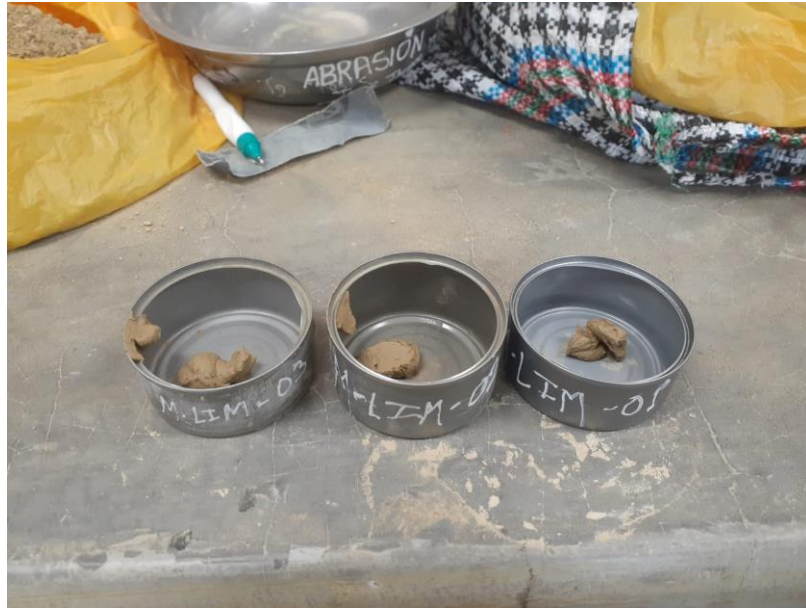
Figura 26. Porción de suelo que se ha puesto en contacto en la parte inferior de la ranura de la copa de Casagrande y colocado en taras para determinar el contenido de humedad y por consiguiente el límite Líquido.
