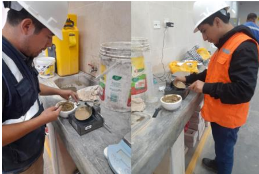
Figura 25. Preparación de muestra de suelo que pasa la malla N° 40 en la copa de Casagrande para determinar el ensayo de límite líquido.
