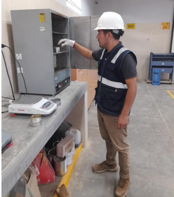
Figura 24. Secado de muestra en la estufa durante 24 horas a 105 °C para luego pesar y determinar el contenido de humedad.
