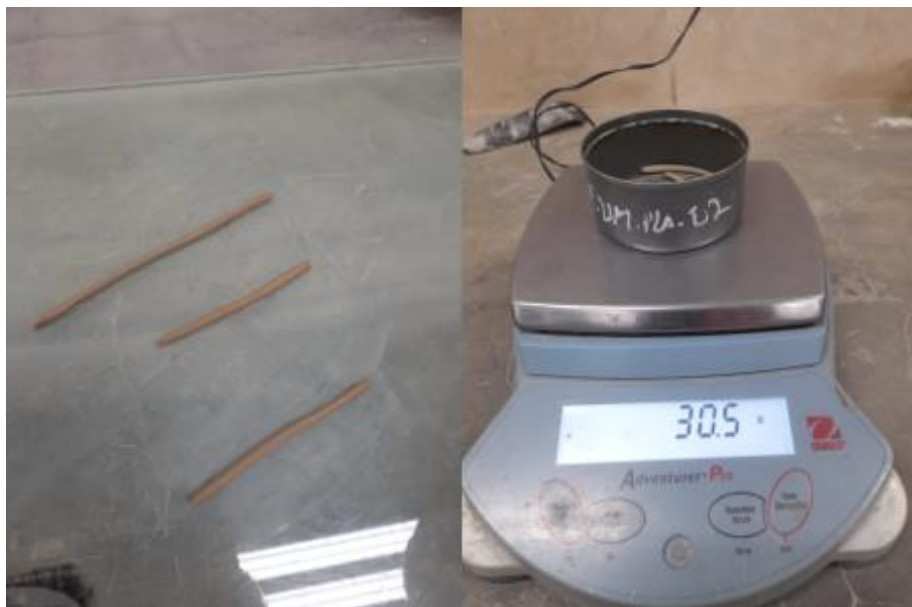
Figura 27. Cilindros de 3 mm de diámetro con presencia de agrietamientos para determinar el Ensayo de Límite Plástico.
