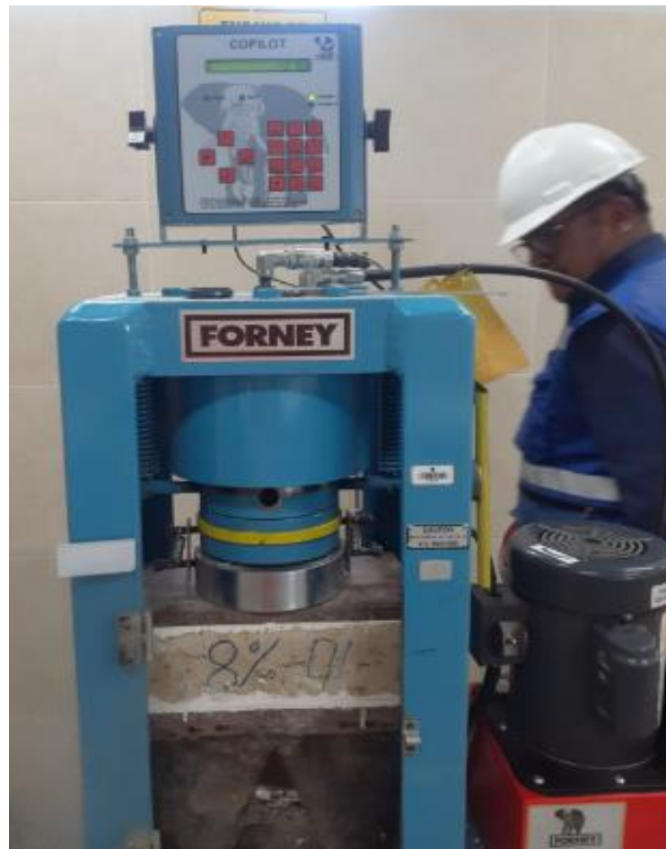
Figura 13. Ensayo de resistencia a la compresión de la unidad de adobe
