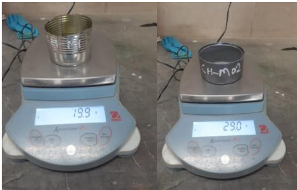
Figura 23. Peso de recipientes o taras para pesar las muestras húmedas y secas para determinar el contenido de humedad del suelo.
