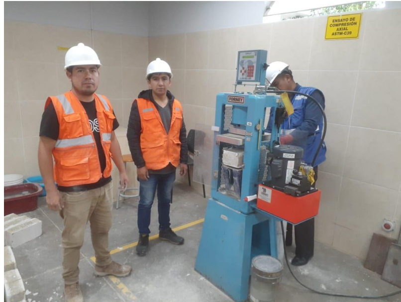
Figura 38. Ensayo de compresión y flexión de las unidades de adobe (patrón y con adición de humo de sílice en los diferentes porcentajes).
