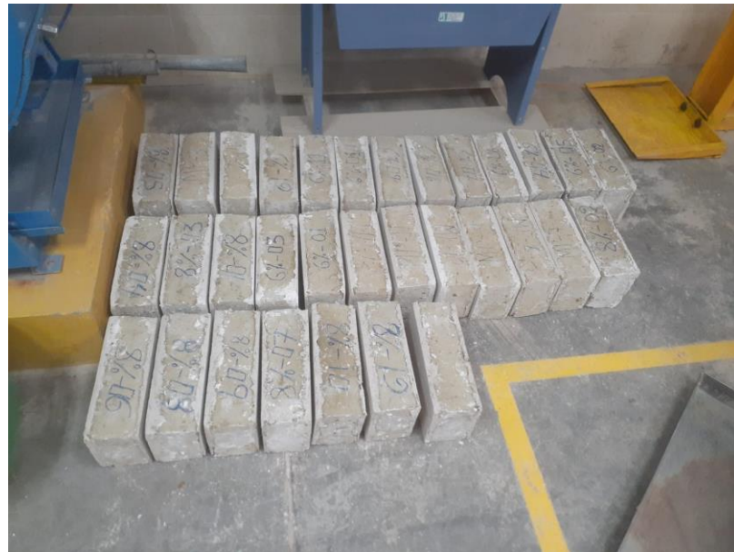
Figura 37. Unidades de adobe refractados para posterior ensayo de compresión y flexión.
