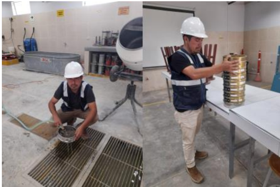
Figura 29. Elaboración de ensayo de análisis granulométrico mediante tamizado por lavado.
