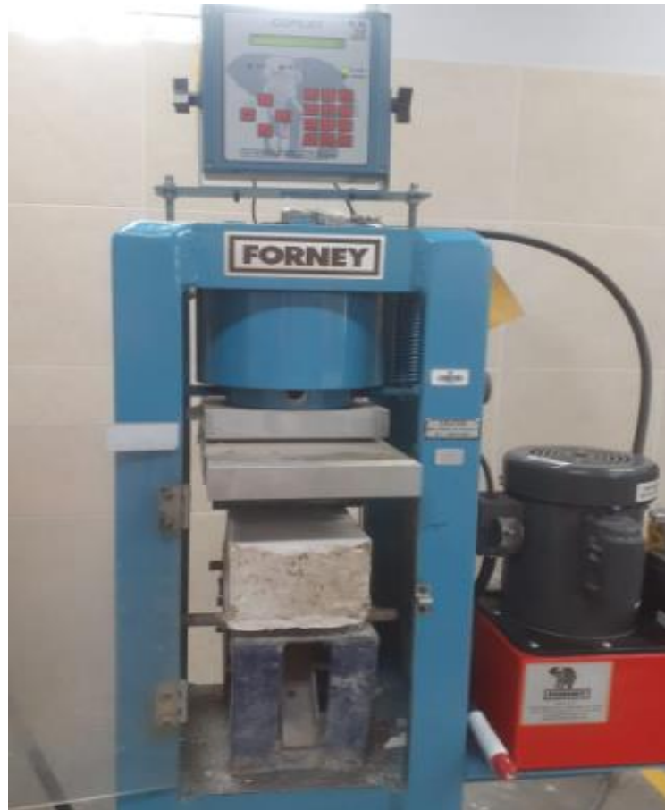
Figura 14. Ensayo de resistencia a la flexión de la unidad de adobe
