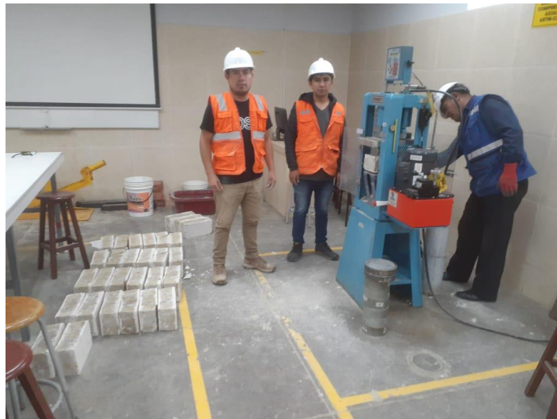
Figura 39. Ensayo de compresión y flexión de las unidades de adobe.
