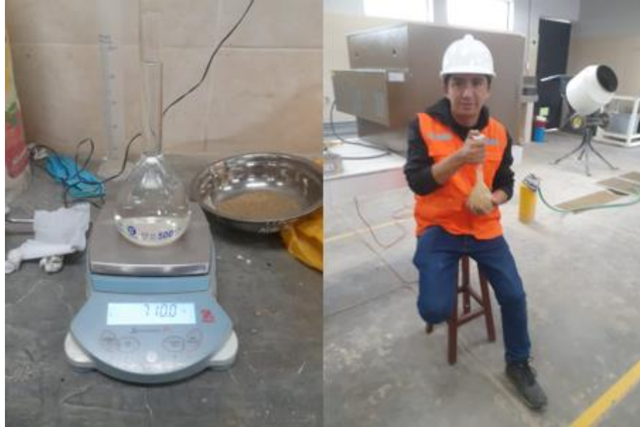
Figura 28. Elaboración de ensayo de Peso Específico de Material Fino.
