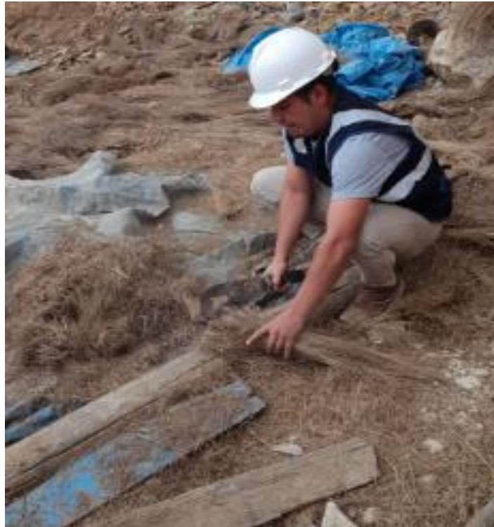
Figura 7. Habilitado de paja Ichu para adición a la composición de las muestras
