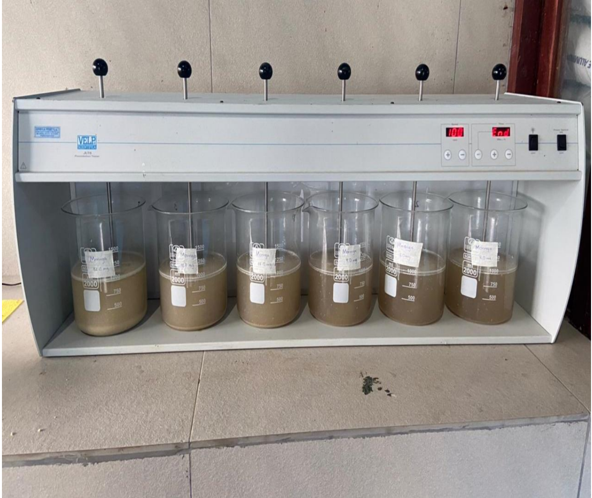
Figura 24: Primera vuelta de ensayo de jarras
