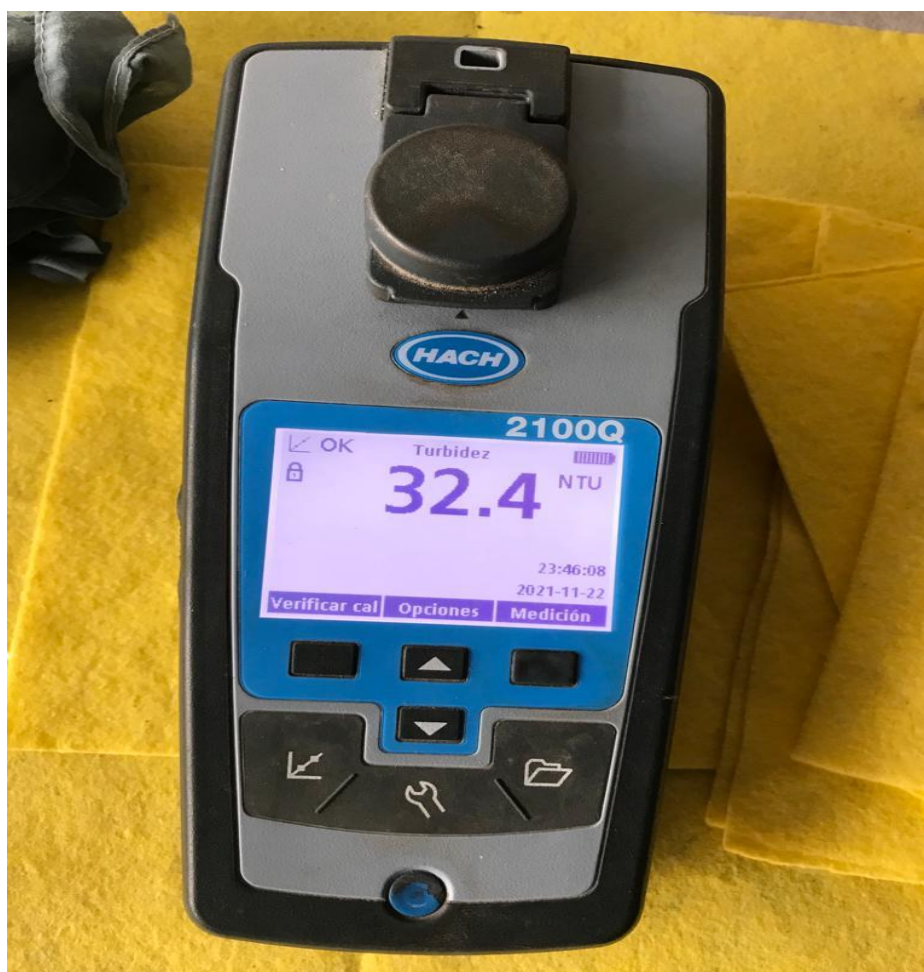
Figura 22: Toma de resultados del Turbidímetro de la Planta de Tratamiento de Agua Potable del distrito San Nicolás
