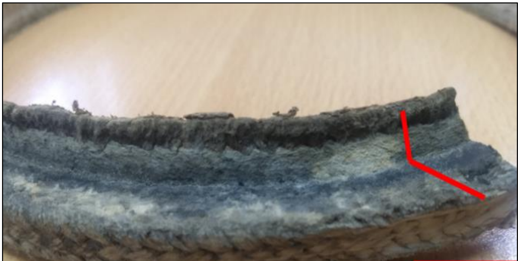
Figura 5: Desgaste de estopa al cumplir las 720 horas.
