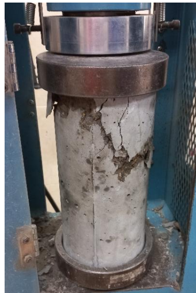
Ensayo para medir resistencia a compresión de probetas
