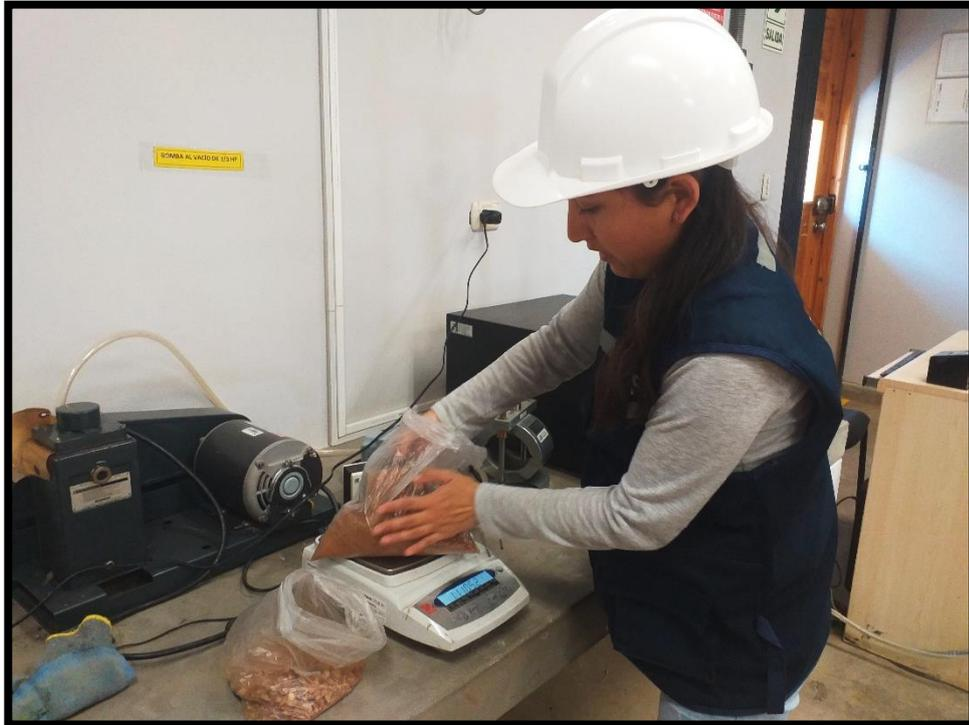
Fotografía N° 10: Pesando los materiales para el ensayo de Proctor Modificado.
