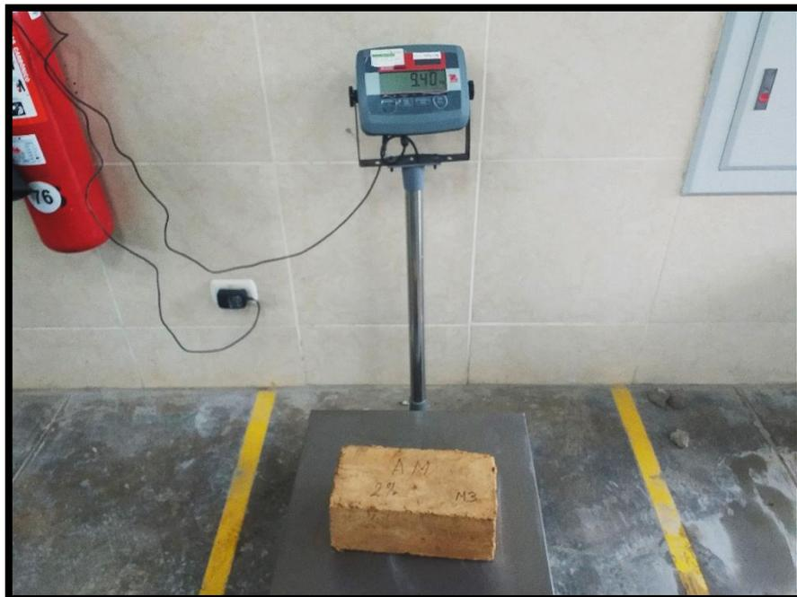
Fotografía N° 21: Pesando la unidad de adobe compactado para el grado de absorción.
