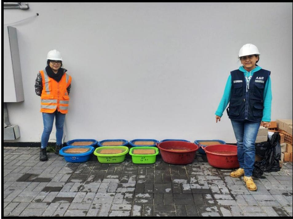
Fotografía N° 22: Adobe compactado sumergido en la tina con agua.
