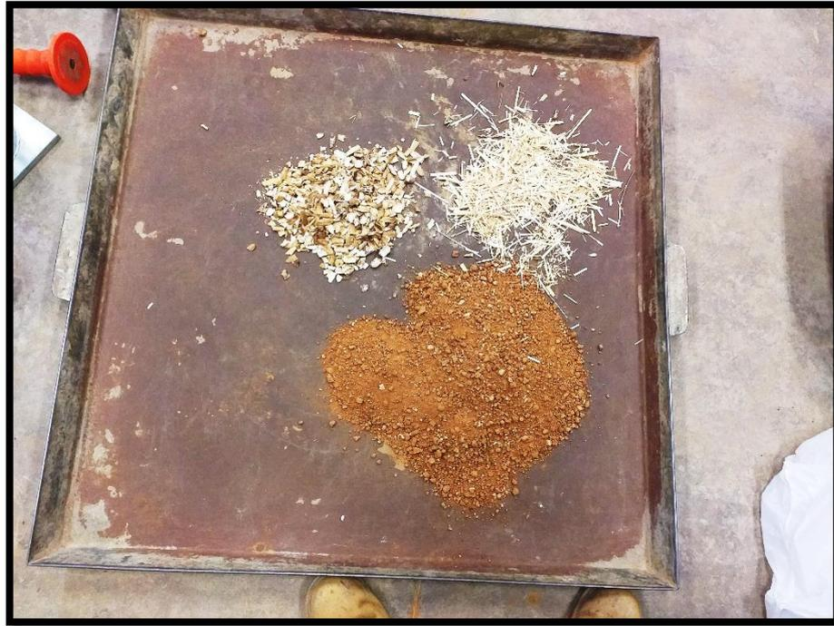
Fotografía N° 11: Distribución de los distintos materiales utilizados para el Proctor Modificado.
