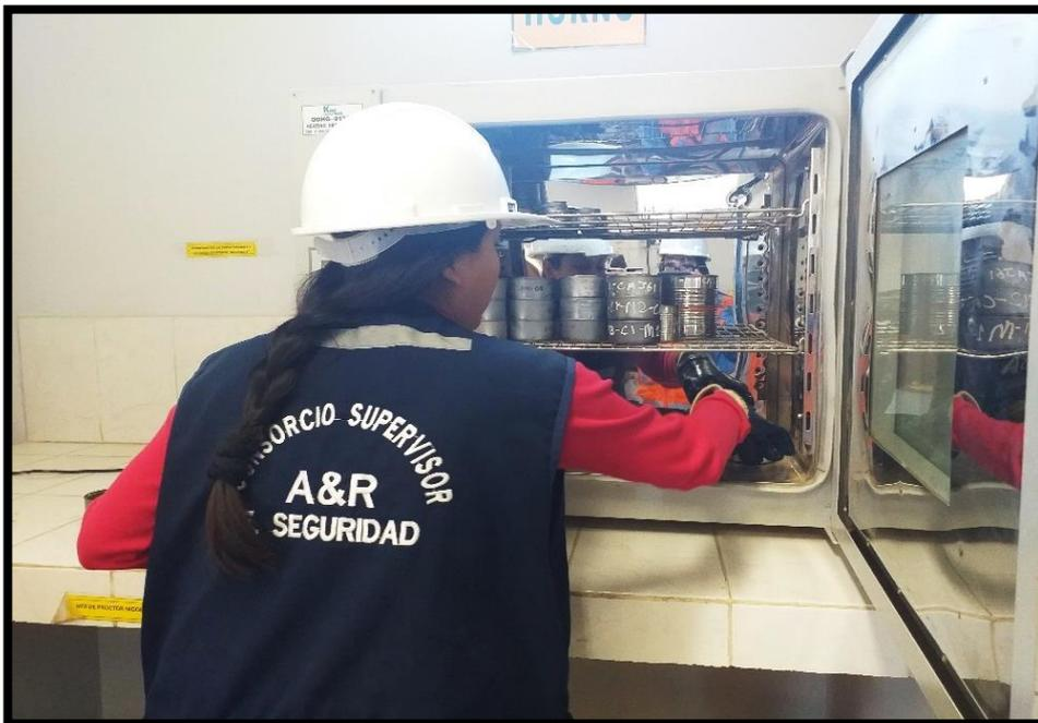
Fotografía N° 04: Colocación de tara en el horno a 105 °C por 24 horas, para el contenido de humedad.
