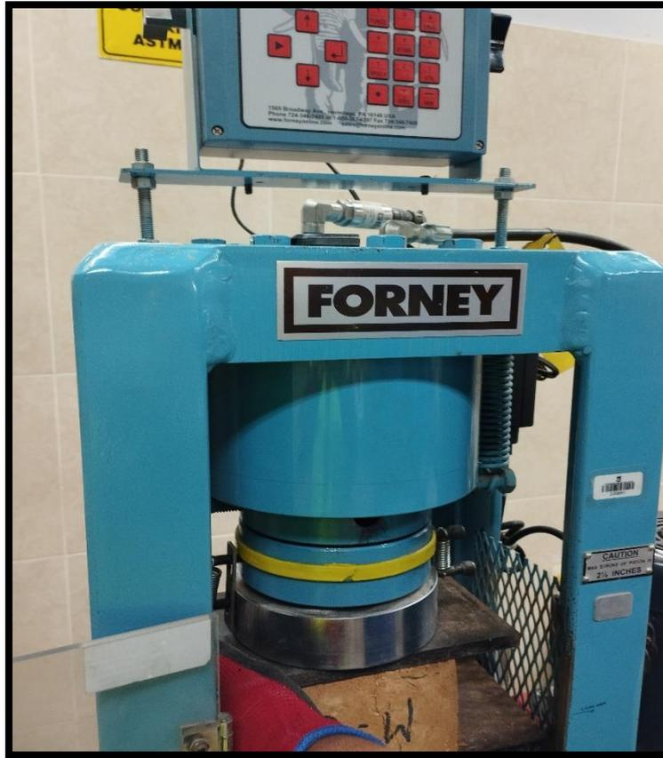
Fotografía N° 20: Realización del ensayo a Compresión.
