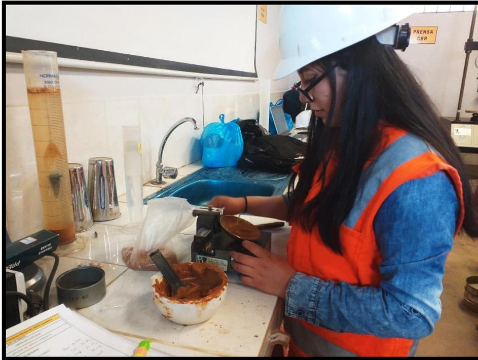
Fotografía N° 07: Realización del ensayo de Límite Líquido con la copa de casagrande.
