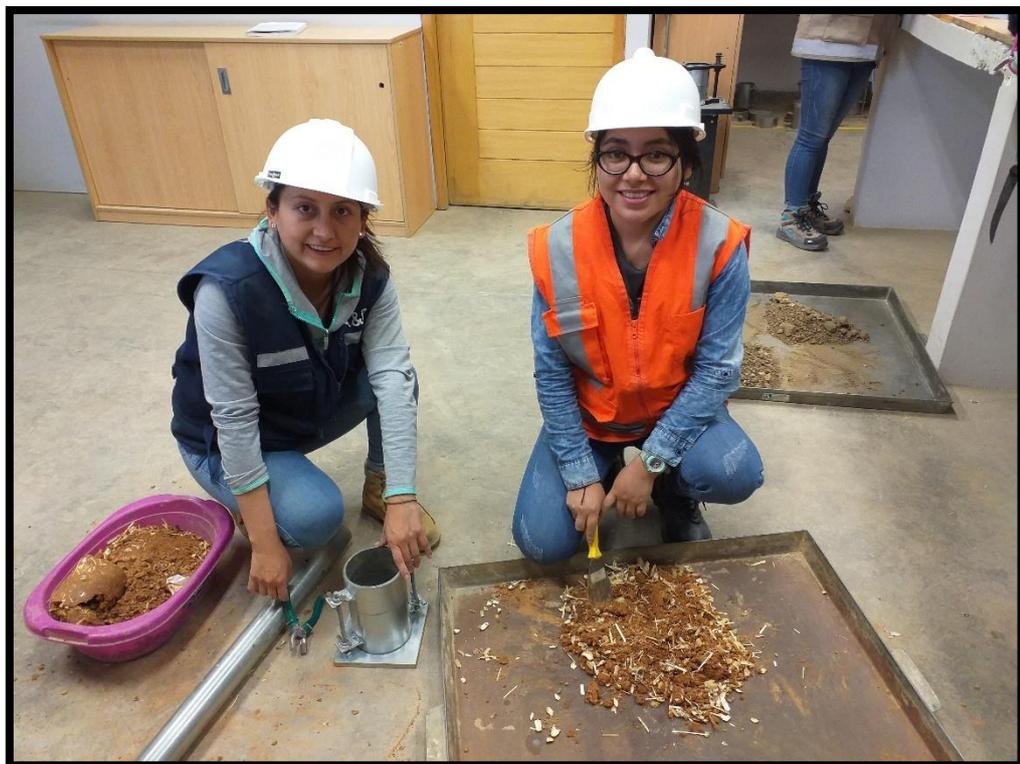
Fotografía N° 12: Mezclando el suelo con la paja y la cáscara de maní para la realización del Proctor Modificado.
