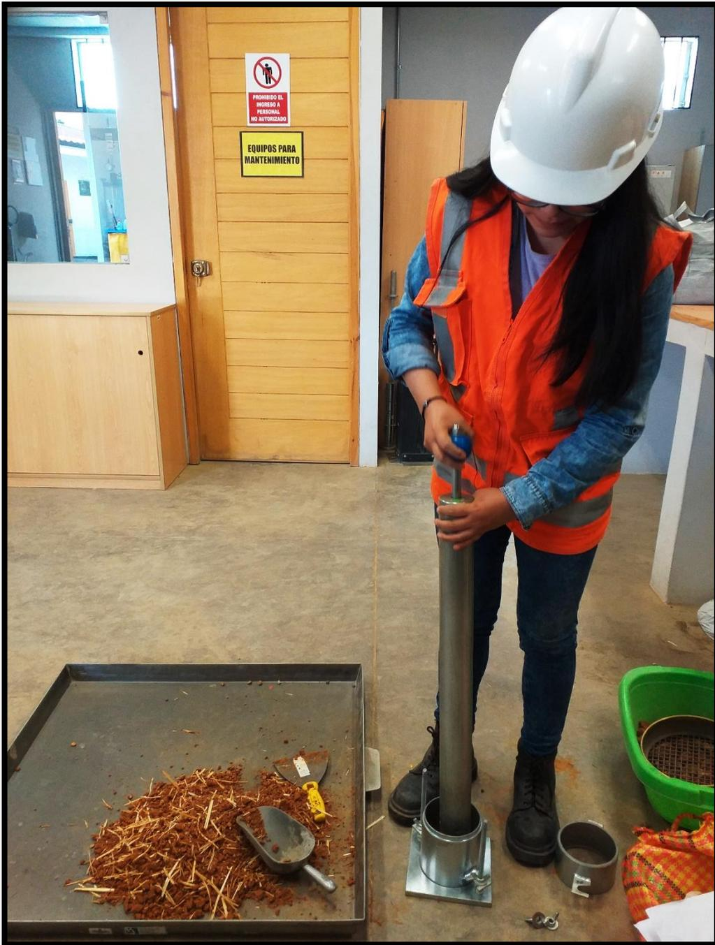
Fotografía N° 13: Realización del ensayo de Proctor Modificado.
