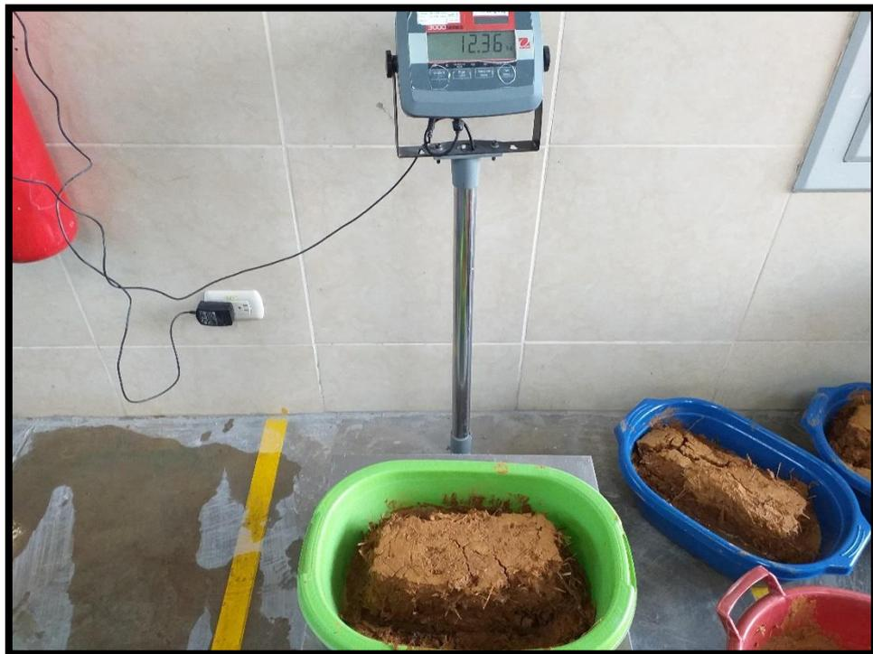
Fotografía N° 23: Peso del adobe compactado luego de sumergido en agua por 24 horas.
