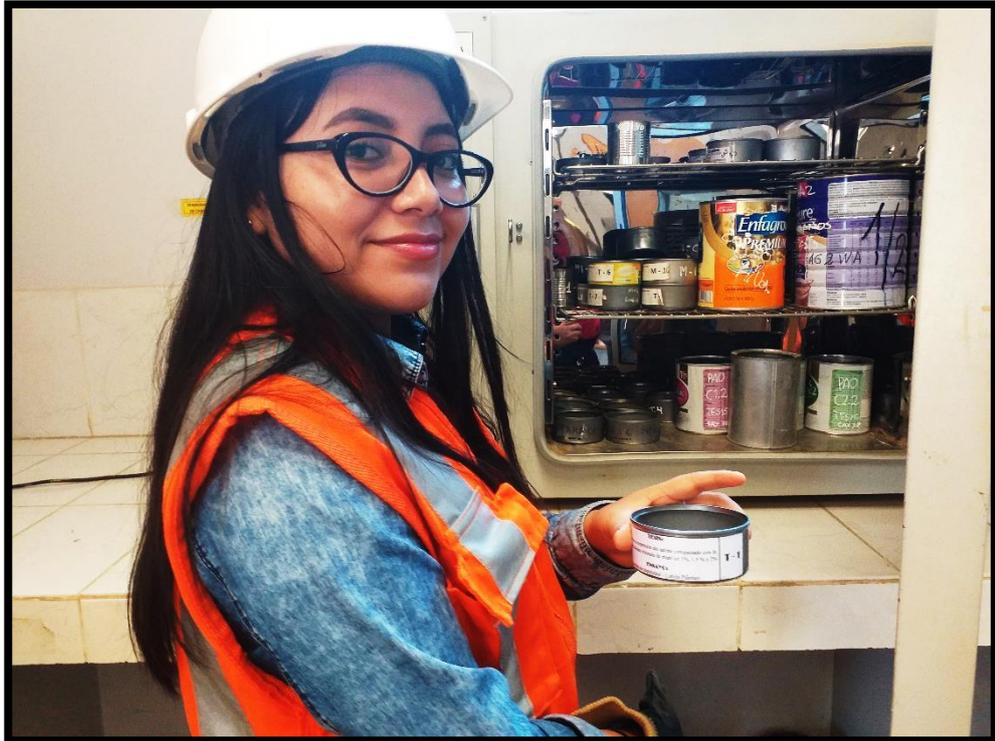
Fotografía N° 09: Colocación de las muestras de Limite Plástico al horno por 24 horas.
