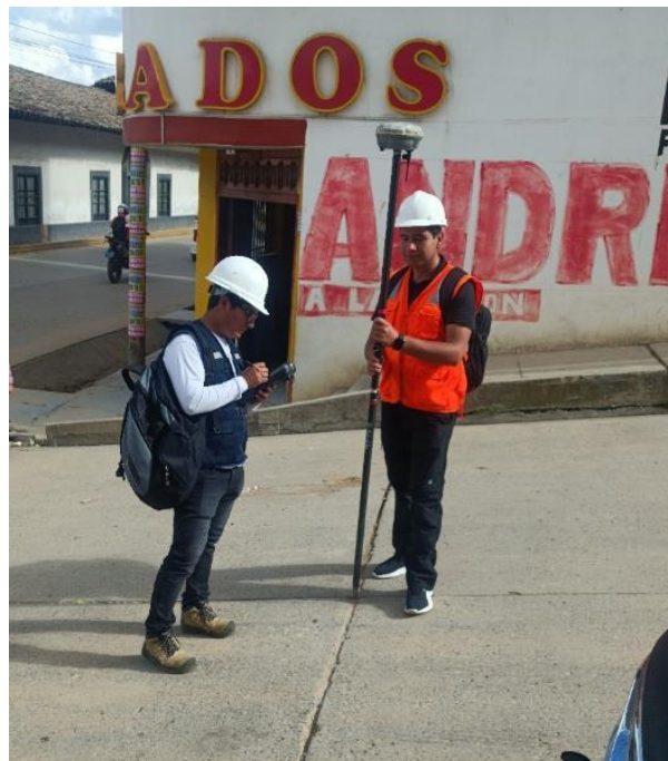
Toma de Punto de Control con GPS Diferencial en la Calle el Canal.
