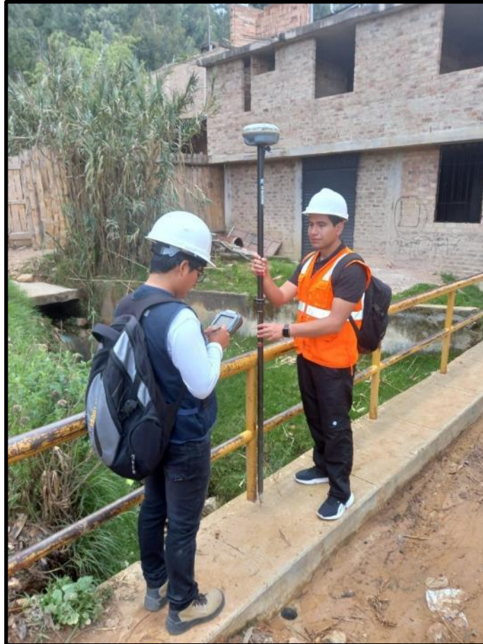
Toma de Punto de Control con GPS Diferencial en el Pasaje El Edén.
