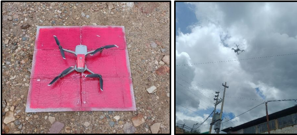
Dron utilizado en el Levantamiento Topográfico de la Quebrada Pariapuquio; además, se muestra el despegue del Dron para empezar a tomar los puntos mediante Fotografías Aéreas
