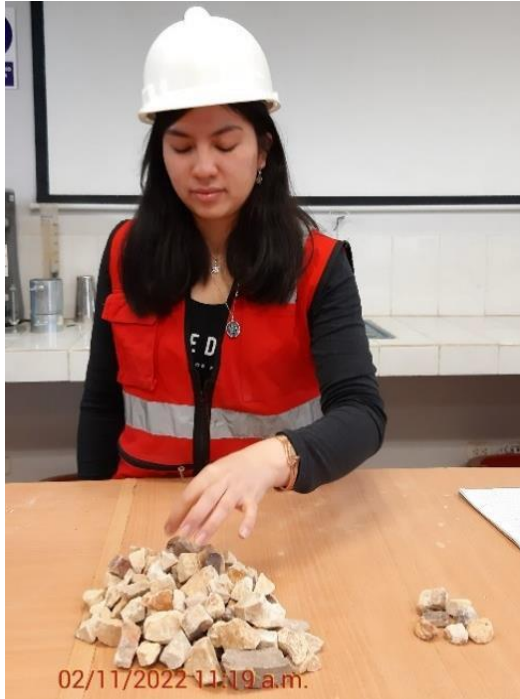
Fotografía N° 19: Ensayo de caras fracturadas del afirmado.
