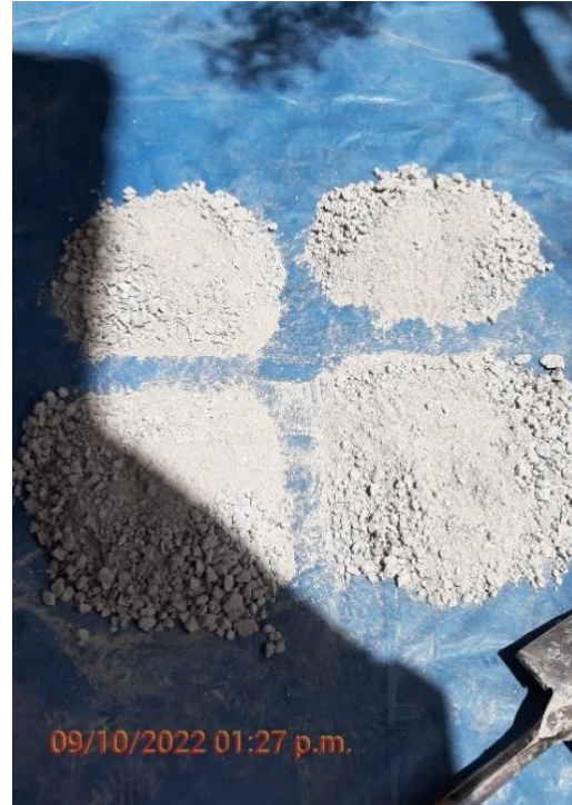
Fotografía N° 6: Cuarteo del material para los ensayos de laboratorio.
