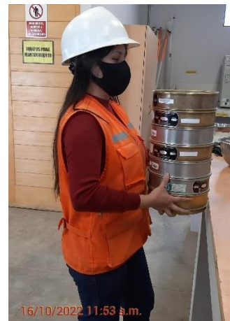
Fotografía N° 16: Ensayo de granulometría mediante tamizado en seco del agregado combinado.
