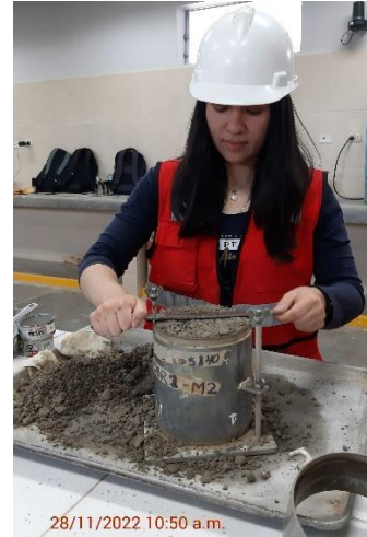
Fotografía N° 24: Ejecución del ensayo de CBR del agregado reciclado.
