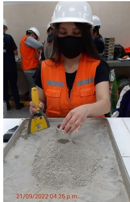
Fotografía N° 12: Ejecución del ensayo de equivalente de arena del agregado reciclado.
