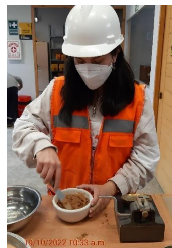
Fotografía N° 18: Ensayo de límites de Atterberg del afirmado.
