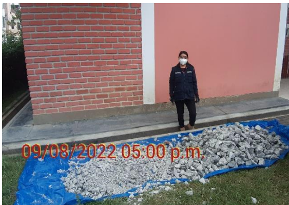
Fotografía N° 3: Trituración manual del material en tamaños entre 5cm y 10 cm.
