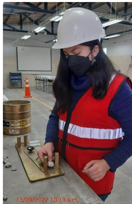
Fotografía N° 8: Ejecución del ensayo de partículas chatas y alargadas del agregado reciclado de concreto.
