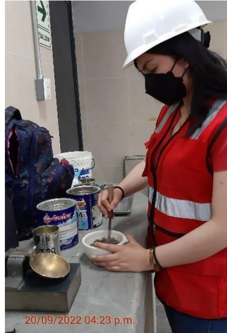
Fotografía N° 10: Ensayo de límites de Atterberg del agregado reciclado.
