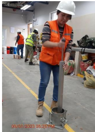
Fotografía N° 25: Ensayo de Próctor Modificado del afirmado.
