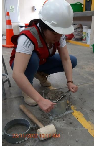
Fotografía N° 23: Ensayo de Próctor Modificado del agregado reciclado.
