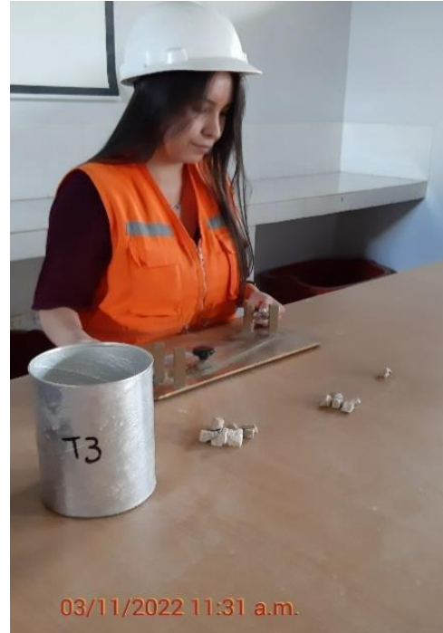
Fotografía N° 20: Ensayo de partículas chatas y alargadas del afirmado.
