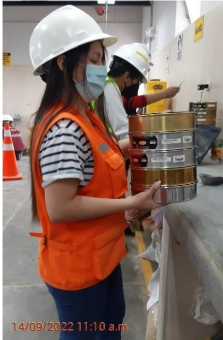
Fotografía N° 9: Ensayo de granulometría mediante tamizado en seco del afirmado.
