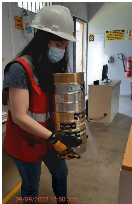
Fotografía N° 7: Ejecución del ensayo de granulometría del agregado reciclado de concreto.
