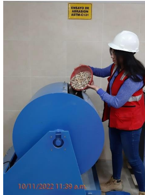
Fotografía N° 22: Ejecución del ensayo de abrasión del afirmado.
