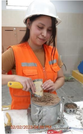
Fotografía N° 29: Ensayo de Próctor Modificado del agregado combinado.
