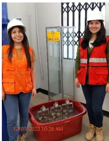
Fotografía N° 27: Toma de lectura del ensayo de hinchamiento del afirmado.
