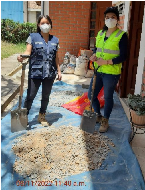
Fotografía N° 21: Preparación de la muestra del agregado combinado para la ejecución de ensayos.
