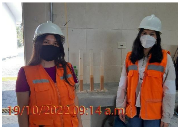
Fotografía N° 17: Ejecución del ensayo de equivalente de arena del afirmado.
