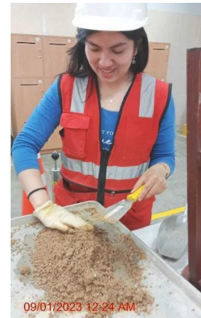
Fotografía N° 26: Ensayo de CBR del afirmado.
