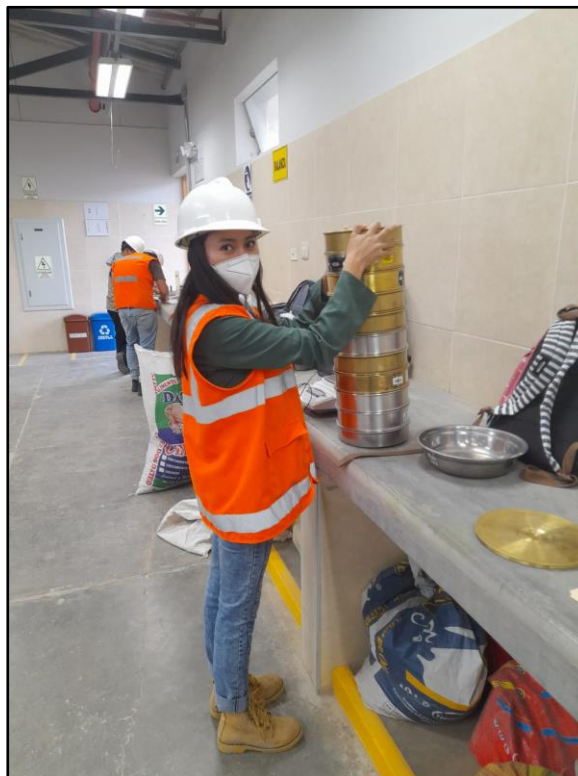
Figura 9. Realizando tamizado para el ensayo de granulometría por lavado
