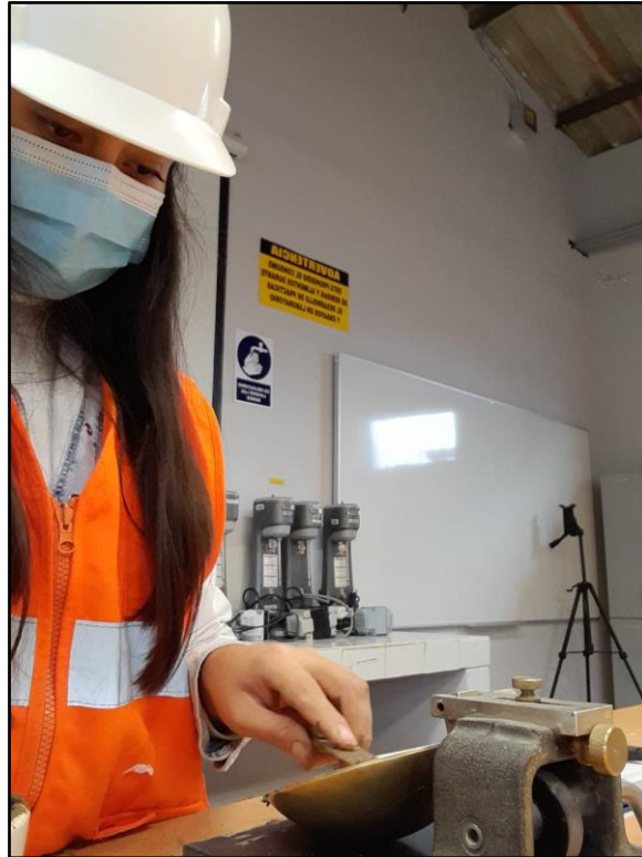
Figura 10. Realizando ensayo de Límites de Atterberg (índice de plasticidad)
