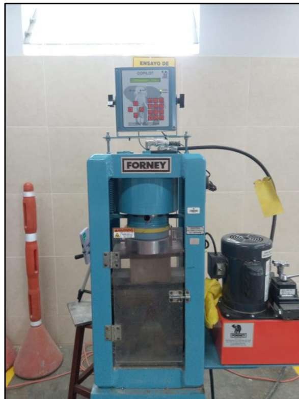
Figura 19. Realizando ensayos de compresión a los adobes
