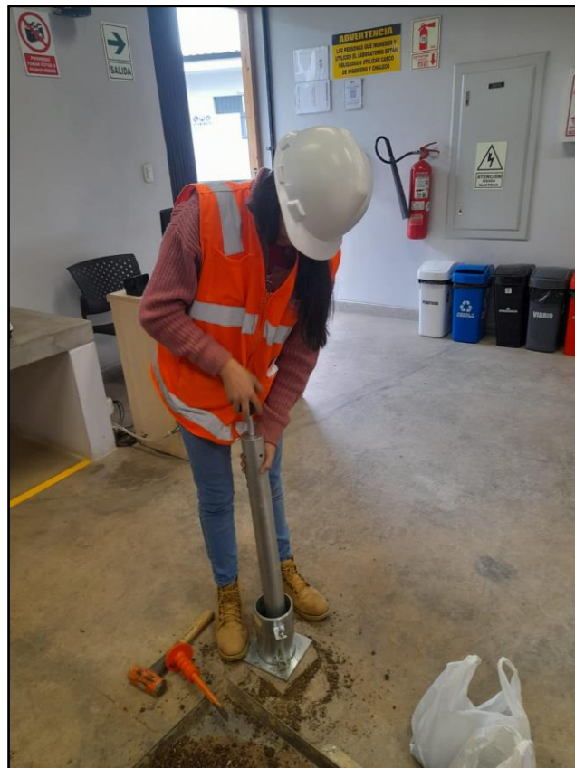
Figura 13. Realizando ensayo de Proctor Modificado
