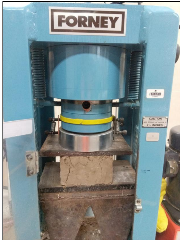
Figura 20. Ensayos de compresión a las 60 unidades de adobe
