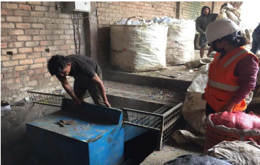
Figura 8 Triturado del material PVC reciclado
