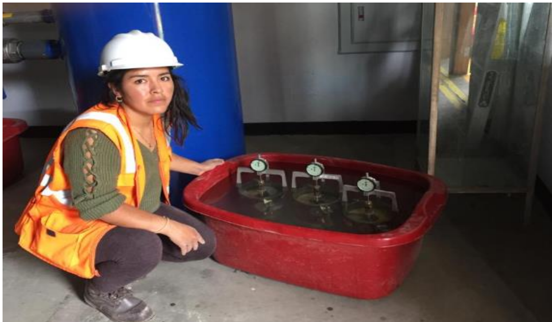
Figura 23 Ensayo para determinar el esponjamiento del material
