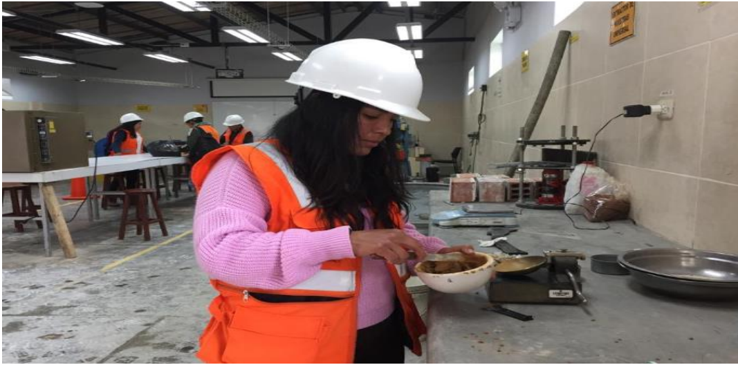
Figura 12 Lavado de material para ensayo de Abrasión los ángeles
