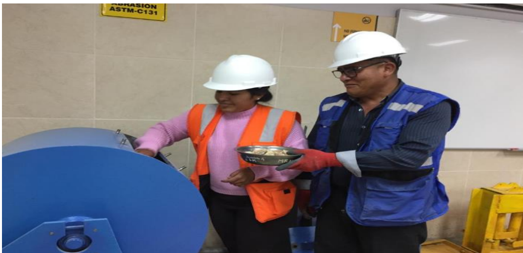
Figura 13 Colocación de material en la máquina para ensayo de Abrasión.
