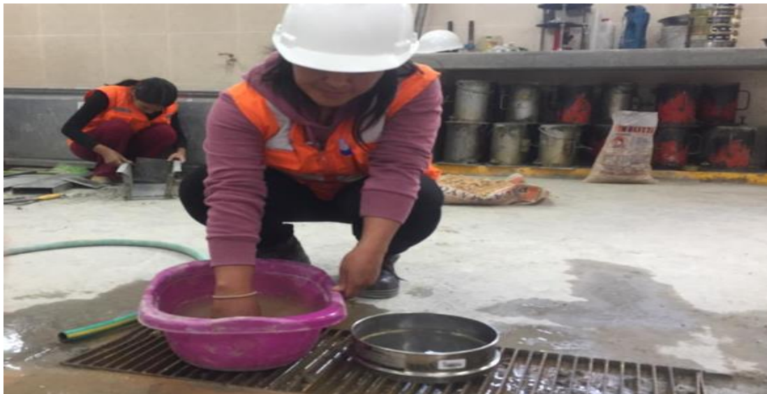
Figura 10 Lavado de material fino para granulometría por tamizado
