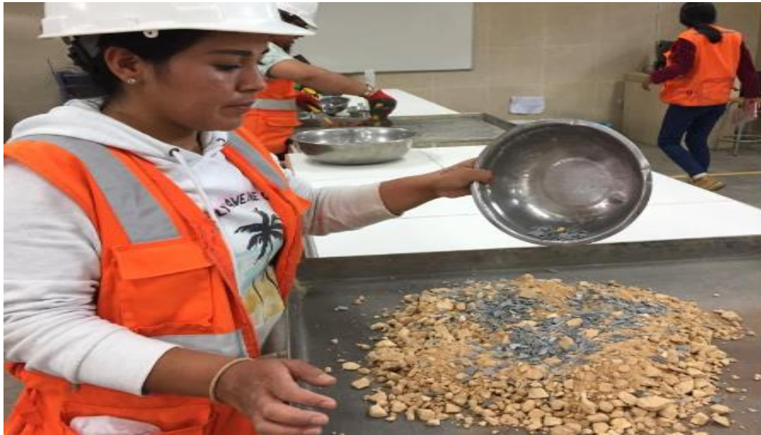
Figura 20 Adición de residuos de PVC al material natural
