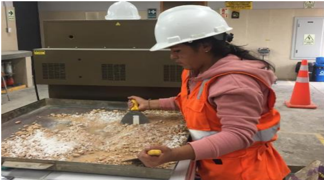
Figura 19 Adición de Cal en el material natural
