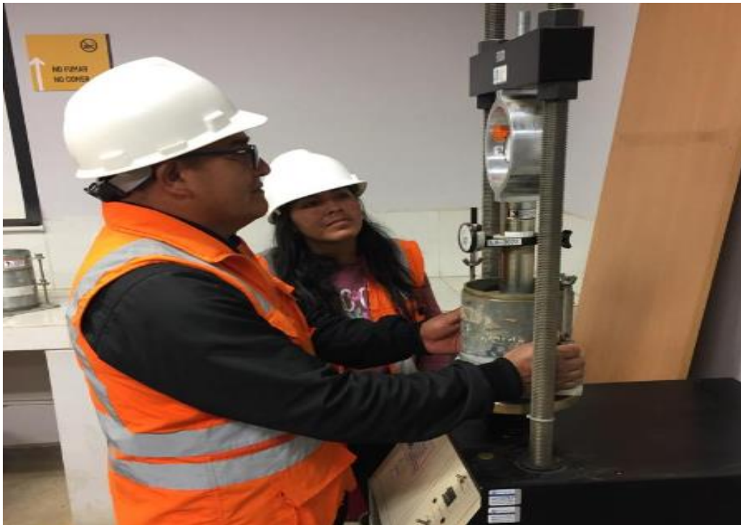
Figura 24 Ensayo de penetración
