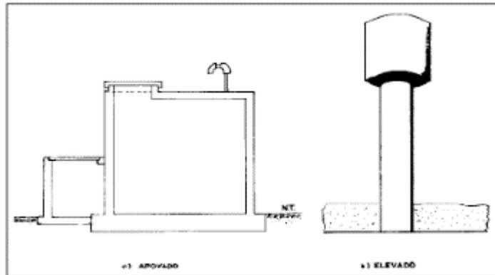
*Nota.* Se muestra los tipos de reservorios apoyado rectangular y tipo fuste. Fuente.
