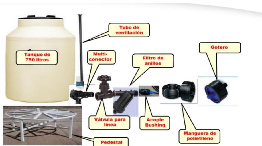
*Nota.* Se muestra el tanque de cloración, gotero, filtros de anillos, válvula de línea del sistema de cloración. Fuente. Manual de cloración por goteo PROAGUA - FPA
