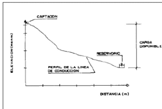
*Nota.* Se muestra la carga disponible que viene representada por la diferencia de elevación entre la obra de captación y el reservorio. Fuente. Agüero Pitman.
