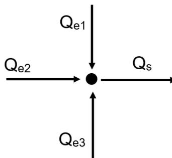
*Nota.* Se muestra el punto de evaluación en la red de tubería que tiene 3 ingresos y una salida. Fuente. Elaboración Propia.
