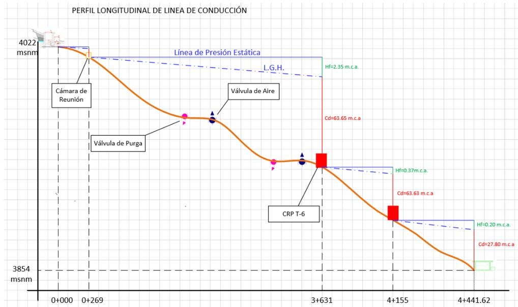
*Nota.* La figura demuestra el esquema gráfico de la red de conducción con sus componentes, así como la línea de gradiente hidráulico. Elaboración Propia.
