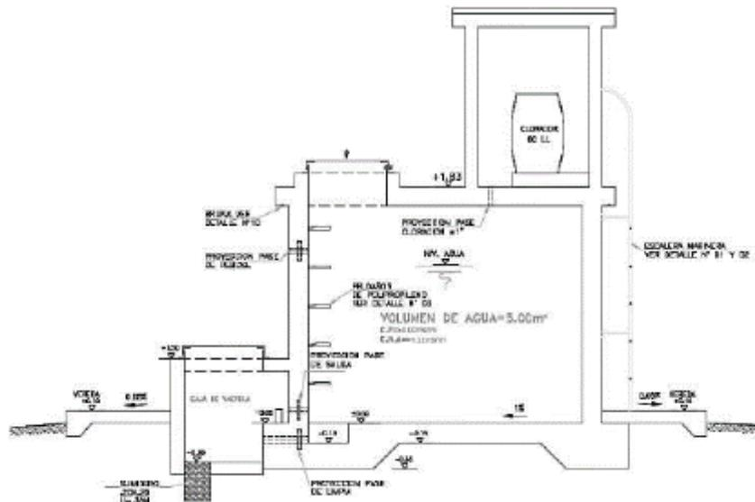
*Nota.* Se muestra el reservorio apoyado rectangular de concreto armado con sistema de cloración. Fuente. Norma Técnica de Diseño: Opciones Tecnológicas para Sistemas de Saneamiento en el Ámbito Rural
