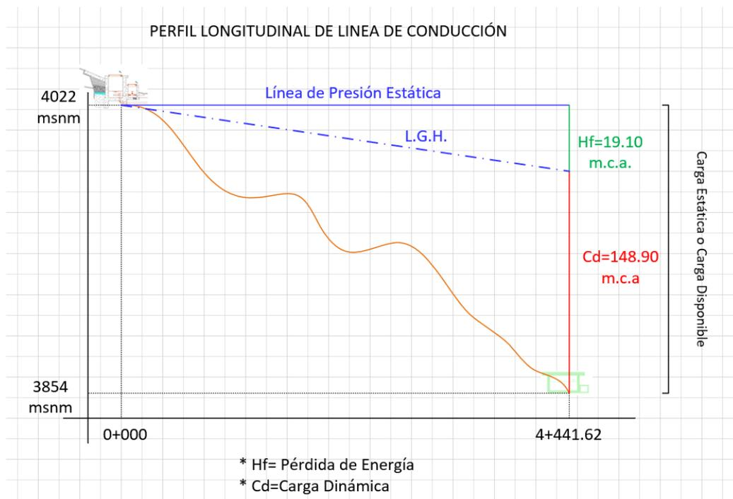
*Nota.* Se muestra el esquema gráfico de la red de conducción con la línea de gradiente hidráulico. Elaboración Propia.
