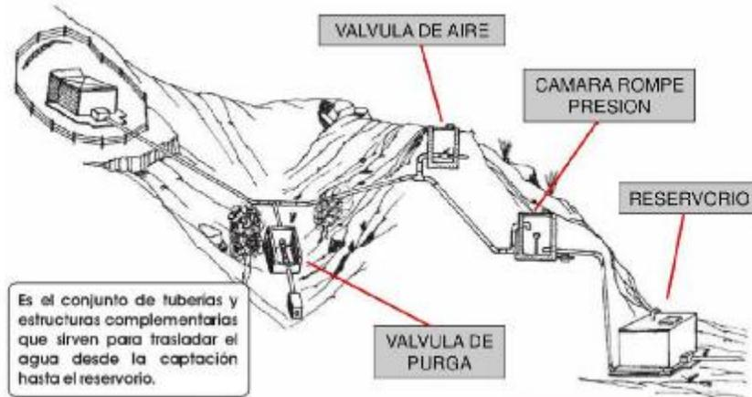
*Nota.* Se muestra los componentes hidráulicos de la línea de conducción. Fuente. Cooperación Alemana
