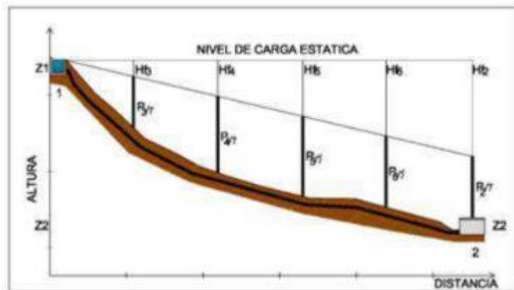
*Nota.* Se muestra la línea de gradiente hidráulica en diferentes puntos (cotas y distancias). Fuente. Norma Técnica de Diseño: Opciones Tecnológicas para Sistemas de Saneamiento en el Ámbito Rural
