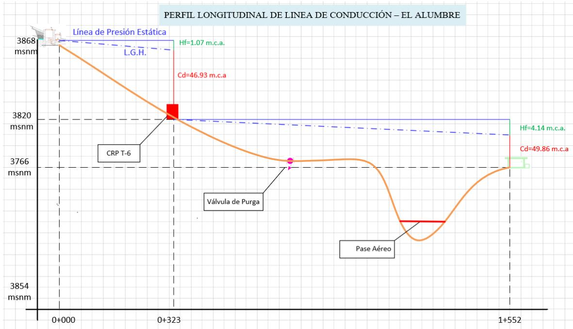
*Nota.* La figura demuestra el esquema gráfico de la red de conducción con sus componentes, así como la línea de gradiente hidráulico. Elaboración Propia.
