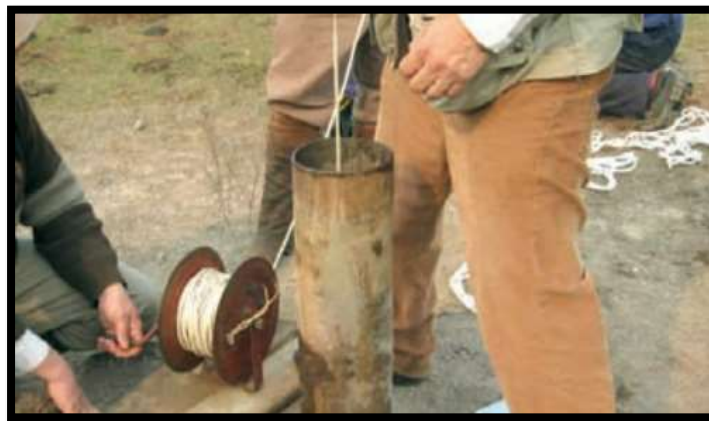
Figura 14: Medición de nivel freático y profundidad del pozo
