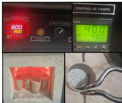
(1) Temperatura asumida para la calcinación de la cáscara de huevo  $800^{\circ}\text{C}$ ; (2) Periodo asumido para la calcinación de la cáscara de huevo (4:00 horas); (3) Crisoles con la ceniza de cáscara de huevo luego de ser sometido a 4 horas con temperatura de  $800^{\circ}\text{C}$ ; (4) Retiro del crisol de la mufla.
