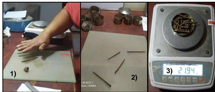
(1) Procesamiento del ensayo según el procedimiento establecido, (2) Se aprecia las muestras procesadas con un diámetro de 1/8”, (3) Acumulación de la muestra para tomar la masa.
