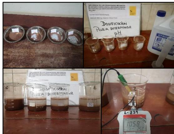
(1) Dosificación y mezcla de la muestra de suelo con el porcentaje de la ceniza de cáscara de huevo; (2) Adición de agua destilada según lo establecido por el método de ensayo; (3) Saturación de la mezcla efectuado por 24 horas; (4) Medición del valor de pH de la mezcla suelo/ceniza de cáscara de huevo.
