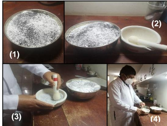
(1) Acumulación de la ceniza obtenida por la calcinación en la mufla; (2) Mortero empleado para la pulverización de la ceniza; (3) y (4) Proceso de pulverizado.
