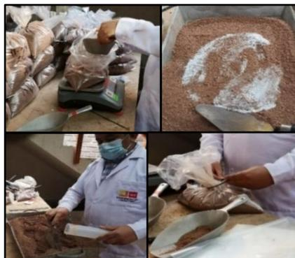
(1) Dosificación de la masa de suelo para el ensayo de Proctor modificado (2) Adición de la ceniza de cascara de huevo para el mezclado con el suelo; (3) adición de agua según el
