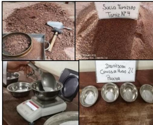
(1) Desmenuzando de la muestra mediante comba de goma (2) Muestra procesada por tamizado (N°4) (3) Dosificación de la ceniza de cascara de huevo en relación al peso de muestra preparada (4) Ceniza de cáscara de huevo para cada punto del ensayo de Proctor modificado
