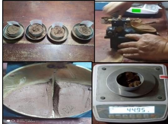
(1) Saturación de la muestra para efectuar el ensayo, (2) Ejecución del ensayo con velocidad de 2 golpes por segundo, (3) Muestra luego del ensayo, se aprecia unión de las partes separadas (4) Muestra colocada en recipiente y registro de la masa del suelo húmedo.
