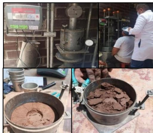
(1) Aplicación de carga mediante la prensa CBR. (2) Registro de las lecturas obtenidas para cada lectura de penetración. (3) se aprecia el espécimen luego de aplicar carga. (4) Extracción de muestra representativa para el cálculo de humedad, puede notarse que el espécimen se encuentra solido con mayor presencia de humedad que la aplicada para su compactación.
