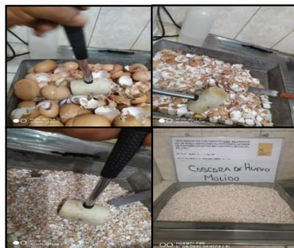
(1) Trituración de la cáscara de huevo mediante una comba de goma. (2) acomodo de partículas con espátula que permita una adecuada trituración. (3) Reducción del tamaño hasta obtener un tamaño máximo de 4.76 mm. (4) Cáscara de huevo tamizado por la malla N° 4 (4.76 mm), preparada para su calcinación.
