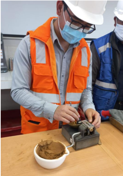
Fotografía 13. Corte de masa para obtener muestra en el ensayo de limite líquido.
