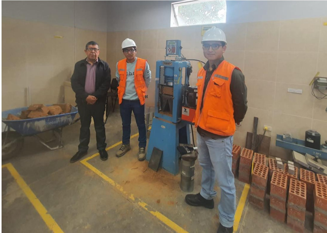
Fotografía 35. Ensayos de resistencia a la rotura de adobes compactados en presencia del asesor. Dr. Orlando Aguilar Aliaga.
