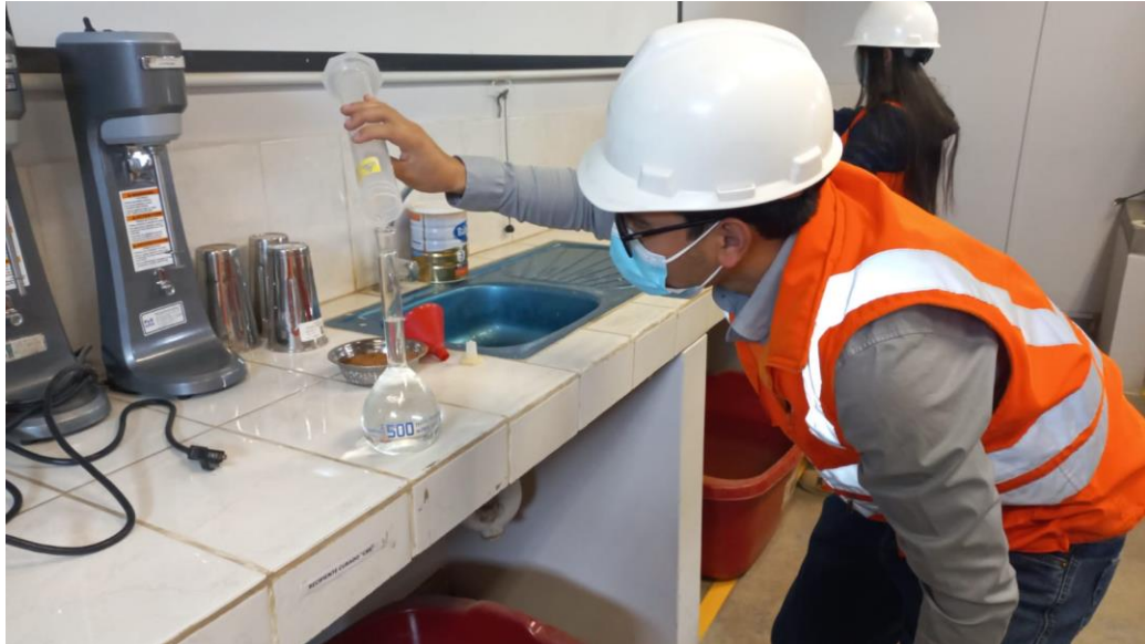
Fotografía 9. Colocación de agua a fiola para tomar lectura de peso.
