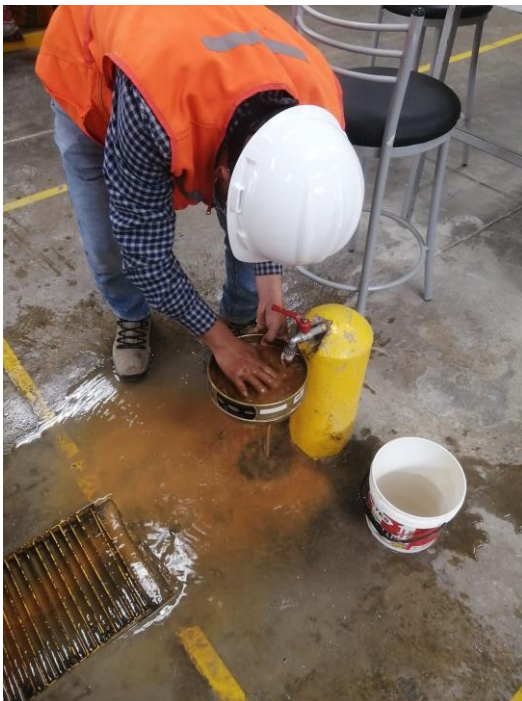
Fotografía 18. Técnica de cuarteo para dividir el material y elegir una muestra representativa y uniforme para ensayo de granulometría por lavado.
