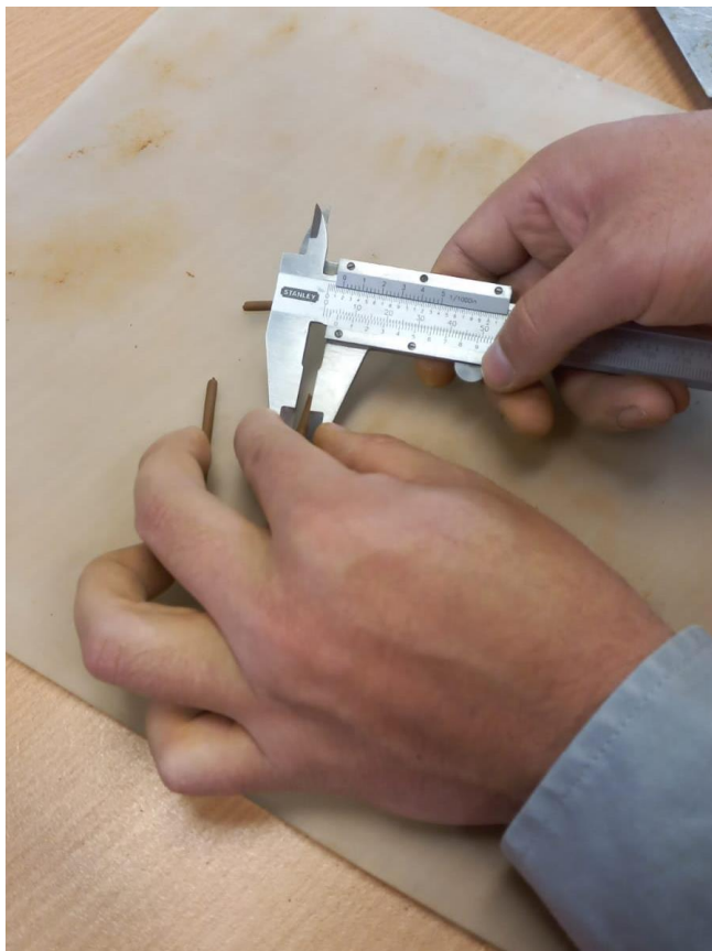
Fotografía 16. Toma de medida de material en estado plástico correspondiente a lo que indica la norma técnica de 3 mm.
