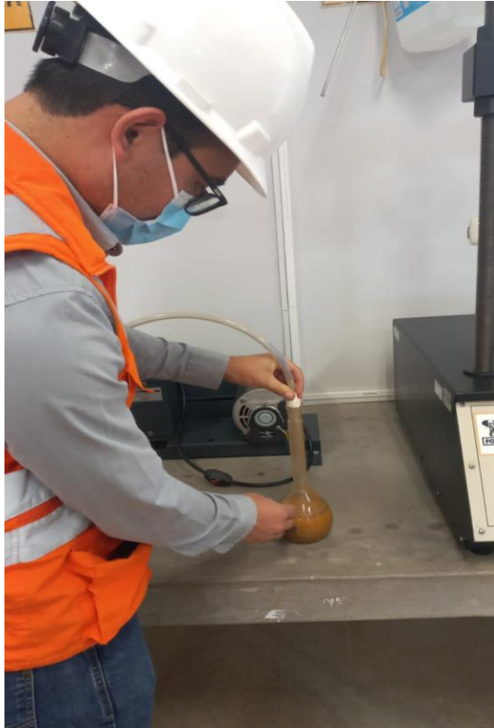
Fotografía 11. Liberación de aire con el equipo bomba de vacíos
