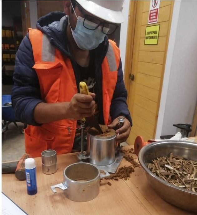
Fotografía 23. Obtención de muestra de material compactado para llevar al horno y obtener contenido de humedad.
