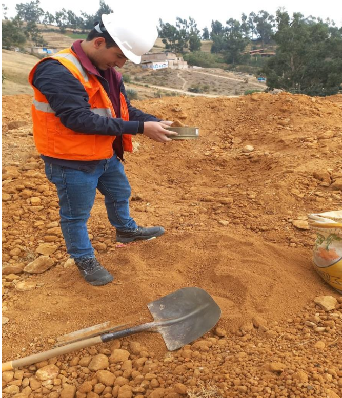
Fotografía 3. Tamizado de suelo in situ por la malla de 3/8'', para separar de gravas y tener un suelo uniforme para la elaboración de adobes
