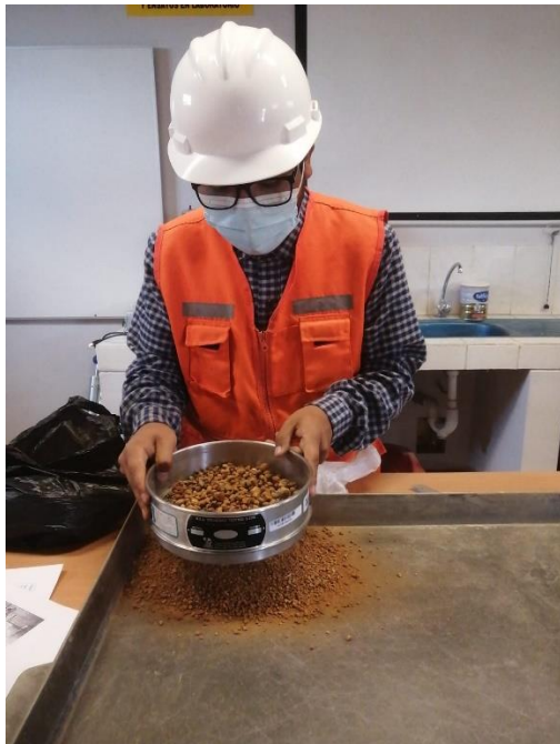
Fotografía 8. Tamizado de suelo para ensayo de peso específico.
