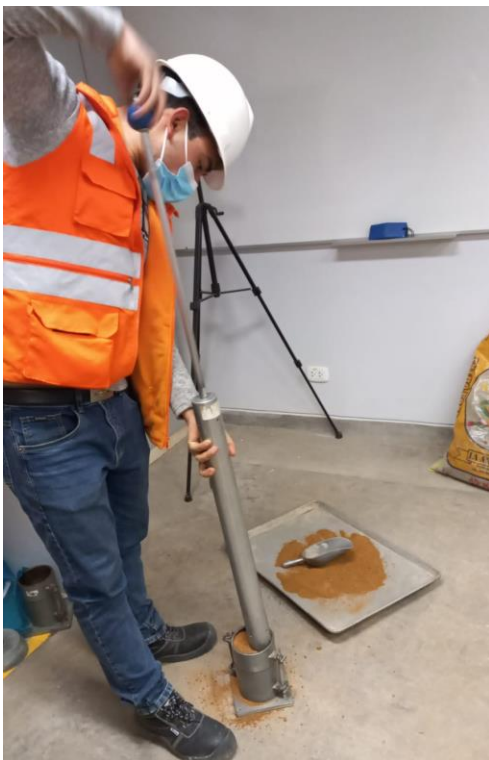
Fotografía 22. Compactación de suelo con martillo, 25 golpes distribuidos en la superficie en 5 capas.
