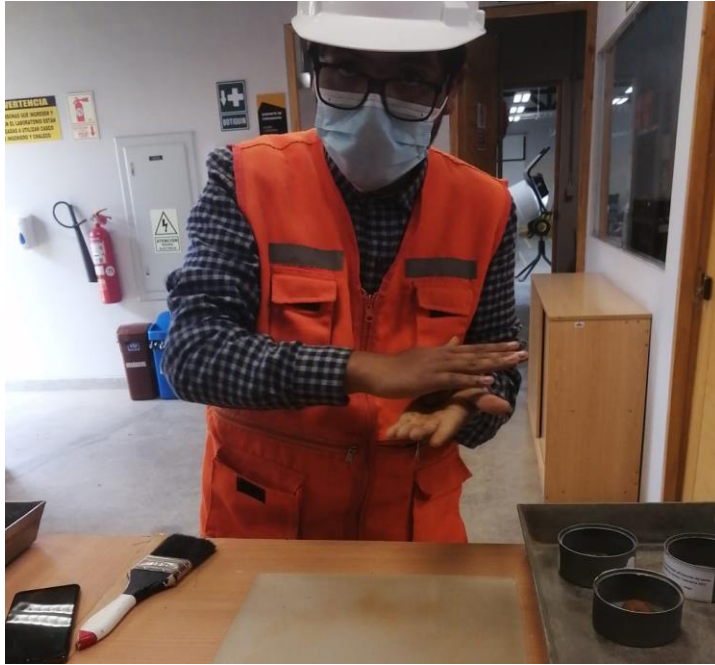
Fotografía 15. Preparación de suelo para el ensayo de limite plástico.
