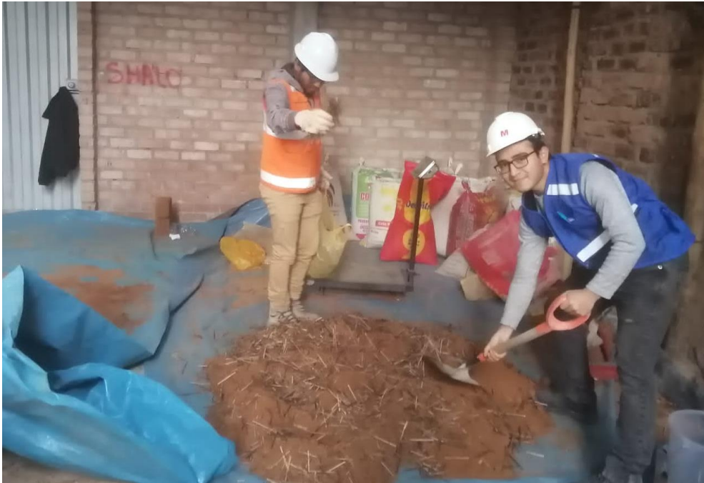
Fotografía 25. Preparación de suelo con adición de fibras deseudotallo de banano y agua de acuerdo con el contenido de humedad óptimo.
