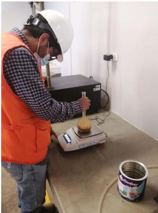
Fotografía 10. Toma de lectura de peso de fiola, material y agua, para ensayo de peso específico.
