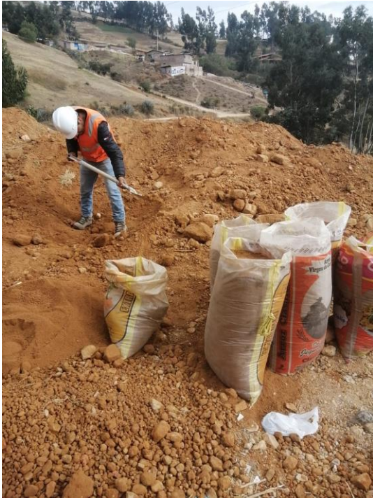
Fotografía 5. Recolección de suelo tamizado en sacos plastificados para traslado al laboratorio de la Universidad Privada del Norte.
