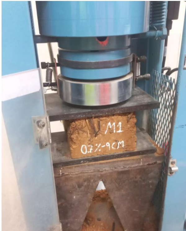
Fotografía 37. Ensayo de resistencia a compresión en la máquina hidráulica universal de tensión y compresión
