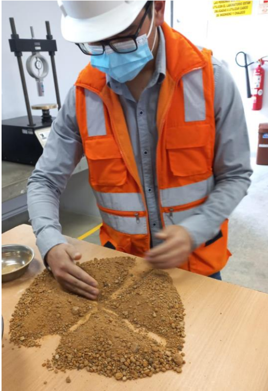
Fotografía 17. Técnica de cuarteo para dividir el material y elegir una muestra representativa y uniforme para ensayo de granulometría por lavado.
