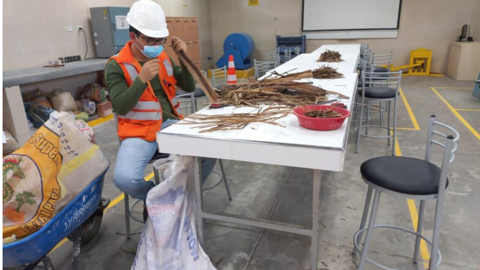
Fotografía 1. Cortado y medida de la fibra de seudotallo del banano en medidas de 5 cm, 7 cm y 9 cm.
