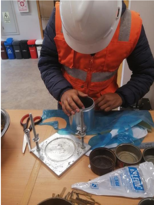
Fotografía 21. Colocación de molde para separar el metal del suelo y se pueda retirar del molde.
