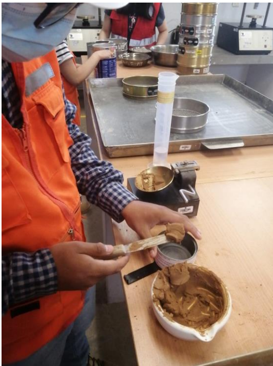
Fotografía 14. Obtención de muestra para colocarle en el horno en el ensayo de limite líquido.
