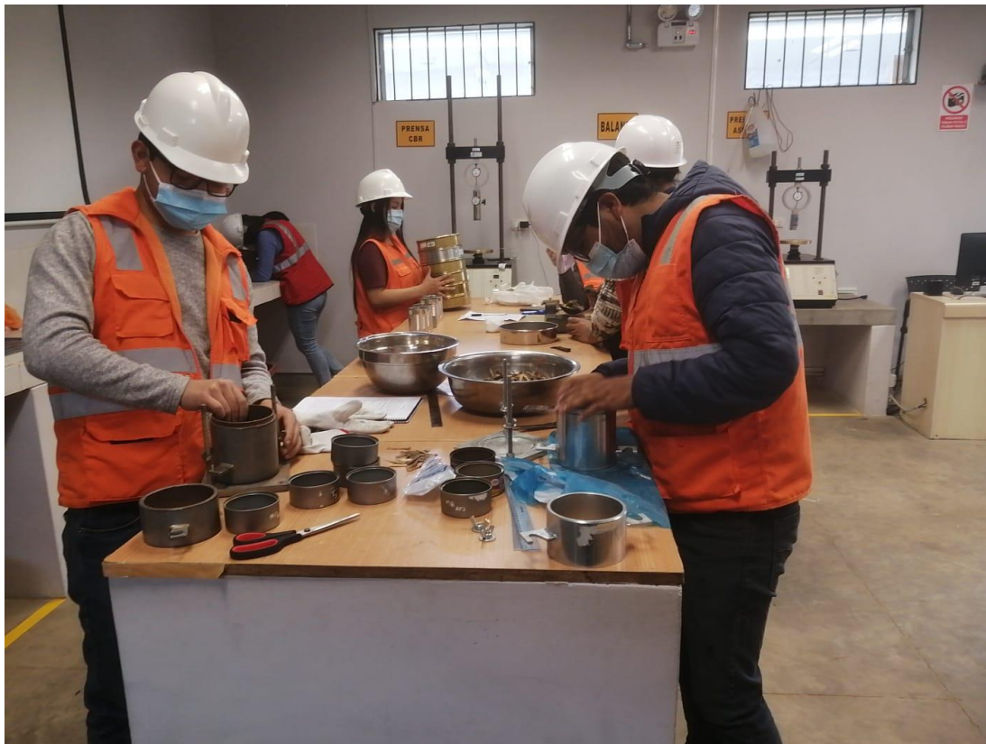
Fotografía 20. Inspección y preparación de equipos para realizar el ensayo de Proctor Modificado.
