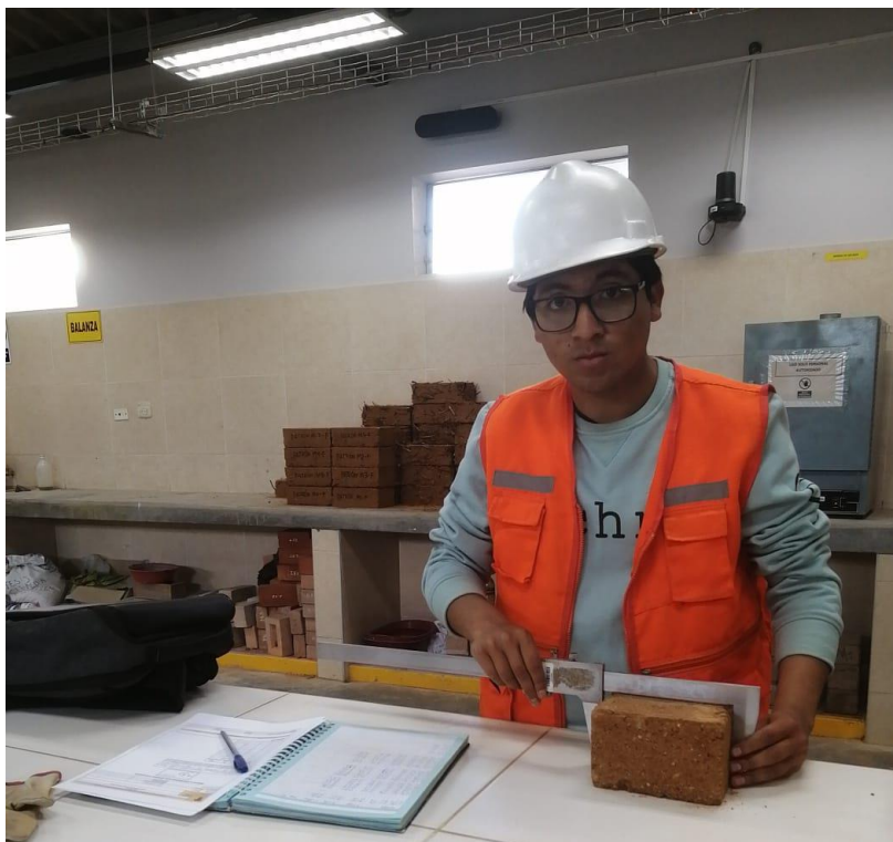
Fotografía 36. Medida de muestras de adobes con Vernier para una mayor precisión.
