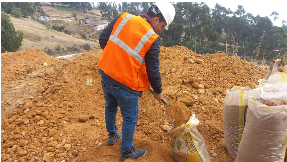
Fotografía 4. Recolección de suelo tamizado en sacos plastificados para que no pierda contenido de humedad natural.
