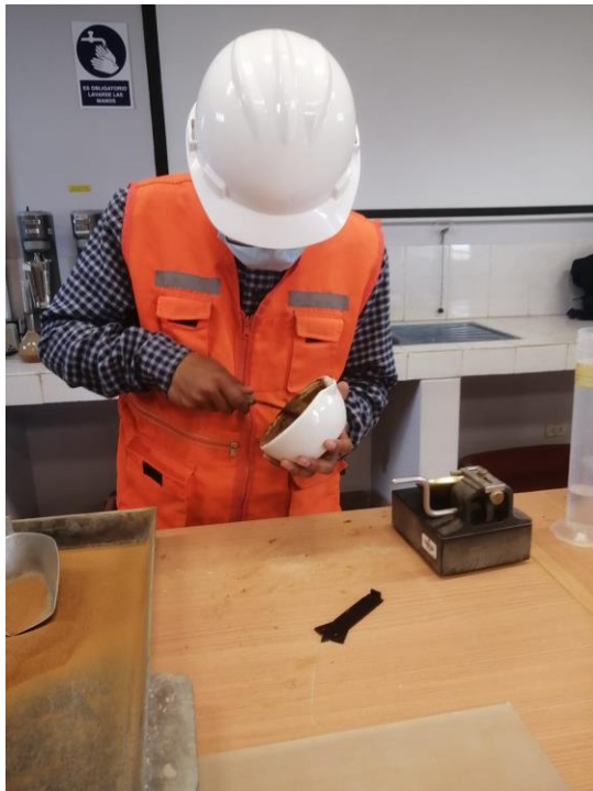
Fotografía 12. Combinación de suelo más agua, homogenizando para colocarle en la copa de Casagrande.
