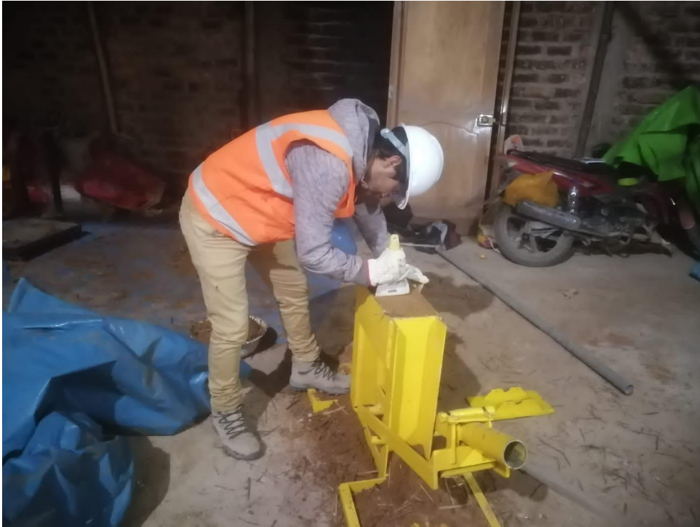
Fotografía 29. Separación de adobes para ensayo a compresión.
