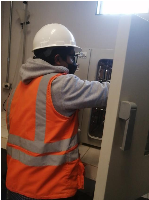
Fotografía 24. Colocación de muestras en el horno a 105°C por 24 horas.
