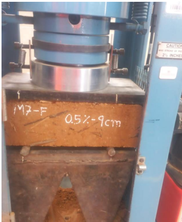
Fotografía 38. Ensayo de resistencia a flexión en la máquina hidráulica universal de tensión y compresión
