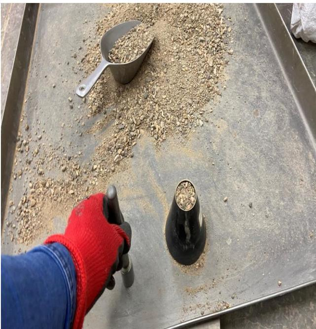
**Fotografía 19.** *Ensayo gravedad específica y absorción del agregado fino (verificación del estado SSS de la muestra en un molde cónico y varilla metal).*
