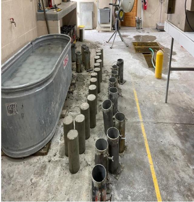
**Fotografía 9.** *Luego de haber pasado 24 horas se realizan trabajos de desmoldaje para pasar al curado inicial de cada probeta.*
