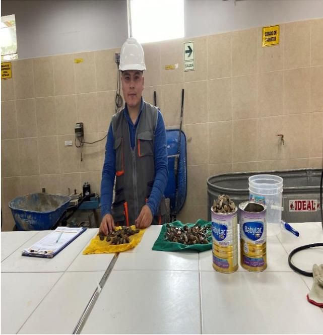
**Fotografía 21.** *Ensayo gravedad específica y absorción del agregado grueso (muestra expandida sobre el paño para poder eliminar las partículas de agua).*
