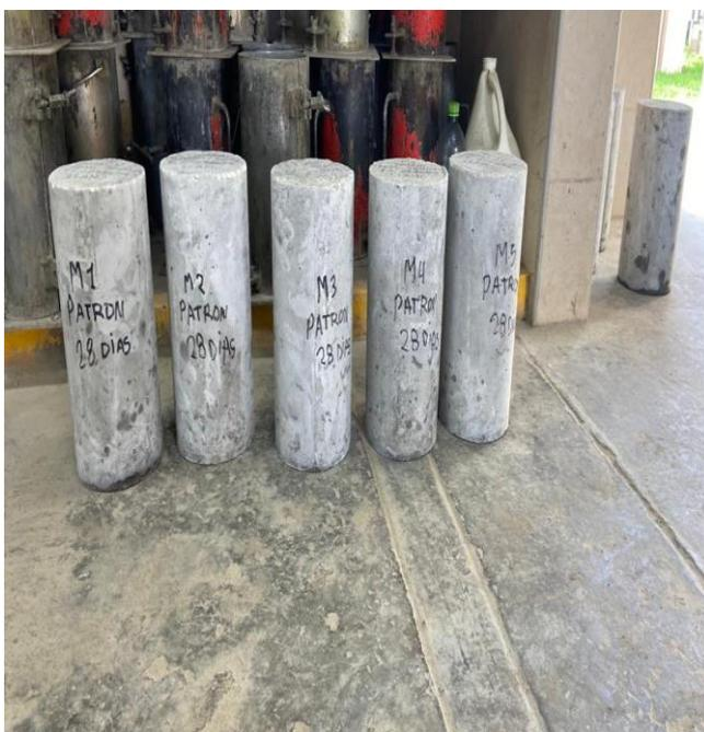
**Fotografía 23.** Muestras de concreto patrón para realizar el ensayo de resistencia a la compresión después de 28 días de curado.
