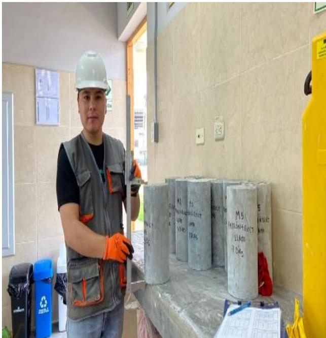
**Fotografía 3.** *Ensayo de resistencia a la compresión, trabajos con vernier tomando medidas de altura de los testigos cilíndricos antes de realizar los ensayos.*
