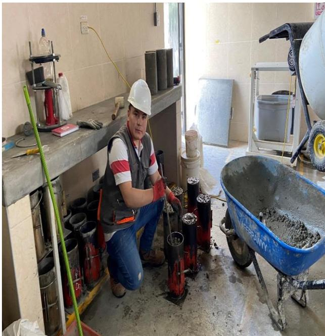
**Fotografía 7.** *Vaciado de concreto a cada molde según normativa para una tanda de muestra patrón y otra con muestra patrón más incorporación de goma de tuna en 3%, 6% y 9%.*
