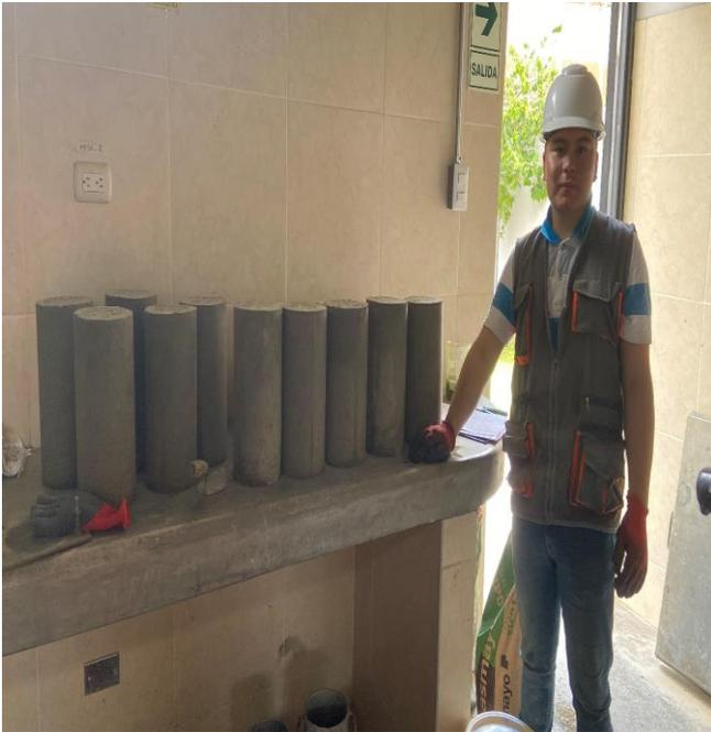
**Fotografía 3.** Elaboración de probetas con muestra patrón y la incorporación de 3%, 6% y 9% de goma de tuna, en laboratorio de Concreto de UPN-Cajamarca.
