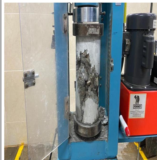
**Fotografía 27.** Estado de muestra con concreto patrón más 3% de goma de tuna a la edad de 28 días de curado, ubicado en prensa hidráulica digital.
