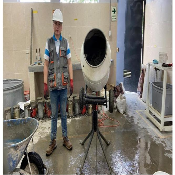
**Fotografía 6.** *Maquina mezcladora utilizada para la elaboración de las probetas por cada tanda.*
