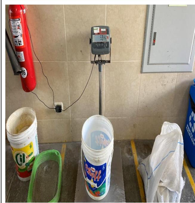
**Fotografía 17.** Cantidad de agua para elaborar probetas de concreto con muestra patrón más 3%, 6% y 9% de goma de tuna.
