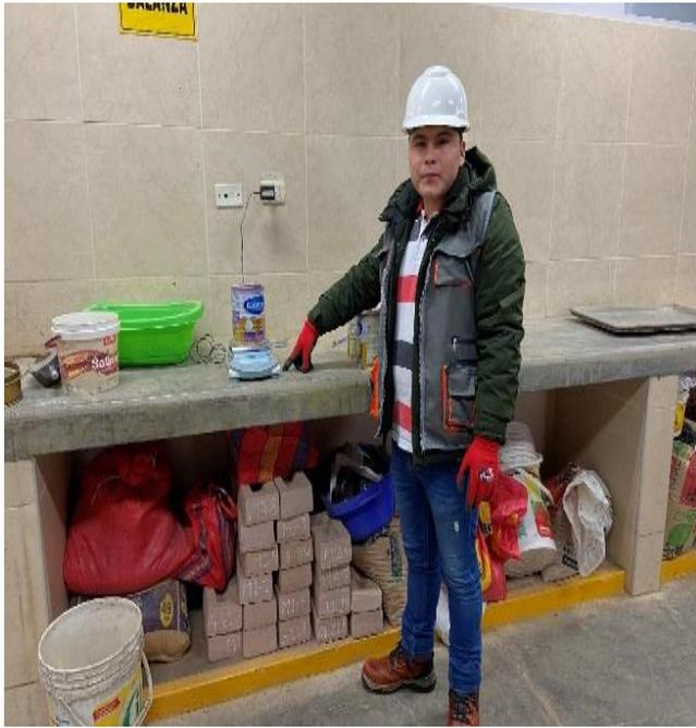
**Fotografía 5.** *Peso de la muestra del agregado fino para el ensayo de contenido de humedad.*
