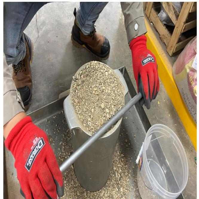
**Fotografía 12.** *Ensayo de peso unitario suelto y compactado del agregado fino (una vez llenado el molde se enrasa con la varilla).*
