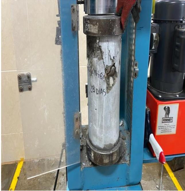
**Fotografía 29.** Estado de muestra con concreto patrón más 6% de goma de tuna a la edad de 28 días de curado, ubicado en prensa hidráulica digital.
