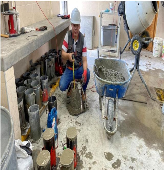
**Fotografía 7.** Ensayo de asentamiento del concreto (SLUMP) de la muestra patrón más 9% de goma de tuna, la consistencia fue plástica, asentamiento se encontró dentro de 3 – 4 pulg.
