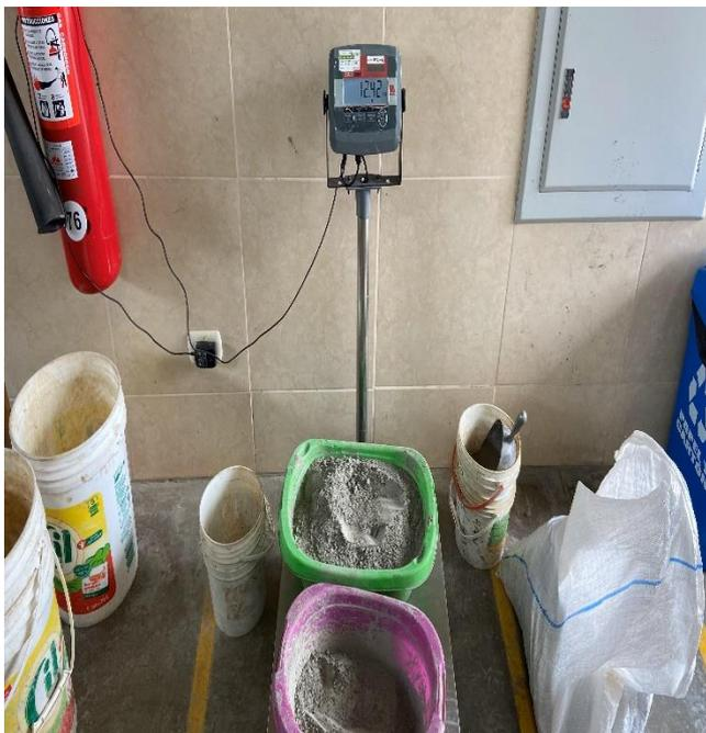
**Fotografía 15.** Peso de cantidad de cemento para elaborar probetas de concreto con muestra patrón más 3% de goma de tuna.
