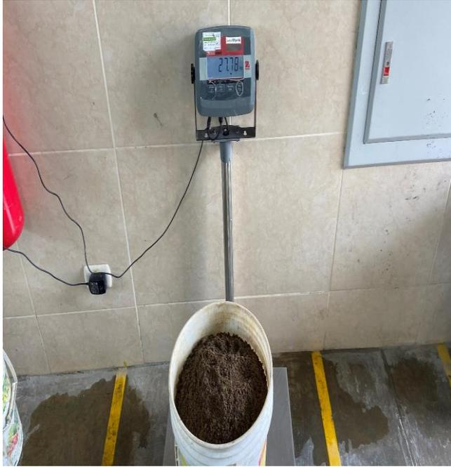
**Fotografía 13.** Cantidad de agregado fino para elaborar probetas de concreto con muestra patrón.
