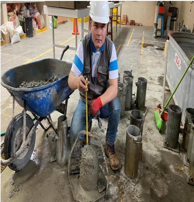
**Fotografía 3.** Ensayo de asentamiento del concreto (SLUMP) de la muestra patrón más 3% de goma de tuna, la consistencia fue plástica, asentamiento se encontró dentro de 3 – 4 pulg.
