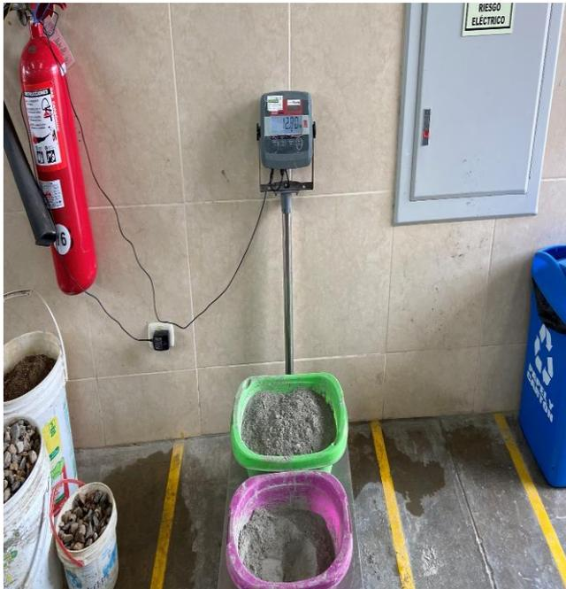
**Fotografía 11.** *Peso de cantidad de cemento para elaborar probetas de concreto con muestra patrón.*
