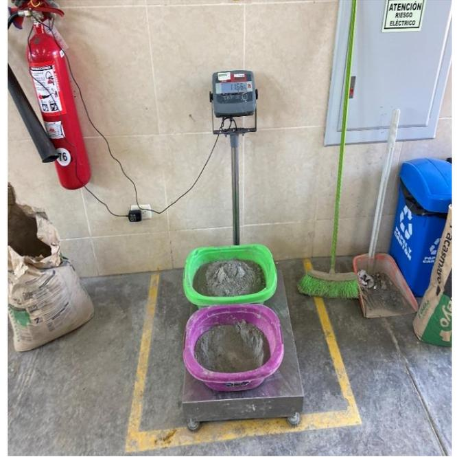
**Fotografía 22.** *Peso de cantidad de cemento para elaborar probetas de concreto con muestra patrón más 9% de goma de tuna.*
