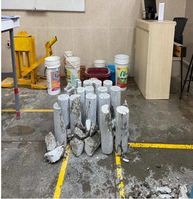
**Fotografía 33.** Resultados finales después de haber sido sometidos las muestras en la prensa hidráulica digital, muestras realizadas con concreto patrón y más 3%, 6% y 9% de goma de tuna.
