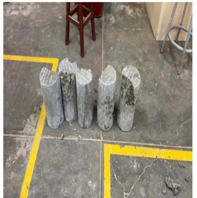
**Fotografía 11.** Carga última (en kg) aplicada a una de las muestras realizadas con concreto patrón más 9% de goma de tuna; después de 7 días de curado, dato obtenido de prensa hidráulica digital.
