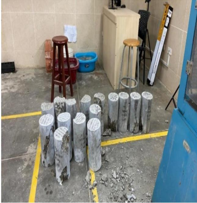
**Fotografía 17.** Resultados finales de las muestras realizadas con concreto patrón y con concreto patrón más 3% de goma de tuna, a edad de 14 días de curado.
