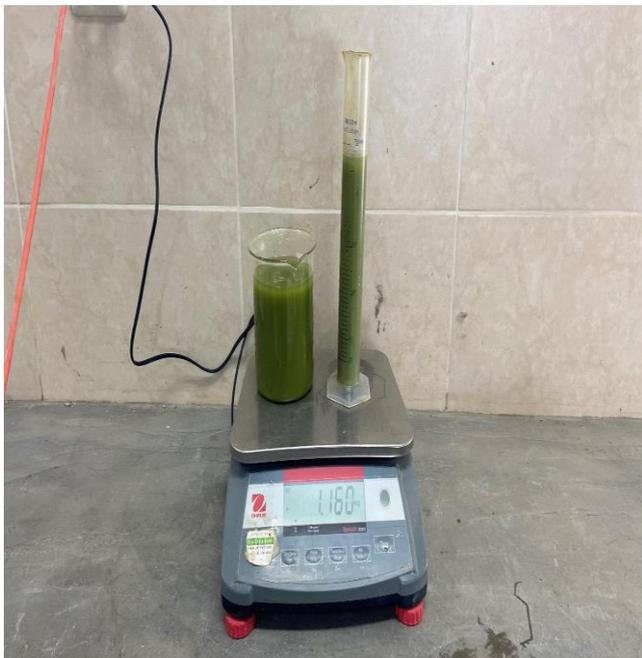
**Fotografía 23.** *Peso de cantidad de goma de tuna para elaborar probetas de concreto con muestra patrón más 9% de goma de tuna.*
