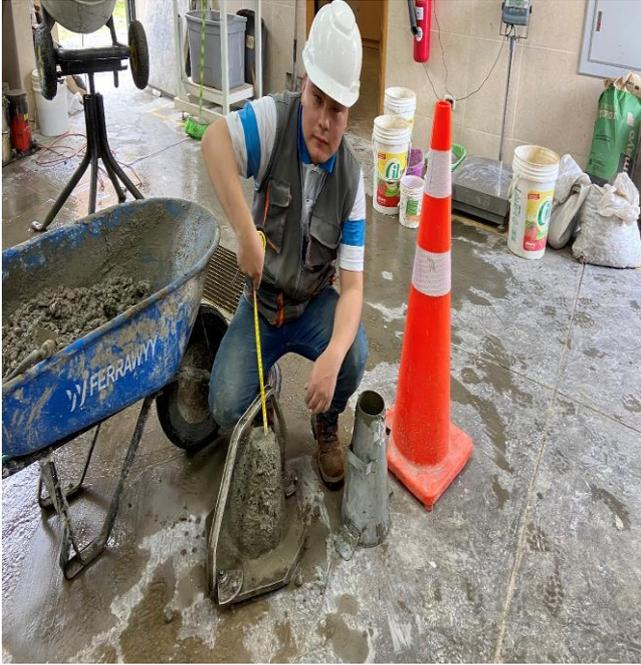
**Fotografía 5.** Ensayo de asentamiento del concreto (SLUMP) de la muestra patrón más 6% de goma de tuna, la consistencia fue plástica, asentamiento se encontró dentro de 3 – 4 pulg.
