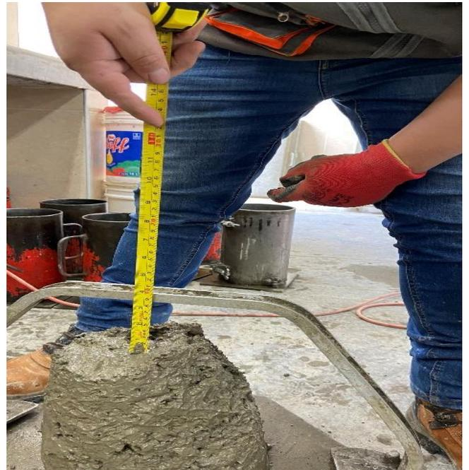
**Fotografía 8.** El resultado del ensayo de asentamiento del concreto (SLUMP) de la muestra patrón más 6% de goma de tuna, fue de 8.60 cm o 3.39 pulg,
