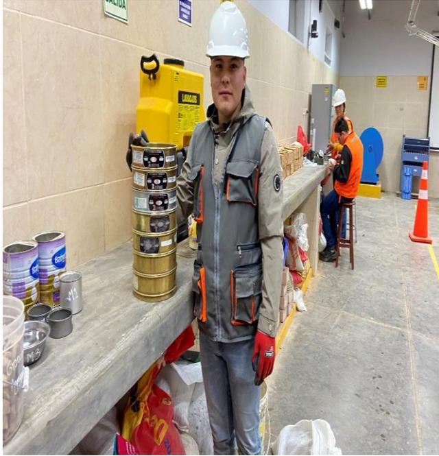
**Fotografía 9.** *Ensayo de análisis granulométrico del agregado grueso.*
