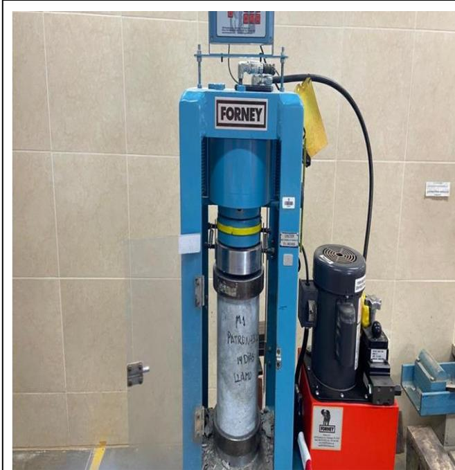
**Fotografía 15.** Muestras de concreto patrón más 3% de goma de tuna a la edad de 14 días de curado, ubicado en prensa hidráulica digital, utilizada para el ensayo de resistencia a la compresión.
