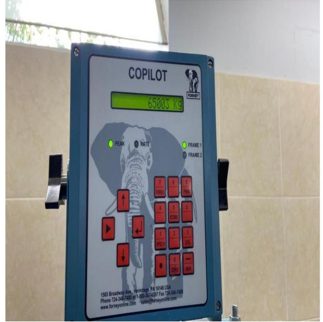
**Fotografía 30.** Carga última (en kg) aplicada a una de las muestras realizadas con concreto patrón más 6% de goma de tuna, dato obtenido de prensa hidráulica digital.
