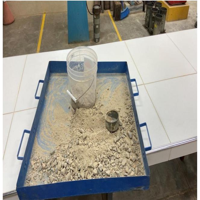
**Fotografía 24.** *Ensayo abrasión los ángeles al desgaste del agregado grueso (Se lava el material retenido en el tamiz N° 12 hasta retirar los finos).*
