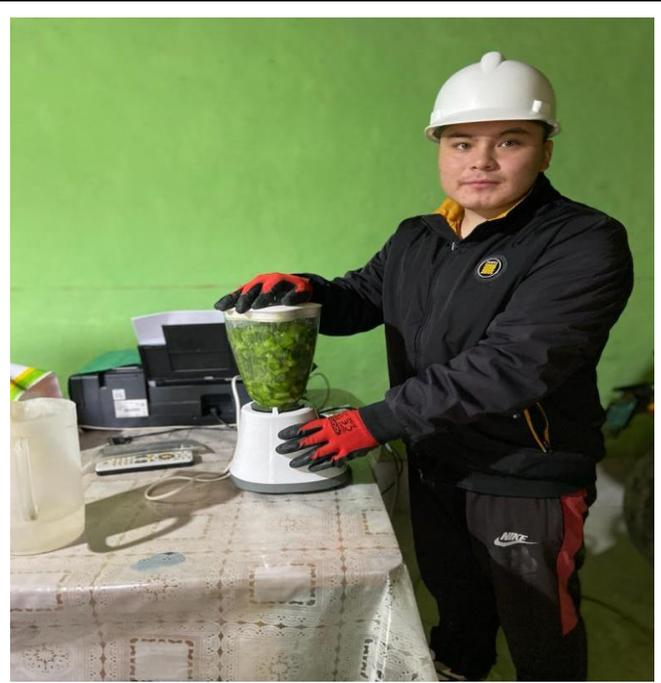
**Fotografía 6.** Paso 4, luego se realizó trabajos de licuado de la tuna mezclando con agua destinada para facilitar la molienda.
