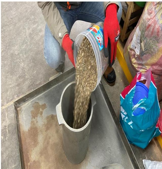
**Fotografía 11.** *Ensayo de peso unitario suelto y compactado (colocación de material a una distancia mínima 5 cm por encima del molde, se realiza en tres capas).*
