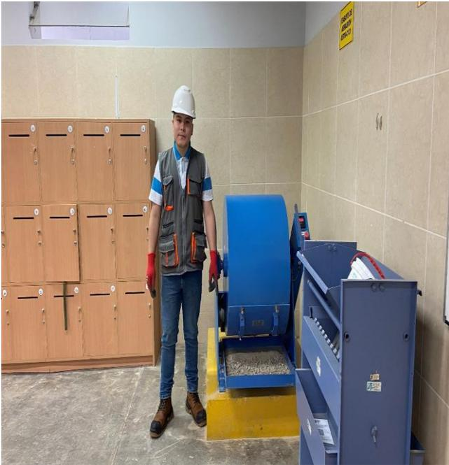
**Fotografía 23.** *Ensayo abrasión los ángeles al desgaste del agregado grueso (material después de haber realizado el ensayo con la máquina de los ángeles).*
