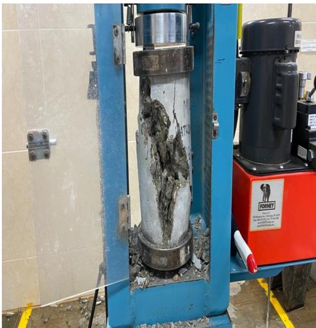
**Fotografía 31.** Estado de muestra con concreto patrón más 9% de goma de tuna a la edad de 28 días de curado, ubicado en prensa hidráulica digital.
