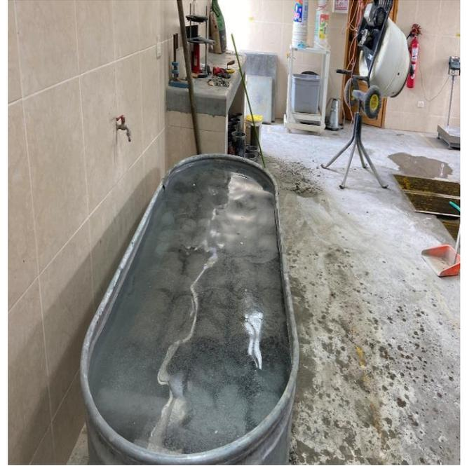
**Fotografía 10.** *Probetas en poza de curado el cual cumple con los requisitos de normativa para el curado de probetas.*
