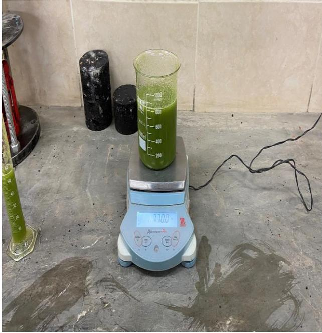
**Fotografía 21.** *Peso de cantidad de goma de tuna para elaborar probetas de concreto con muestra patrón más 6% de goma de tuna.*
