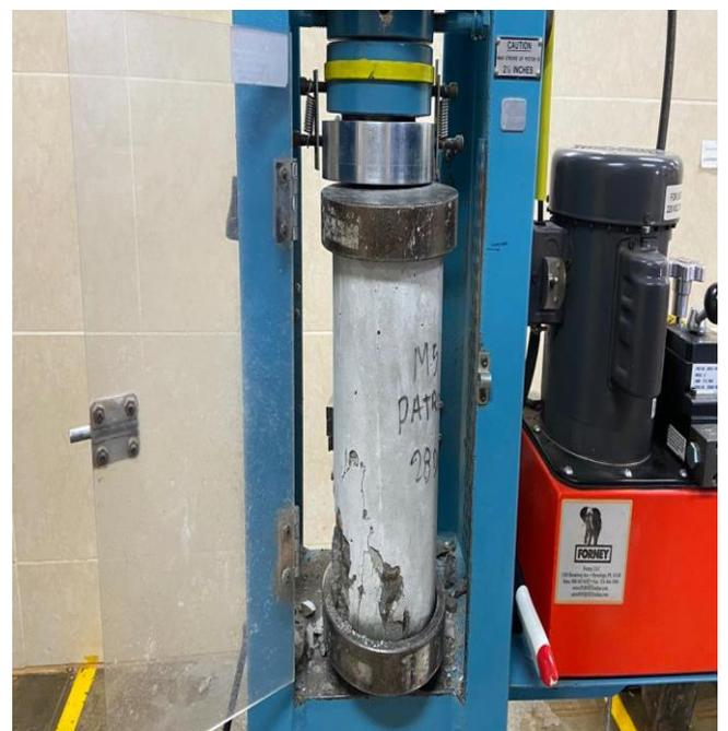
**Fotografía 24.** Estado de muestra con concreto patrón a la edad de 28 días de curado, ubicado en prensa hidráulica digital.
