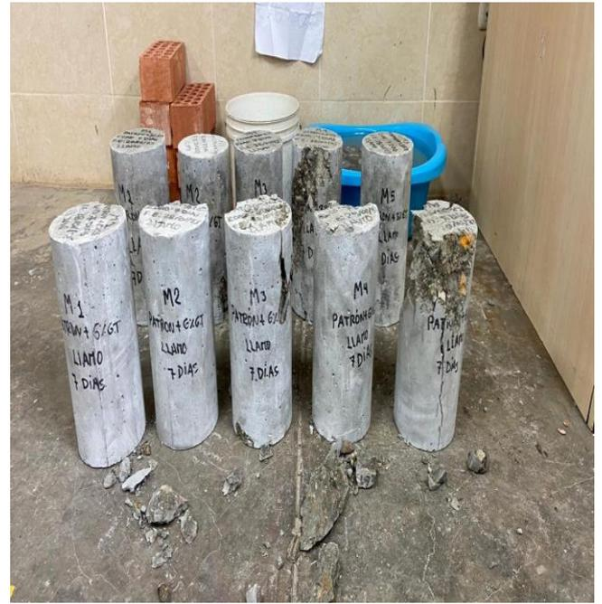
**Fotografía 9.** Carga última (en kg) aplicada a una de las muestras realizadas con concreto patrón más 6% de goma de tuna; después de 7 días de curado, dato obtenido de prensa hidráulica digital.
