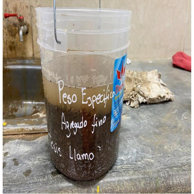
**Fotografía 18.** *Ensayo gravedad específica y absorción del agregado fino (muestra sumergida en un envase con agua para que se sature por 24 horas).*
