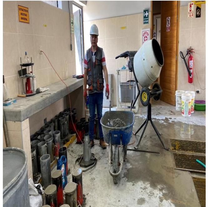
**Fotografía 4.** Antes de realizar el vaciado de concreto en las probetas se verificó el ensayo de asentamiento del concreto (SLUMP) de cada tanda elaborada.
