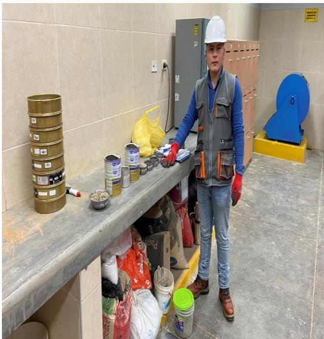
**Fotografía 7.** *Ensayo de análisis granulométrico del agregado fino.*
