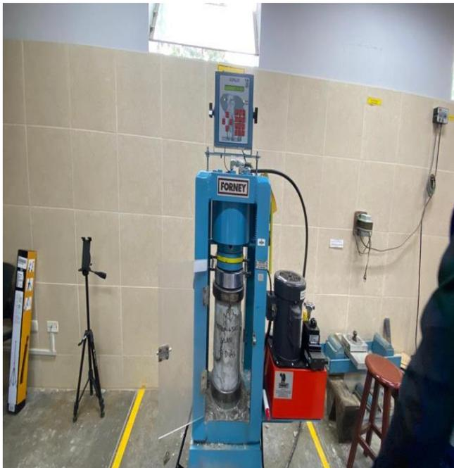
**Fotografía 7.** Muestras de concreto patrón más 3% de goma de tuna; después de 7 días de curado, ubicado en prensa hidráulica digital, máquina para ensayo de resistencia a la compresión.
