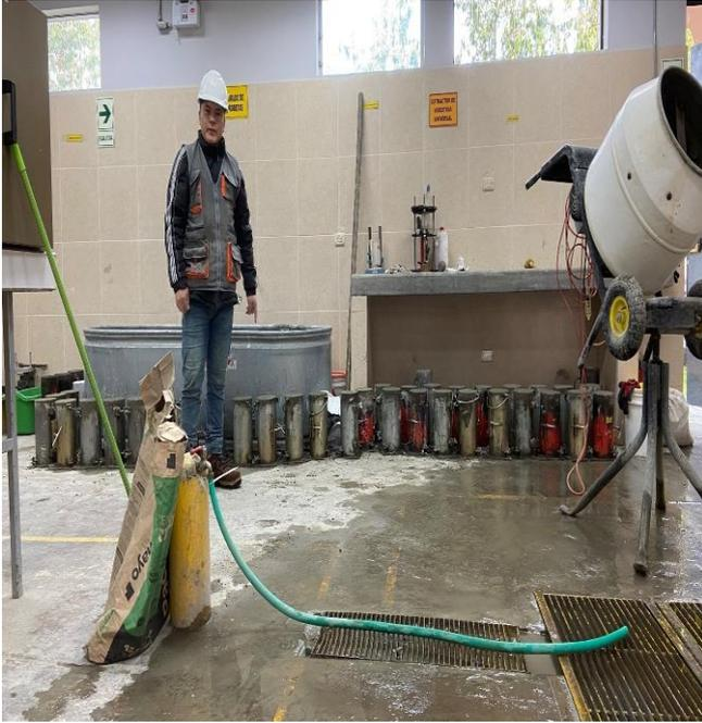
**Fotografía 1.** Elaboración de probetas, con muestra patrón y con incorporación de 3%, 6% y 9% de goma de tuna, en laboratorio de Concreto de UPN-Cajamarca.
