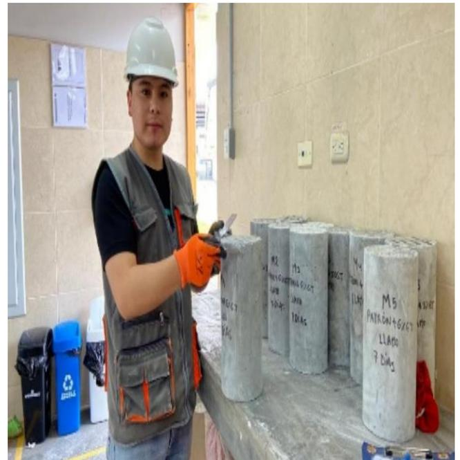
**Fotografía 4.** *Ensayo de resistencia a la compresión, trabajos con vernier tomando medidas de diámetro de los testigos cilíndricos antes de realizar los ensayos.*
