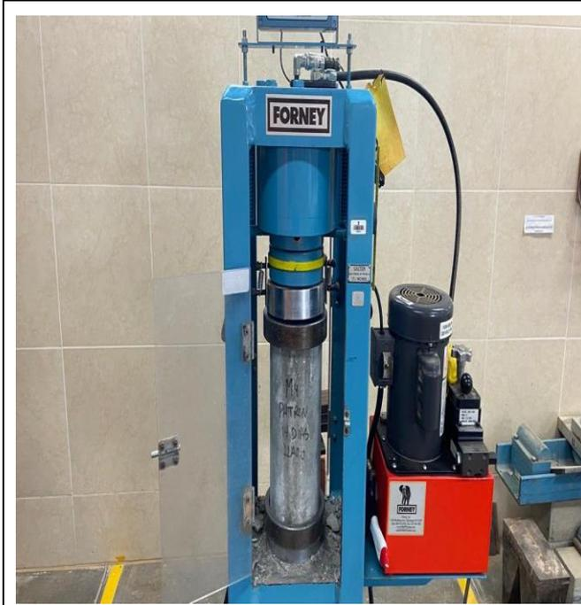
**Fotografía 13.** Muestras de concreto patrón; después de 14 días de curado, ubicado en prensa hidráulica digital, utilizada para el ensayo de resistencia a la compresión.
