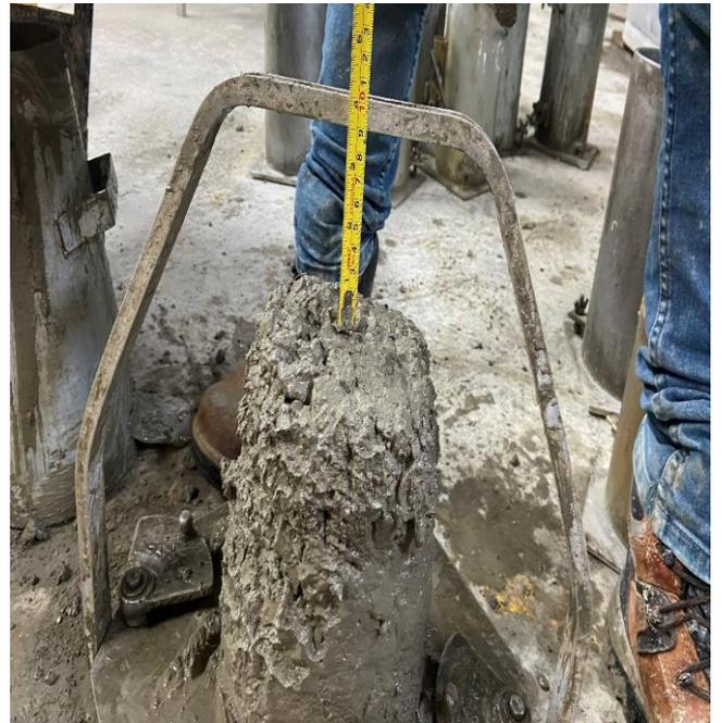
**Fotografía 4.** El resultado del ensayo de asentamiento del concreto (SLUMP) de la muestra patrón más 3% de goma de tuna, fue de 8.80 cm o 3.46 pulg,
