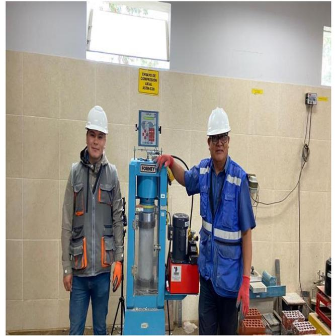
**Fotografía 2.** *Ensayo de resistencia a la compresión de testigos cilíndricos, con la supervisión de coordinador de laboratorio de concreto de UNP – Cajamarca.*
