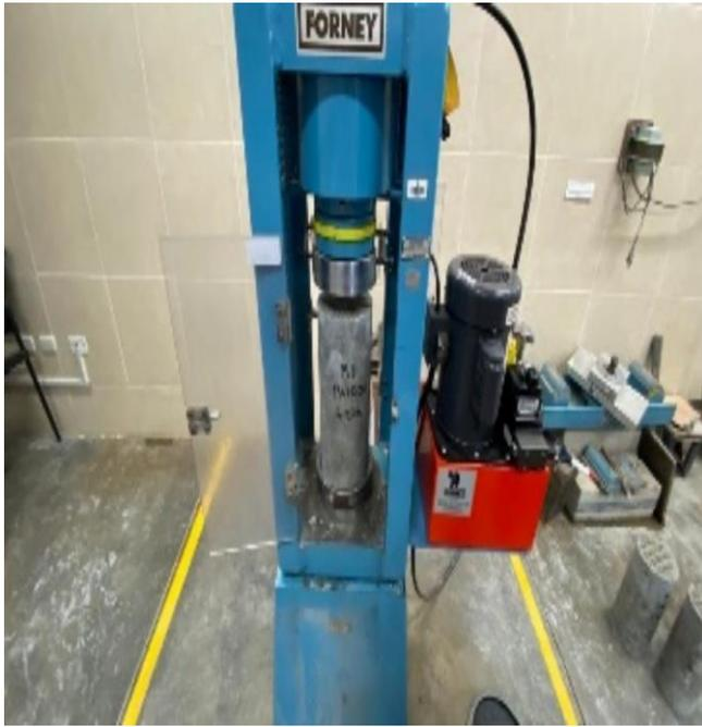
**Fotografía 5.** Muestras de concreto patrón; después de 7 días de curado, ubicado en prensa hidráulica digital, utilizada para el ensayo de resistencia a la compresión.
