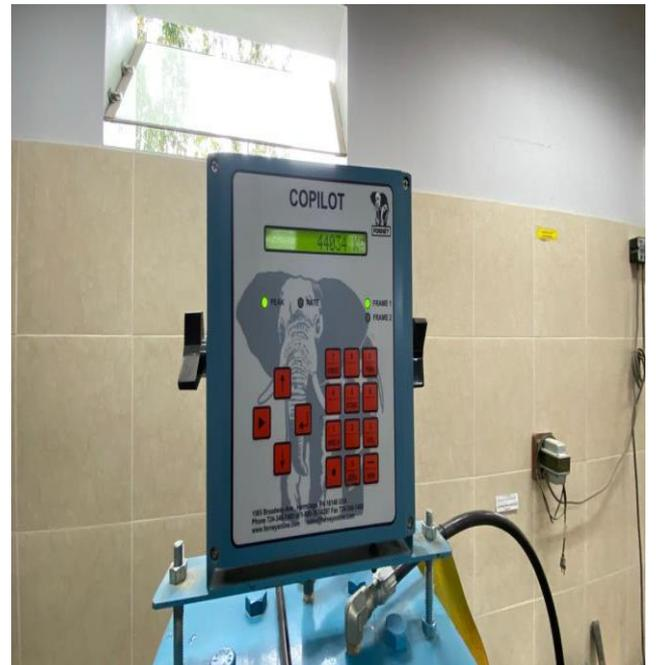
**Fotografía 8.** Carga última (en kg) aplicada a una de las muestras realizadas con concreto patrón más 3% de goma de tuna, dato obtenido de prensa hidráulica digital.
