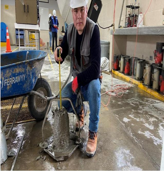
**Fotografía 1.** Ensayo de asentamiento del concreto (SLUMP) de la muestra patrón sin adición de goma de tuna, la consistencia fue plástica, asentamiento se encontró dentro de 3 – 4 pulg.
