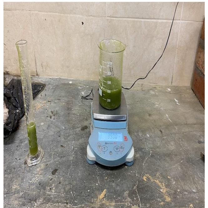
**Fotografía 16.** Peso de cantidad de goma de tuna para elaborar probetas de concreto con muestra patrón más 3% de goma de tuna.
