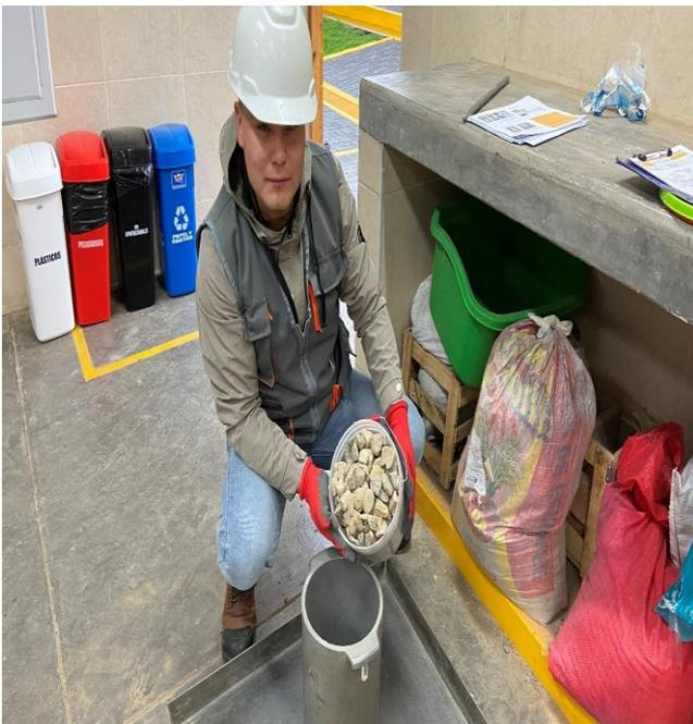
**Fotografía 15.** *Ensayo de peso unitario suelto y compactado del agregado grueso (colocación del material a una distancia mínima 5 cm por encima del molde, se realiza en tres capas).*
