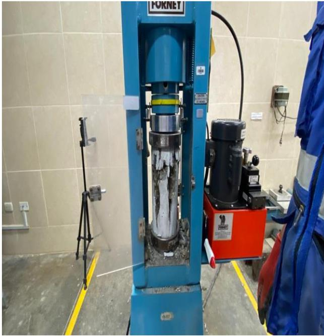
**Fotografía 21.** Estado de muestra con concreto patrón más 9% de goma de tuna a la edad de 14 días de curado, ubicado en prensa hidráulica digital.
