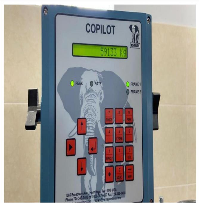
**Fotografía 26.** Carga última (en kg) aplicada a una de las muestras realizadas con concreto patrón, dato obtenido de prensa hidráulica digital.
