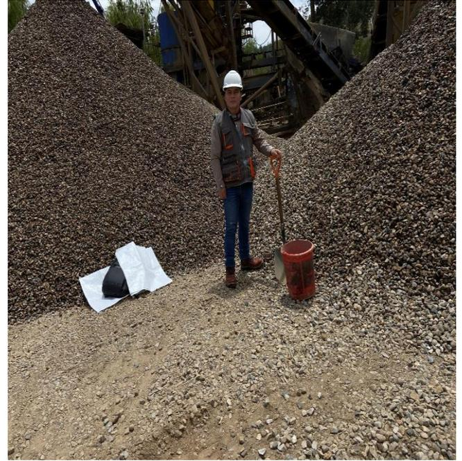
**Fotografía 2.** *Obtención del agregado grueso de cantera necesario para realizar los ensayos.*
