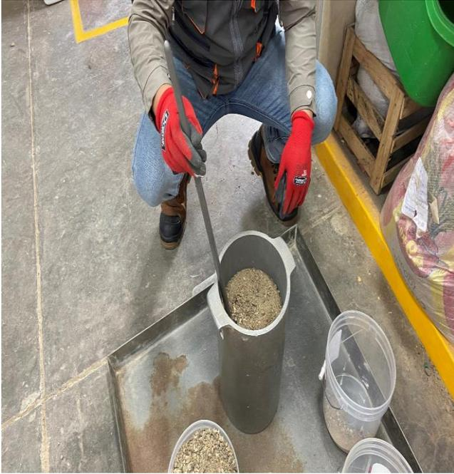
**Fotografía 13.** *Ensayo de peso unitario compactado del agregado fino (cada capa se compacta con la varilla con 25 golpes).*
