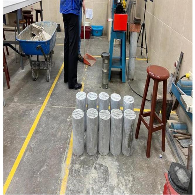
**Fotografía 18.** Muestras de concreto patrón más 6% y 9% de goma de tuna para realizar el ensayo de resistencia a la compresión después de 14 días de curado.
