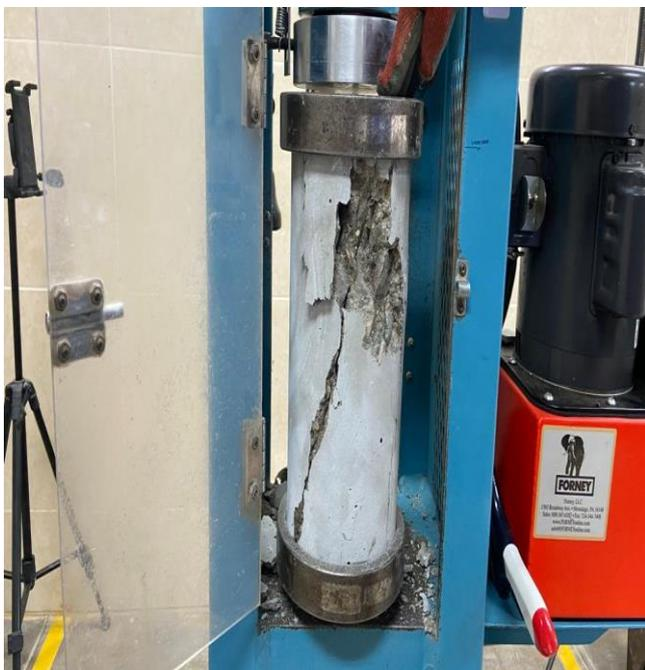
**Fotografía 19.** Estado de muestra con concreto patrón más 6% de goma de tuna a la edad de 14 días de curado, ubicado en prensa hidráulica digital.
