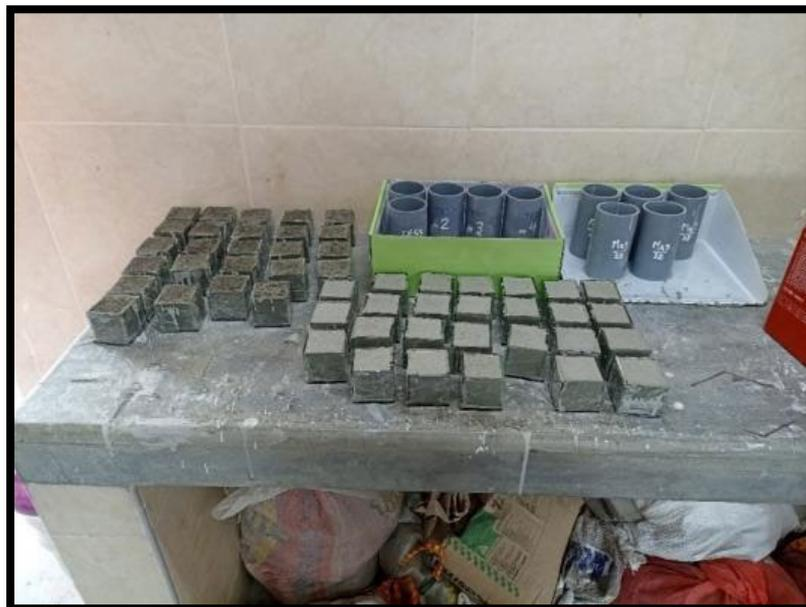
*Figura 38. Elaboración de la mezcla 2 y 3 adicionando bentonita al 20% y 30% respectivamente*
