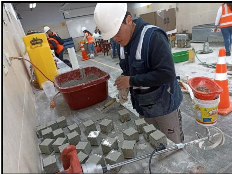
*Figura 40. Llenado de muestras cúbicas y cilíndricas de la mezcla 2 y 3*
