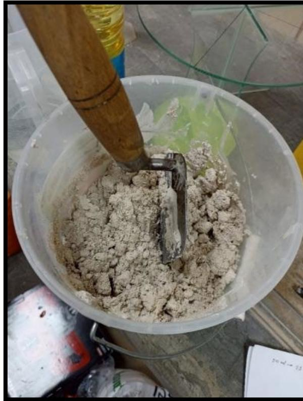
*Figura 33. Ensayo de fluidez de la bentonita consistencia seca*
