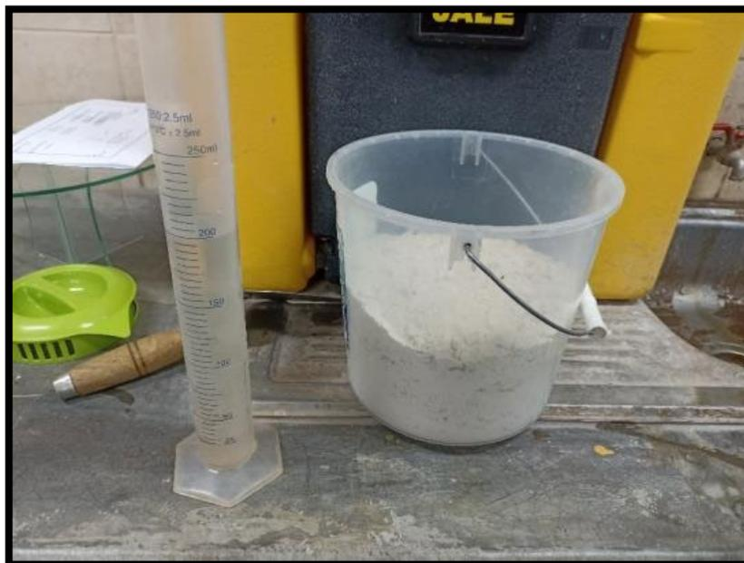
*Figura 32. Resultados de la dosificación de la bentonita con presencia de grumos*
