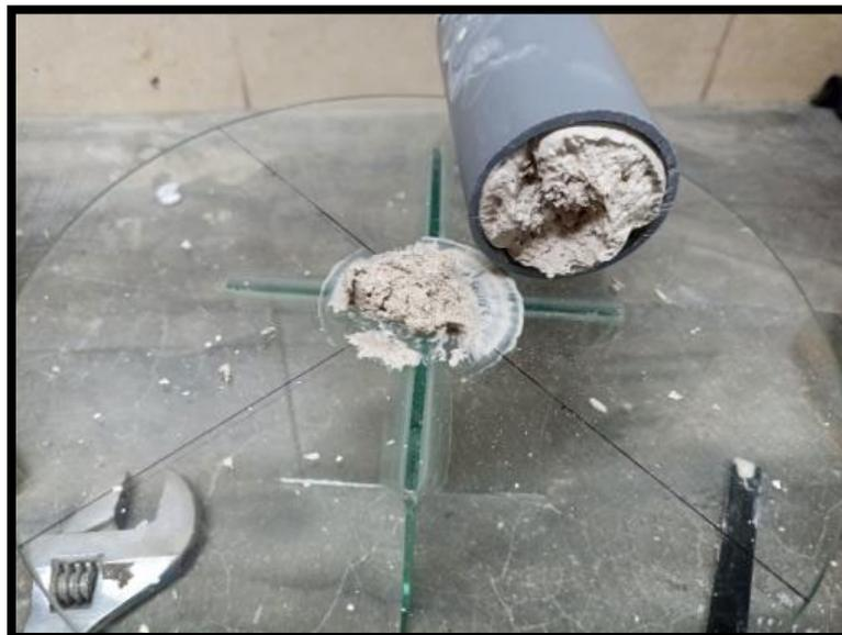
*Figura 34. Medición del SLUMP de los ensayos de bentonita*
