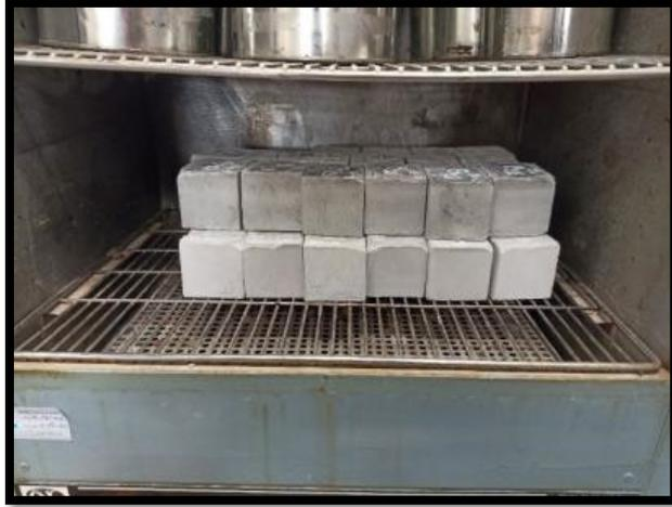
*Figura 44. Pesaje de las muestras secas por 24 horas en horno*
