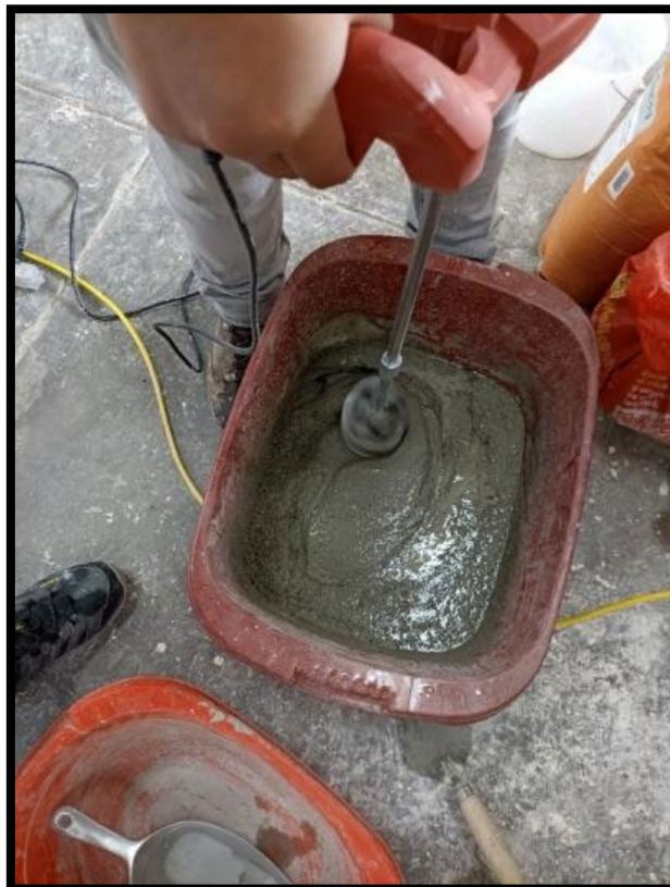
*Figura 36. Elaboración de la mezcla 1 adicionando 10% de bentonita*
