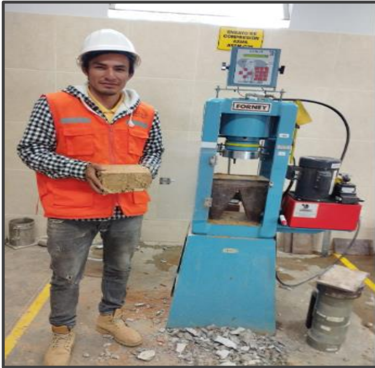
Figura 29: Realizando ensayos adobe a compresión.
