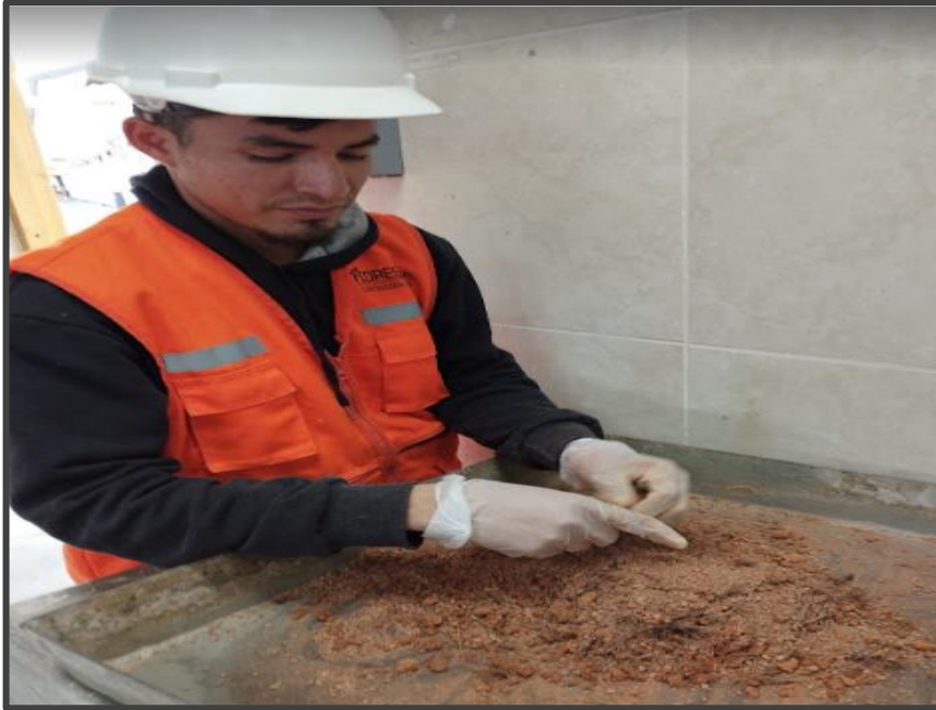
Figura 23: Preparando el diseño de mezcla para el ensayo de proctor modificado
