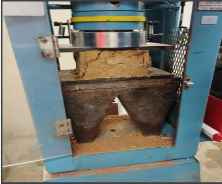
Figura 27: Realizando ensayo de compresión a los 28 días
