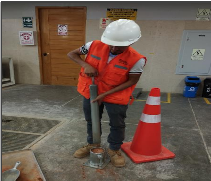
Figura 24: Compactacion a los 25 golpes ensayo proctor modificado
