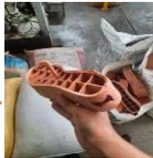
Muestra de la producción de un taco dañado, la máquina tuvo un desperfecto y ya no se pudo producir. Ese taco se vuelve a moler y se produce nuevamente, se puede mezclar con material nuevo o simplemente con el material molido de los tacos dañados.
