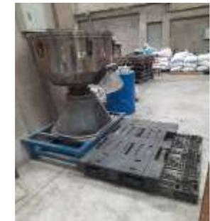
Mezcladora, para cuando se mezcle material suave para huellas, este debe estar limpio, luego se recibe en material en sacos y se coloca en un lugar para luego ser paletizado.
